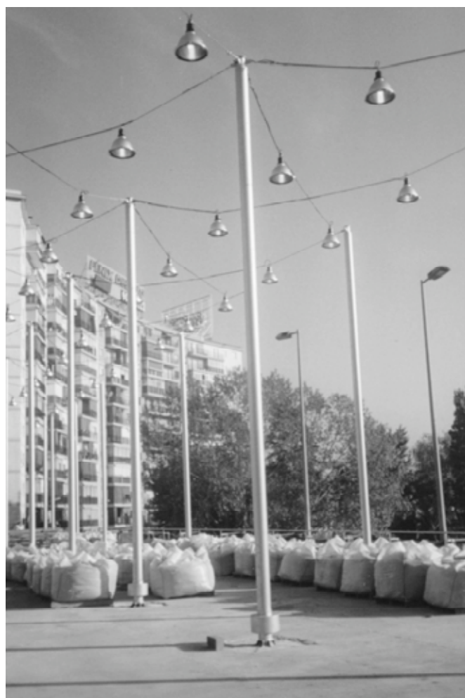
Foto 21. Prueba de carga in situ.
