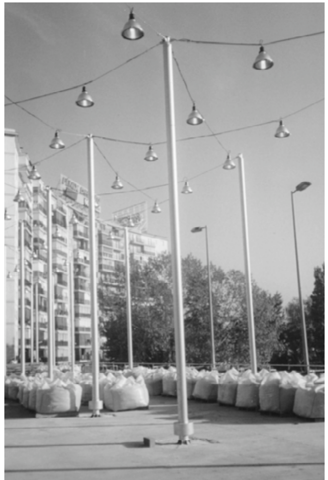
Foto 21. Prueba de carga in situ.
