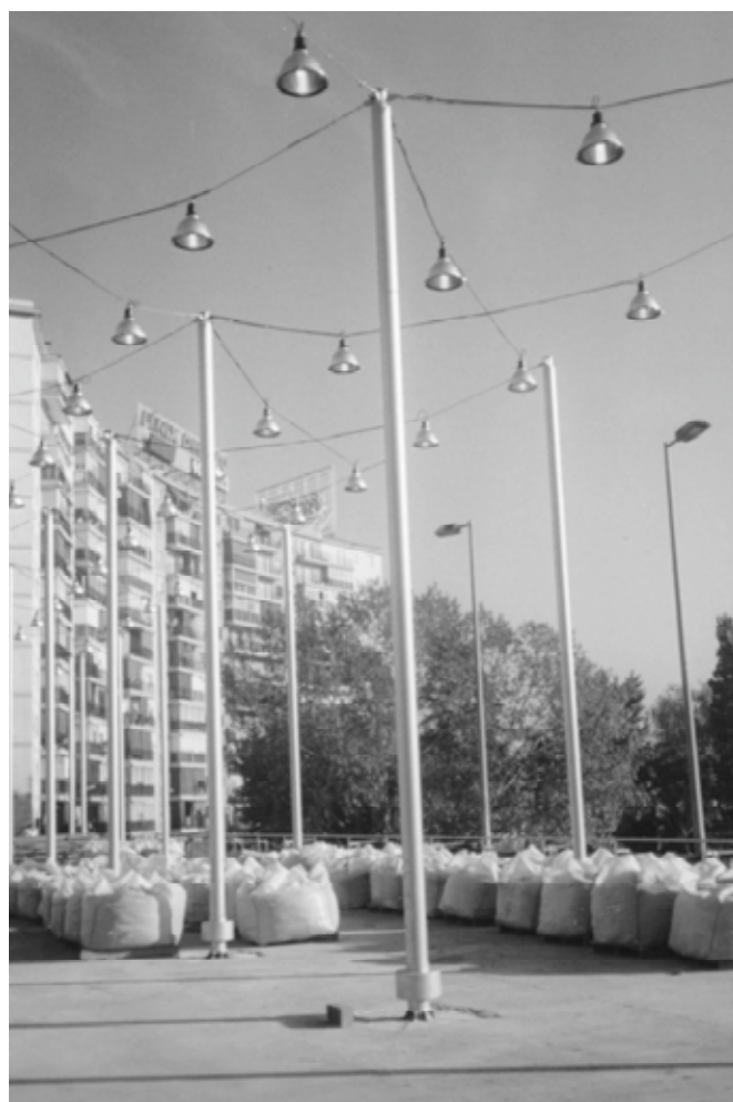
Foto 21. Prueba de carga in situ.
