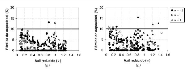
Figura 14. Comparación de la esbeltez límite inferior con los resultados de la simulación numérica en flexión recta (a) Hormigón convencional - (b) Hormigón de alta resistencia.
