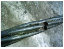
Figura 19. Alambres seccionados. *Figure 19. Split wire strands.*
