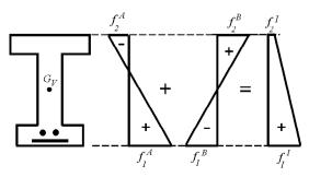
Figura 2: Diagramas de tensiones para los Estados A+B.
