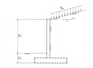
Figura 2. Representación de los parámetros geométricos y de sobrecarga del trasdós.
