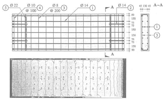
Figura 3: Ensayo a tracción [1].
