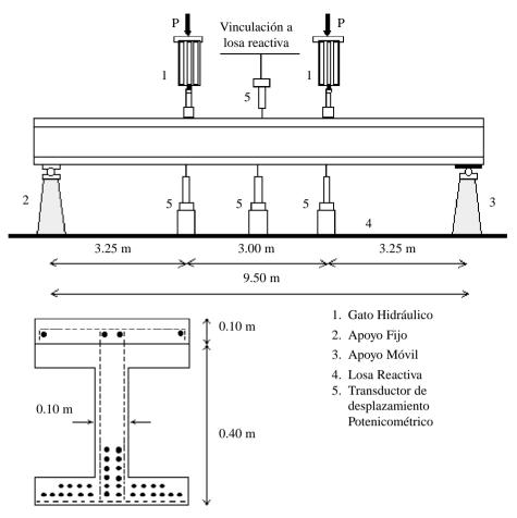
Figura 6. Modelo experimental. Dimensiones generales.
