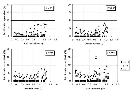
Figura 15. Comparación de la esbeltez límite inferior con los resultados de la simulación numérica en flexión esviada.
