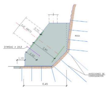
Figura 9. Inyecciones de consolidación. *Figure 9. Consolidation injections.*
