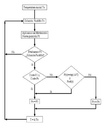
Figura 5. Diagrama de flujo de la cristalización simulada.
