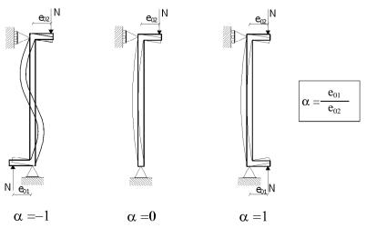
Figura 2. Condiciones de apoyo y relación de excentricidades aplicadas en extremos del soporte analizado.
