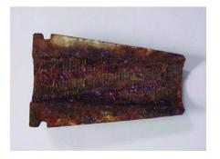
Figura 18. Cuña oxidada. Figure 18. Rusted wedge.
