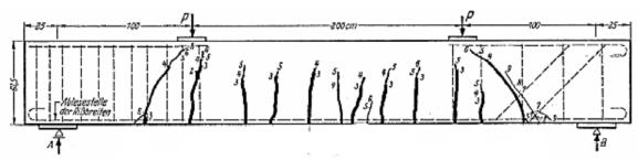
Figura 1: Ensayo a flexión sin armadura de cortante [11].
