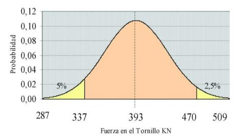
Figura 29. Función de distribución de la fuerza de pretensado para tornillos lubricados y M = 1,50 KN m.
