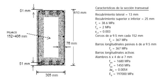
Figura 14. Ejemplo. Sección transversal A, según figura 13.
