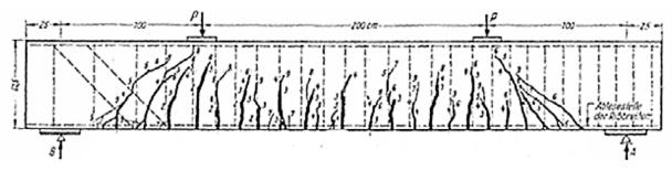
Figura 2: Ensayo a flexión con armadura de cortante [11].
