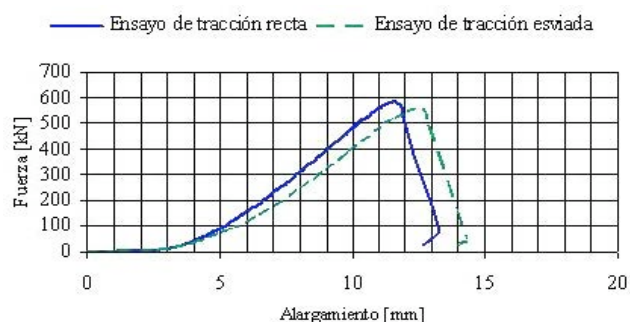
Figura 31. Curvas fuerza de pretensado-alargamiento. Figure 31. Prestress-lengthening force curves.
