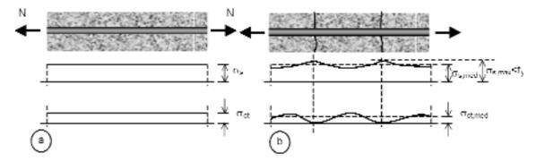
Figura 11. Barra sometida a tracción antes de que el acero entre en fluencia
