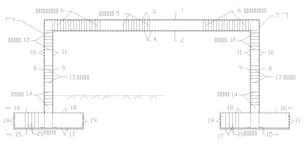
Figura 2. Esquema general de variables de un pórtico.
