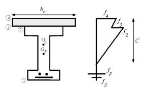
Figura 4: Esquema de distribución de las tensiones finales.
