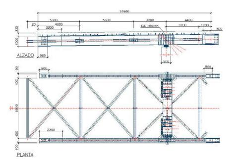
Figura 6. Planta del tablero metálico. Figure 6. Steel deck.
