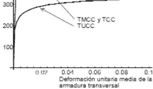
Figura 15. Gráfica tensión deformación de la armadura transversal con el área eficaz extendida a toda la anchura del alma.
