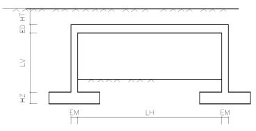
Figura 1. Esquema pórtico tipo paso de carretera.
