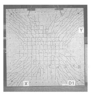
Figura 4: Vista inferior de la losa ensayada [3].
