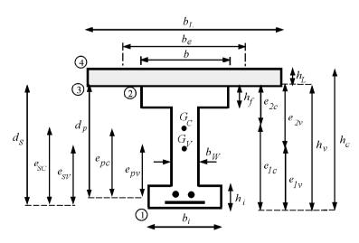
Figura 1. Esquema de la sección transversal de la viga compuesta.
