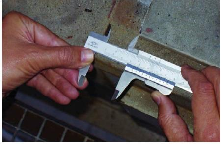
Figura 23. Deslizamiento de unión 2-3. Figure 23. Sliding of union 2-3-
