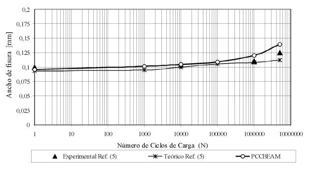
Figura 12. Comparación del Modelo Teórico PCCBEAM con resultados teórico-experimentales. Viga PP1D3 de Referencia (5).
