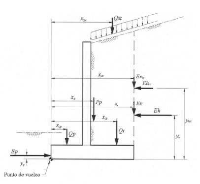
Figura 5. Fuerzas actuantes sobre el muro.
