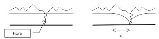
Figura 6: Formación de la primera fisura.
