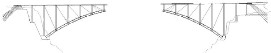
Figura 3. Proceso de construcción de avance por voladizos con diagonales temporales. Figure 3. Construction process in cantilever with temporary diagonals.
