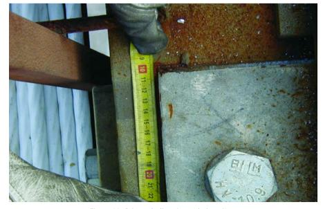
Figura 22. Primer deslizamiento de la unión. Figure 22. Union first sliding.
