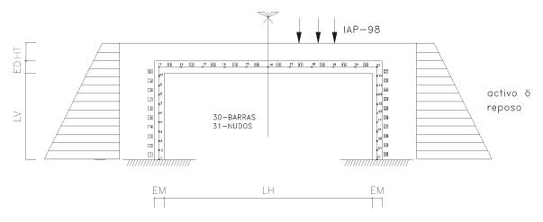
Figura 3. Modelización estructural de pórticos.
