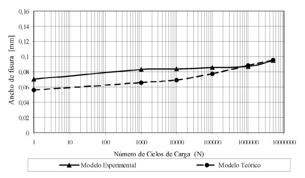
Figura 7. Comportamiento en servicio. Gráfico: Ancho de fisura – Número de ciclos de carga.
