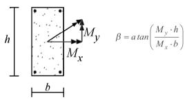
Figura 3. Ángulo de esviaje reducido del esfuerzo flector de primer orden.
