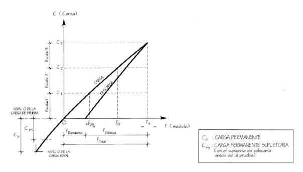
Figura 3.4. Proceso completo de carga / descarga
