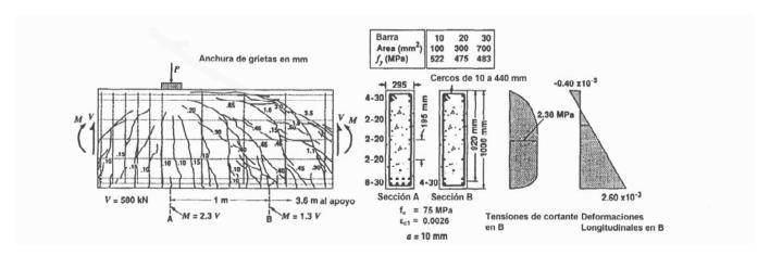
Figura 1. Ejemplo de alma agrietada de una viga con rotura por cortante.
