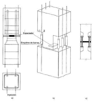
Figura 3.5.4.a Uniones pilar-pilar.
