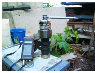
Figura 27. Ensayo con célula de carga. Figure 27. Test with load cell.
