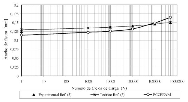
Figura 11. Comparación del Modelo Teórico PCCBEAM con resultados teórico-experimentales. Viga PP1D2 de Referencia (5).
