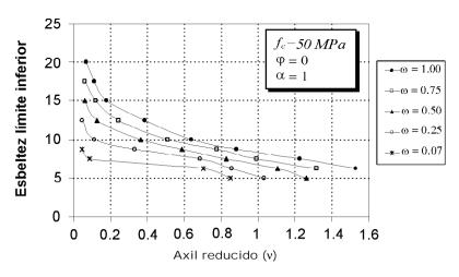
Figura 6. Influencia de la cuantía mecánica de armadura en la esbeltez límite inferior.
