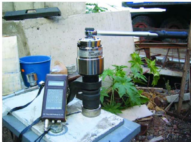
Figura 27. Ensayo con célula de carga. Figure 27. Test with load cell.
