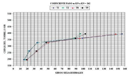
Figura 33. Relación par-giro. Figure 33. Torque - spin ratio.
