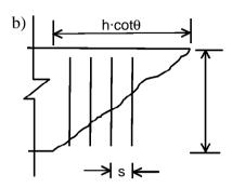
Figura 2. a) Estribos 90° y bielas a 45° b) Estribos a 90° y bielas a  $\theta$ .
