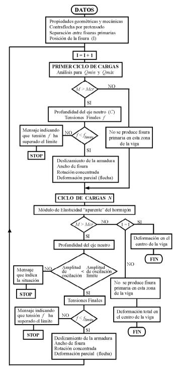
Figura 5. Diagrama de Flujo correspondiente al modelo propuesto "PCCBEAM"
