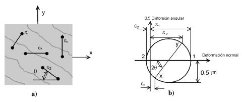
Figura 4. Condiciones de compatibilidad para el alma agrietada.
