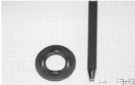
Figura 14. Detalle de una Arandela Indicadora de Tensión. (DTIs).
