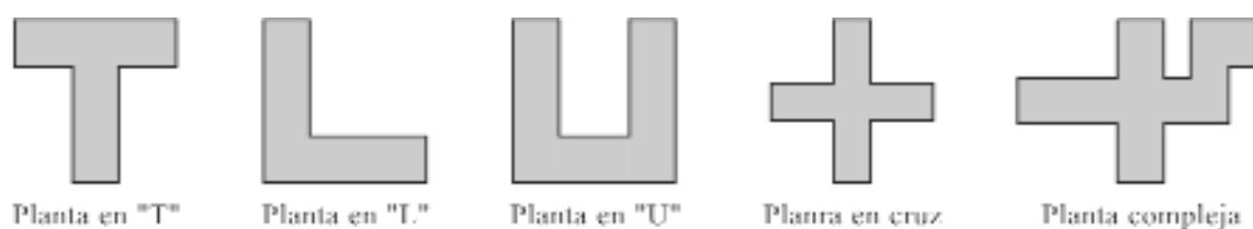
Figura 19. Factores de incertidumbre en el comportamiento sísmico de las estructuras de edificación.
