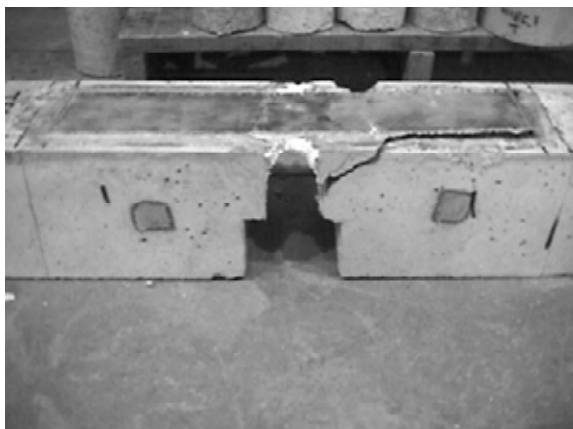
Figura 9. Paramento inferior de las probetas de adherencia. Detalle del mecanismo de rotura.
