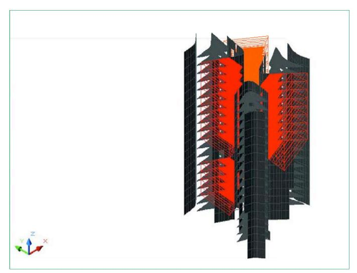
Figura 14. Modelo de análisis con elementos finitos para el cálculo estático. Figure 14. Finite elements model for the static analysis.
