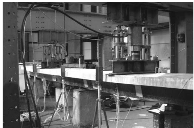
Foto 2. Medidores de flechas. Viga instrumentada.
