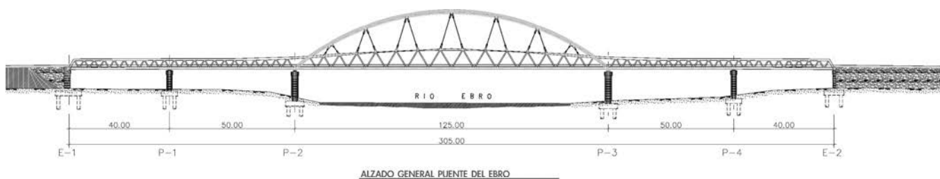
Figura 1. Alzado general de la estructura.
