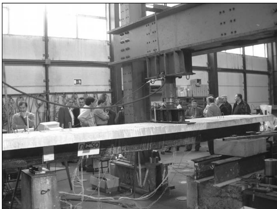
Foto 4. Ensayo de la viga sólo de carbono.
