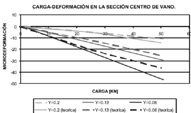
Figura 20. Diagrama Carga-Deformación en la viga. Sección centro de vano.
