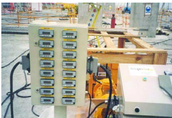
Figura 10. Visores de medida para cada uno de los gatos.
