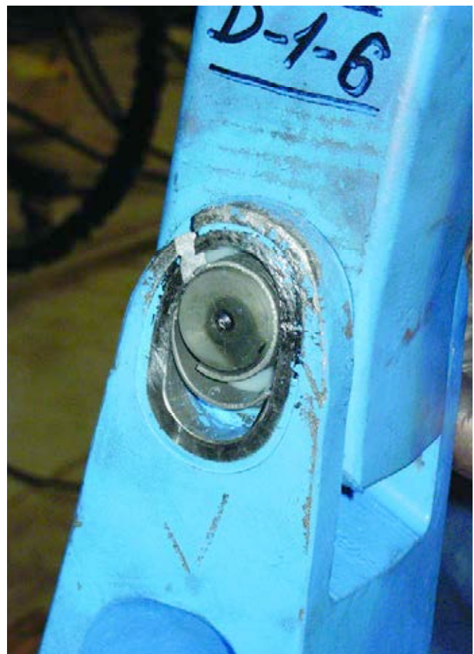
Figura 12. Muestra ensayada de medio montante con manguito bulonado y barra roscada \varnothing 32.7 mm.
