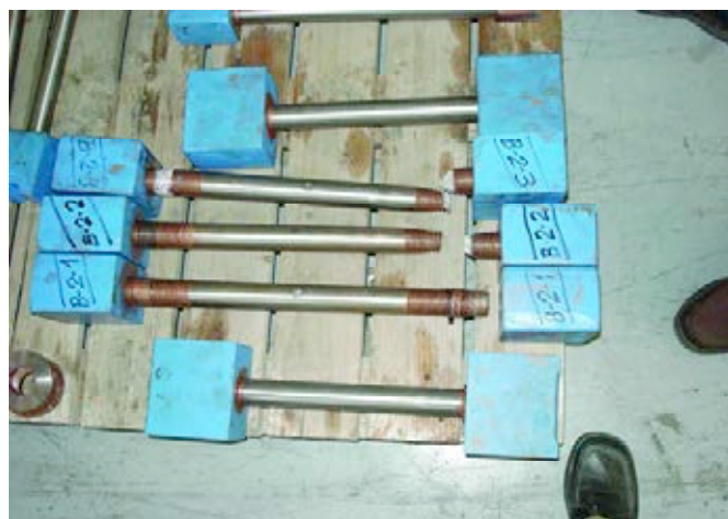
Figura 10. Muestras ensayadas de unión roscada barra-manguito.
