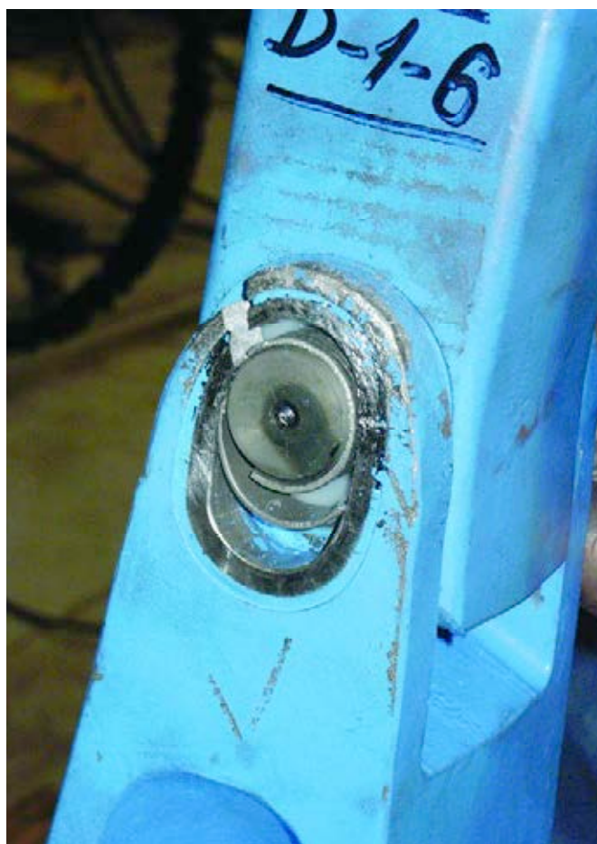
Figura 12. Muestra ensayada de medio montante con manguito bulonado y barra roscada \varnothing 32.7 mm.
