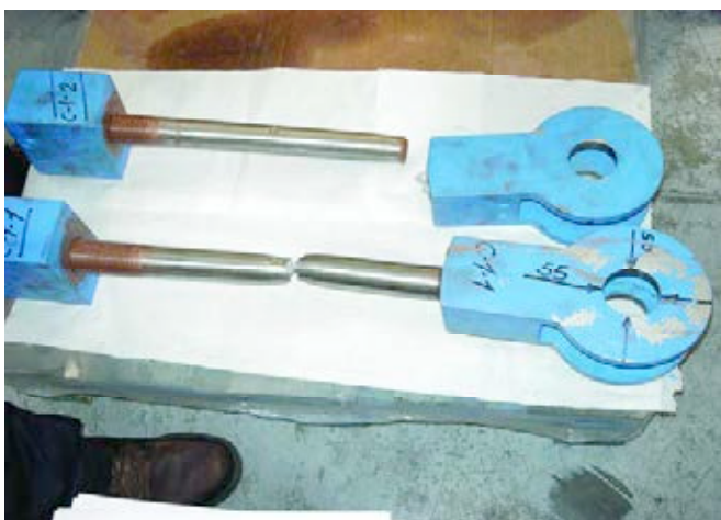
Figura 11. Muestras ensayadas de barra \varnothing 37.9 con horquilla de fijación a cubierta.
