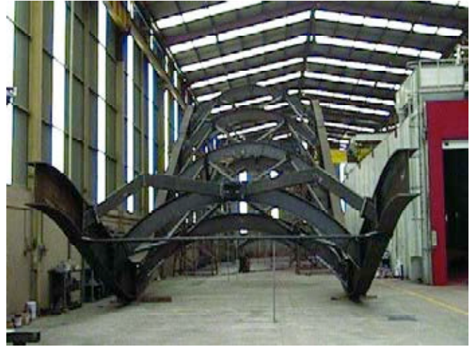
Figura 25. Montaje en blanco en taller.
