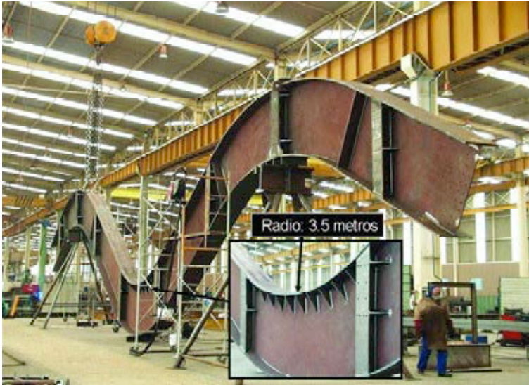
Figura 13. Dintel: fabricación en taller.
