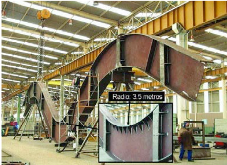
Figura 13. Dintel: fabricación en taller.
