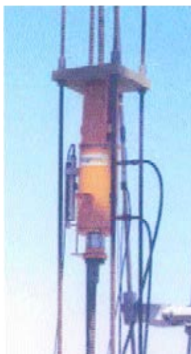
Figura 8. Detalle de uno de los gatos
