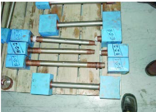
Figura 10. Muestras ensayadas de unión roscada barra-manguito.
