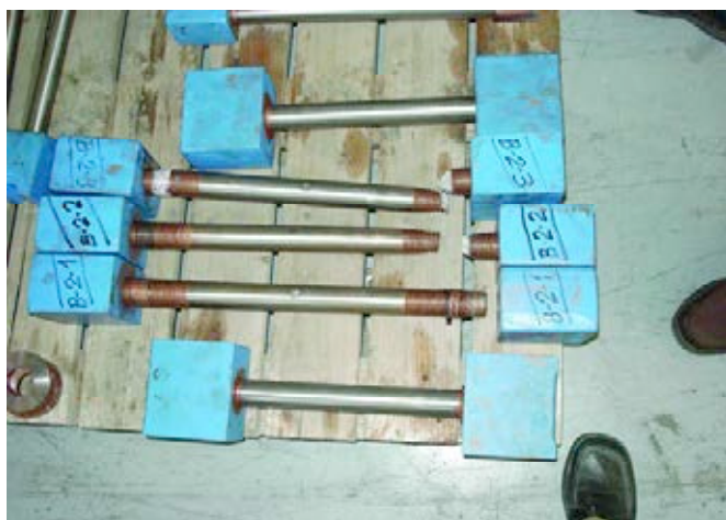
Figura 10. Muestras ensayadas de unión roscada barra-manguito.
