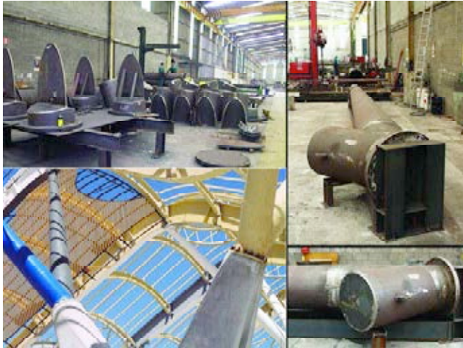
Figura 17. Base de pilar en V: fabricación.
