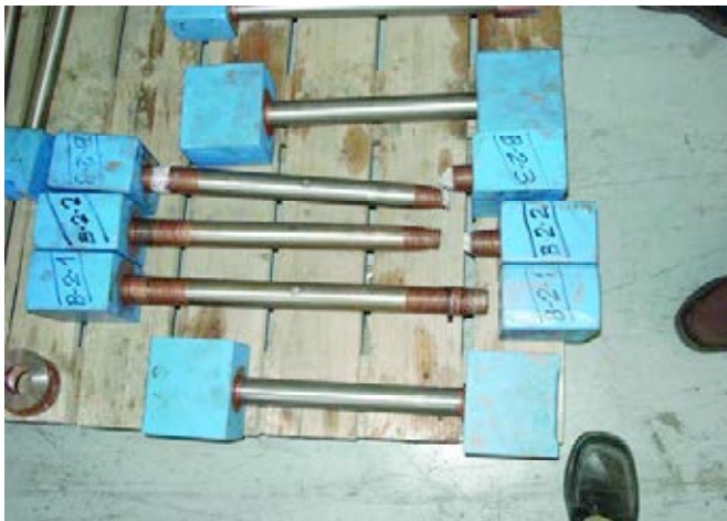
Figura 10. Muestras ensayadas de unión roscada barra-manguito.
