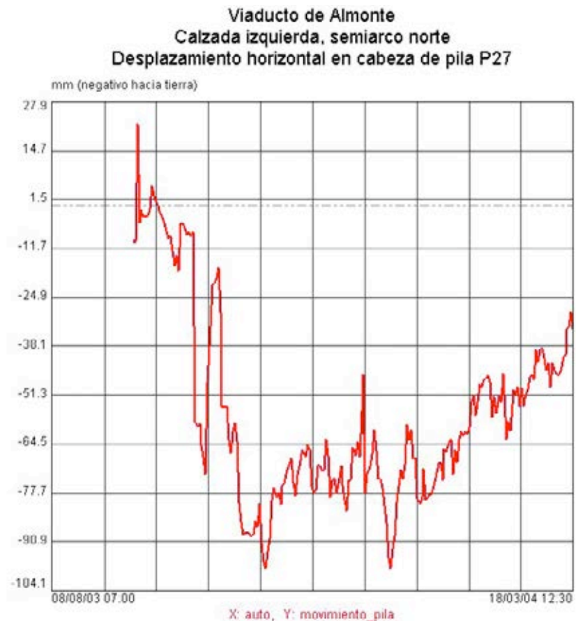
Fig.37. Ejemplo de gráfico acumulado en tiempo real de uno de los sensores controlados. Fig.37. Example of a real time accumulated graph of one of the monitored sensors.
