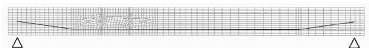
Figura 4. Mallado de la viga V1 incluyendo los elementos tipo cable (en negro).
