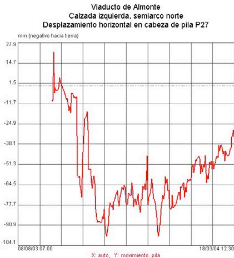
Fig.37. Ejemplo de gráfico acumulado en tiempo real de uno de los sensores controlados. Fig.37. Example of a real time accumulated graph of one of the monitored sensors.
