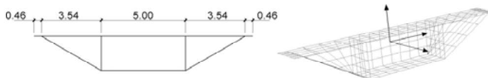
Figura 2. Esquema y mallado de una porción de 1,55m. de longitud de un Modelo Patrón.
