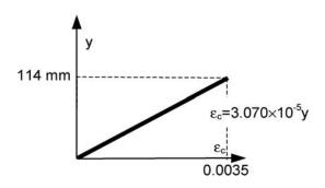
Figura 10. Ley de deformaciones del hormigón.
