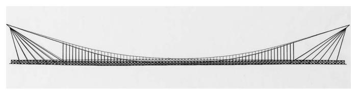
Figura 30. Deformada de la combinación de acciones que produce máximo axil en el cable horizontal. Figure 30. Deformed structure from the combination of loads producing maximum axial force in the horizontal cable.
