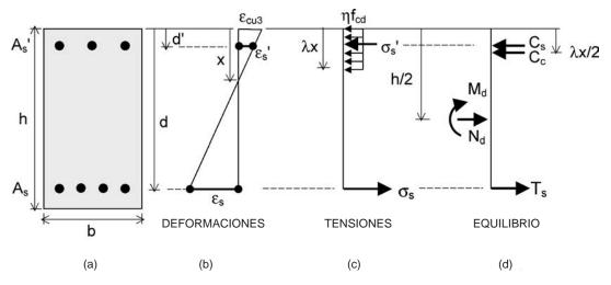
Figura 5. Términos empleados en el diagrama rectangular del hormigón, según el Eurocódigo 2.
