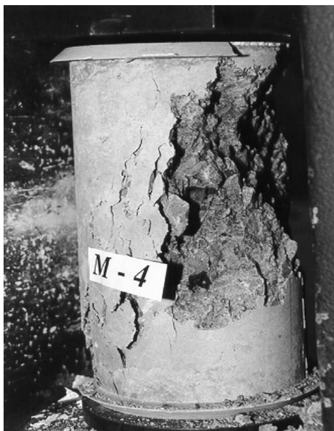
Figura 3. Rotura probeta dosificación M-4.
