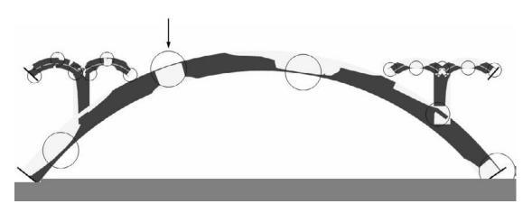
Figura 3. Mecanismo de colapso del arco para la posicición más desfavorable.
