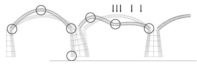
Figura 15. Deformada en rotura para una carga en la clave del puente de San Rafael.
