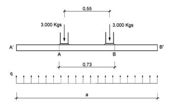
Figura 13. Reparto de cargas en el forjado. Figure 13. Load distribution in the slab floor.
