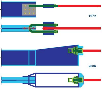
Figure 35. Cable horizontal existente y nuevo. Figure 35. Existing and new horizontal cable.
