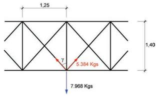
Figura 12. Viga de rigidez. Figure 12. Stiffening beam.
