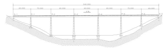
Figura 1. Alzado del Viaducto de San Timoteo.
