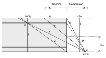
Figura 11. Planos de deformación en flexión negativa.
