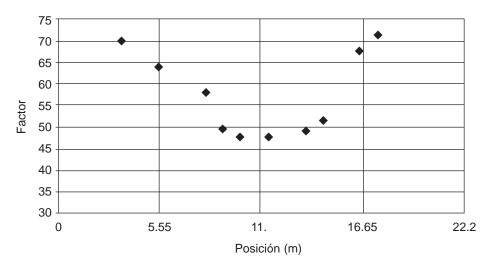
Figura 8. Factor de carga en función de la posición de la sección cargada.
