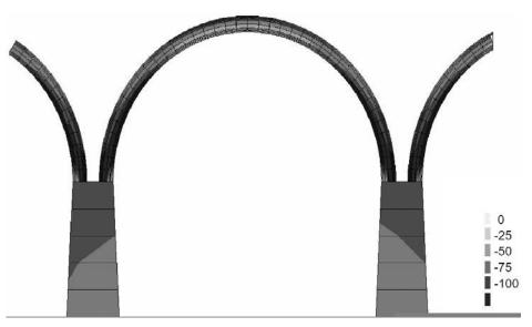
Figura 7. Estado tensional del puente de Magarola bajo peso propio. Tensiones en kN/m²(x10).
