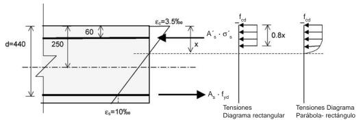
Figura 9. Plano de rotura nº3. Diagrama de tensiones.
