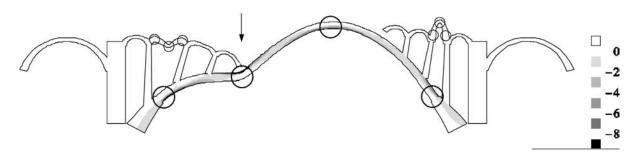
Figura 20. Geometría deformada (amplificad x50) en rotura para una carga aplicada en L/4 del arco principal.
