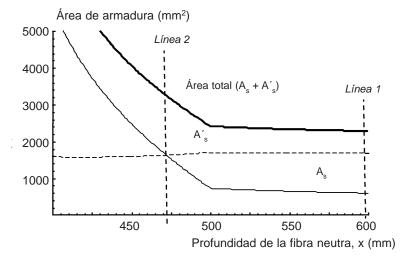
Figura 16. Diagrama de armado a flexión para un pilar de 0.4 x 0.4 m y acciones de N<sub>d</sub>=3000 y M<sub>d</sub>=60 kN·m.
