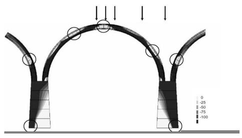
Figura 9. Estado tensional del puente de Magarola en rotura. Rótulas. Tensiones en kN/m²(x10). Fisuración en blanco.
