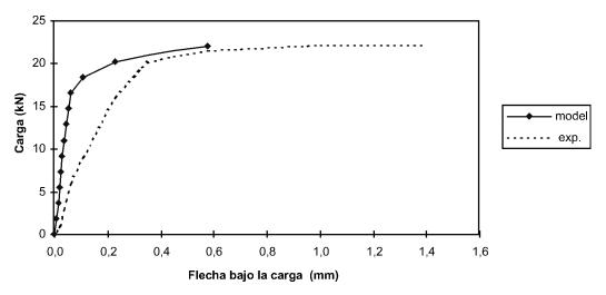
Figura 4. Comparación del resultado de la flecha bajo el punto de carga.
