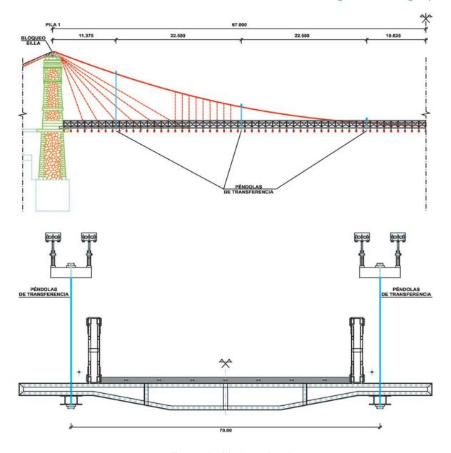
Figura 37. Péndolas de transferencia. Figure 37. Transfer suspenders.
