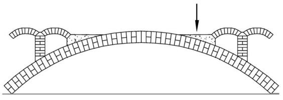
Figura 2. Esquema del puente con tímpanos aligerados ensayado por Melbourne y Tao (1998).
