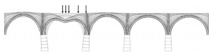
Figura 11. Deformada amplificada del puente de Magarola en rotura.
