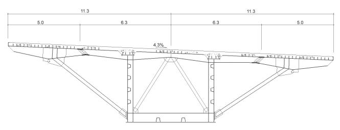
Figura 5. Sección tipo ampliada del Viaducto de Canero.
