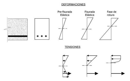
Figura 2. Hipótesis de las secciones planas.
