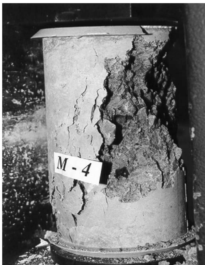
Figura 3. Rotura probeta dosificación M-4.
