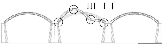
Figura 13. Deformada en rotura de los arcos 2, 3 y 4 del puente de San Rafael.
