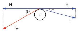
Figura 11. Tensión en el cable de retenida. Figure 11. Guy cables' force.
