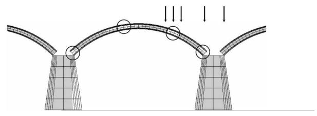
Figura 14. Fisuración (en blanco) del arco cargado del puente de San Rafael en condiciones de rotura. Rótulas.
