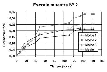
Figura 2 Hinchamiento sobre muestra 2 según ASTM D-4792.
