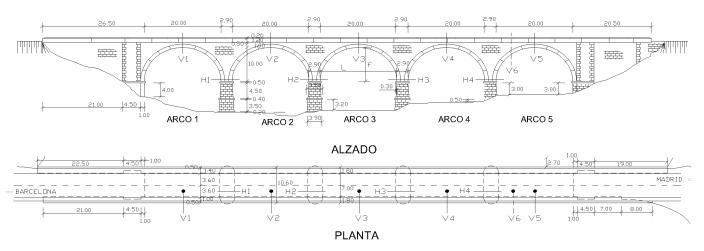
Figura 6. Planta y alzado del puente de Magarola.
