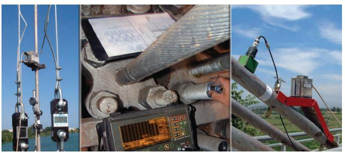
Figura 28. Ensayos: pesaje de una péndola, inspección por ultrasonidos y ensayo de cuerda vibrante. Figure 28. Tests: weighting a suspender, ultrasonic inspection and vibrating chord test.
