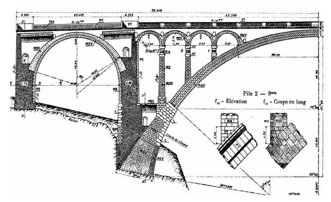
Figura 17. Sección longitudinal del puente Adolfo (16).
