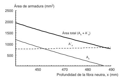
Figura 15. Diagrama de armado a flexión para un pilar de 0.4 x 0.4 m y acciones de N<sub>d</sub>=2500 y M<sub>d</sub>=50 kN⋅m.
