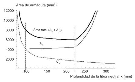
Figura 14. Diagrama de Armado a Flexión para un pilar de 0.4 x 0.4 m y acciones de N<sub>a</sub>=0 y M<sub>d</sub>=387.5 kN⋅m.
