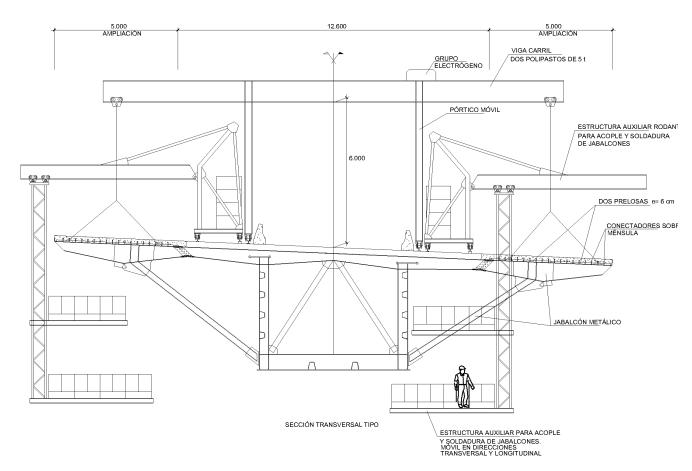
Figura 7. Sistema de montaje previsto en proyecto.
