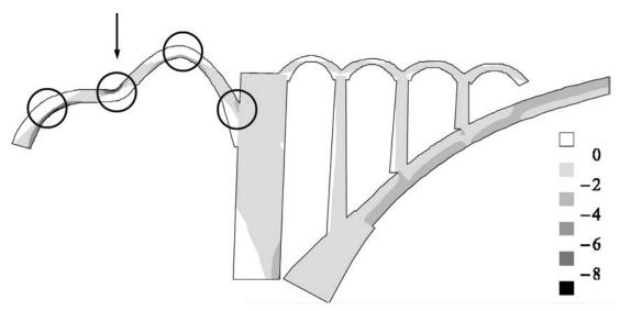
Figura 18. Geometría deformada (amplificada x50), fisuración distribuida (en blanco) y tensiones de compresión (N/mm²) en rotura bajo una carga aplicada cerca de la clave del arco de aproximación. Se señalan sólo las rótulas completamente formadas.
