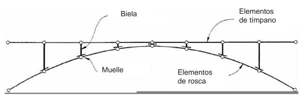
Figura 1. Modelización completa de la rosca y los tímpanos de un puente arco mediante un sistema de barras equivalente.
