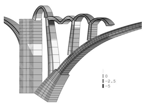
Figura 19. Deformación (x50), fisuración (en blanco) y distribución de compresiones en escala de grises correspondiente a rotura en la estructura de aligeramiento de los tímpanos aligerados bajo una carga aplicada en la clave del segundo arco.
