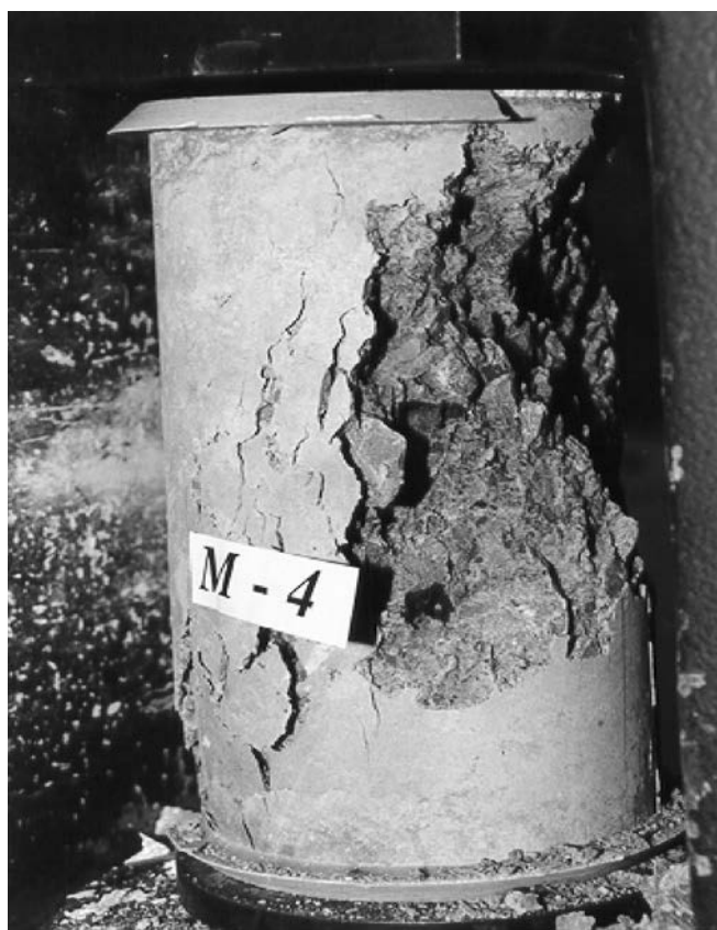
Figura 3. Rotura probeta dosificación M-4.
