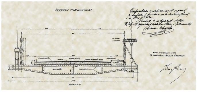
Figura 5. Plano original de la sección transversal del tablero. Figure 5. Original plan of the deck's cross section.
