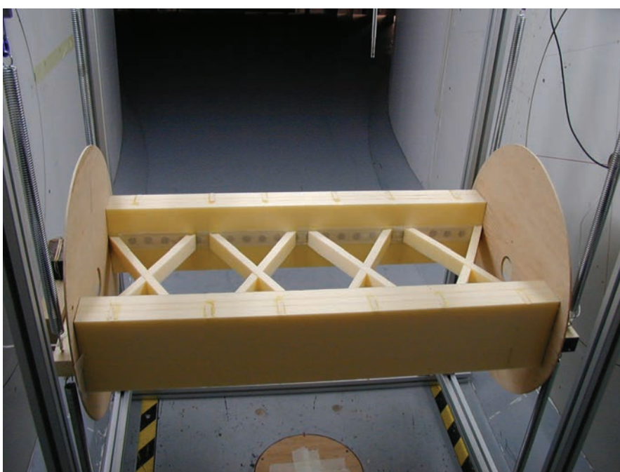
Figura 59. Modelo seccional del arco, sin deflectores, montado en túnel de viento. Figure 59. Sectional arch model, without guide vanes, mounted in a wind tunnel.
