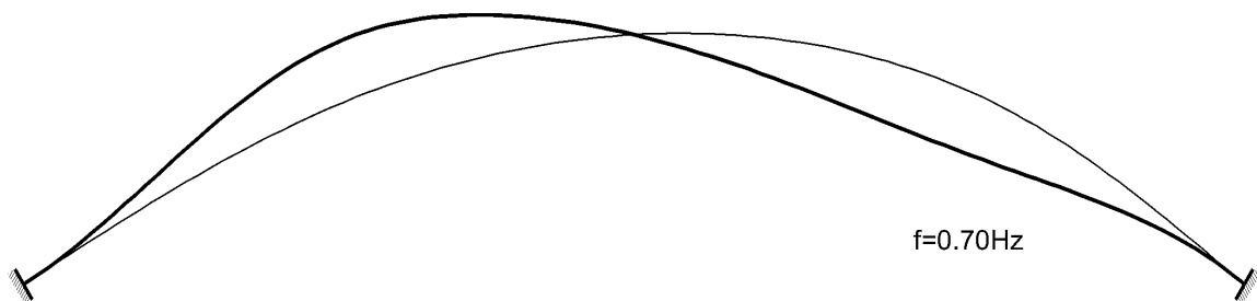
Figura 1. Modo de vibración hemisimétrico.
