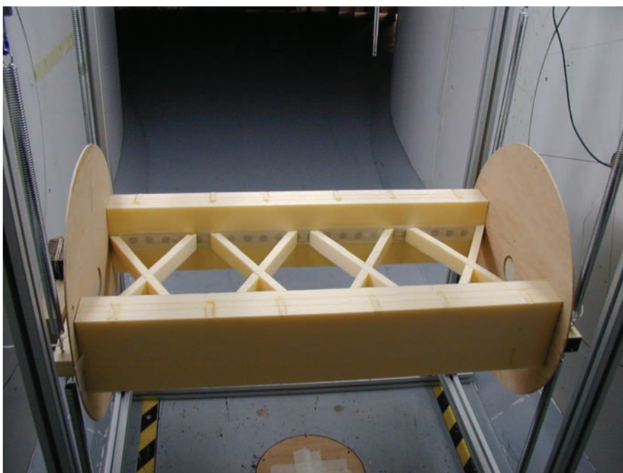
Figura 59. Modelo seccional del arco, sin deflectores, montado en túnel de viento. Figure 59. Sectional arch model, without guide vanes, mounted in a wind tunnel.
