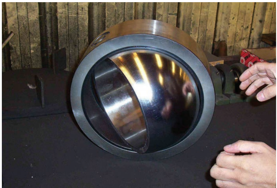
Figura 48. Rótula esférica de bulón pasante, antes de su montaje en la zona inferior del arco Figure 48. Radial spherical plain bearing, before fitting in bottom arch area.
