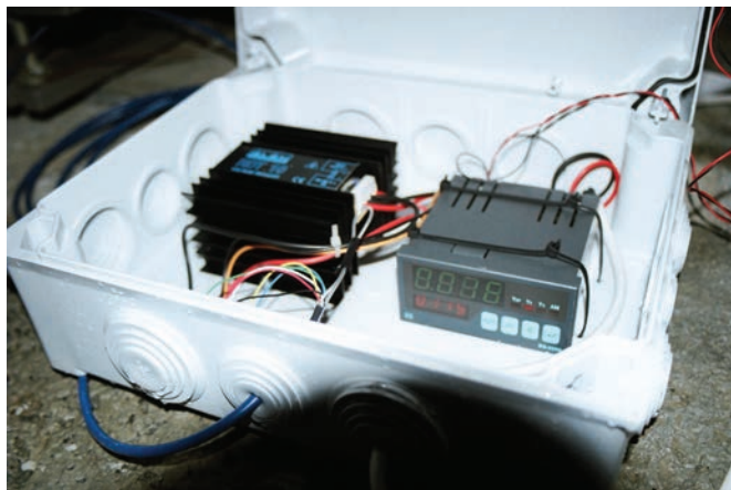
Fig. 34. Caja con convertidor de señal del clinómetro y con el limitador de giro máximo admisible Fig. 34. Box with a clinometer signal converter and with the maximum admissible rotation limiter
