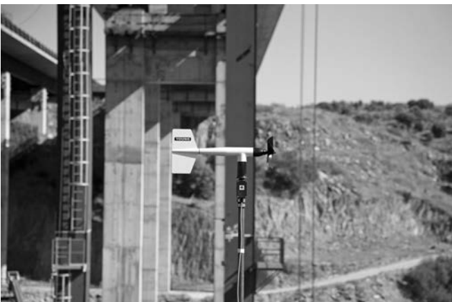
Figuras 6 y 7. Anemómetro-veleta y acelerómetro (este último trasladado posteriormente al interior del arco).
