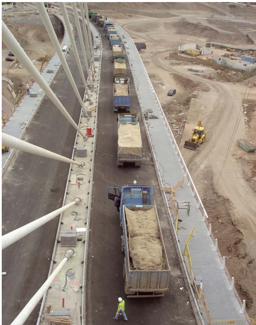
Figura 38. Prueba de carga estática. Hipótesis de torsión. Figure 38. Static loading test (torsion hypothesis)
