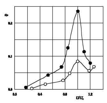
Figura 8. Variación con la velocidad del corriente incidente adimensionalizada con la velocidad de sintonización, U/Us, de la amplitud adimensional de la fuerza lateral medida en la balanza, cF, para la configuración sin reflectores (L0D0, círculos negros) y con tres deflectores en cada arista (L4D3, círculos blancos). En este caso se ha empleado la presión dinámica de la velocidad de sintonización para adimensionalizar el coeficiente de fuerza.
