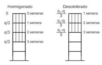
Figura 5. Operaciones de hormigonado y descimbrado según el método INTEMAC.
