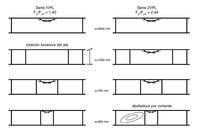
Figura 8. Tipos de fallo observados en los ensayos.
