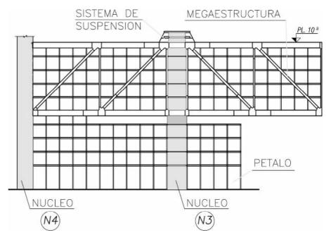
Figura 10. Edificio Portaaviones (sección C fig. 6). Figure 10. Aircraft-carrier building (section C. fig. 6).
