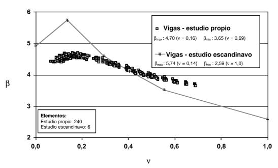
Figura 5. Índice de fiabilidad,  $\beta$ , en función del ratio entre cargas variables y totales,  $\nu$ , para el mecanismo de fallo por flexión. Comparación de los resultados obtenidos en el presente estudio para 240 vigas de cubierta de hormigón armado con los resultados del estudio [25] (Período de referencia: 50 años).
