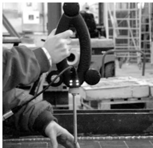
Figura 6. Medición de imperfecciones iniciales.
