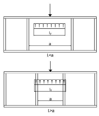
Figura 3. Longitud eficaz cargada y distancia entre rigidizadores.
