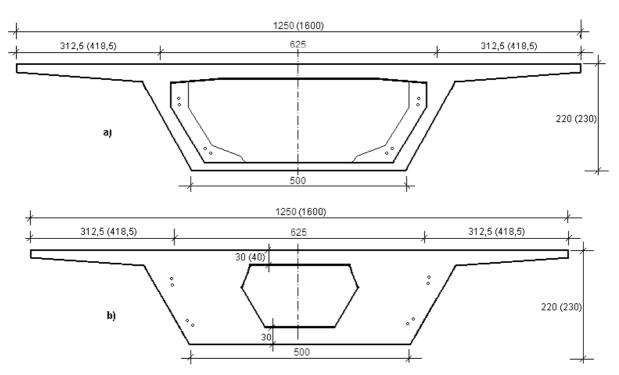
Figura 1. Secciones transversales del viaducto estudiado:
