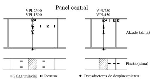
Figura 5. Instrumentación de las vigas armadas híbridas.
