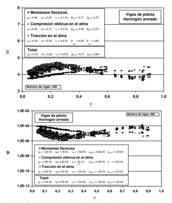
Figura 3. Índice de fiabilidad,  $\beta$ , y probabilidad de fallo,  $p_{f'}$  en función del ratio entre cargas variables y totales,  $\nu$ , para tres mecanismos de fallo de cada una de las 450 vigas de planta de hormigón armado analizadas (Período de referencia: 50 años).
