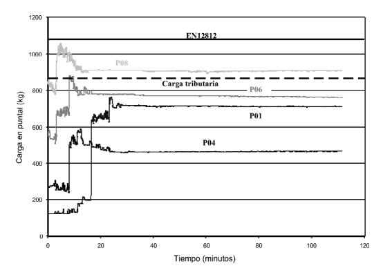
Figura 9. Cargas medidas en puntales durante el hormigonado del forjado +2 en Getaria.
