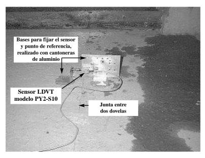
Figura 7. Detalles del montaje del sensor usado en las mediciones.
