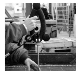
Figura 6. Medición de imperfecciones iniciales.
