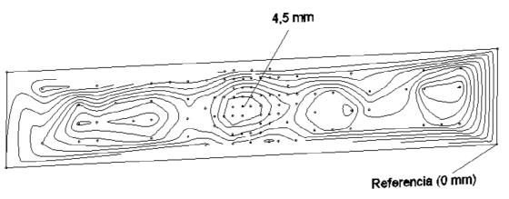
Figura 7. Magnitud y forma aproximada de la deformada inicial del panel de alma de la viga 1VPL2500.
