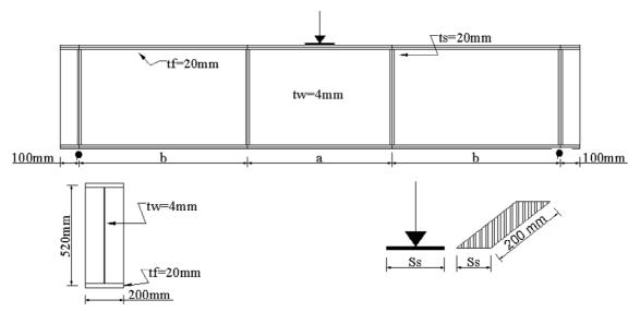
Figura 4. Configuración general de los ensayos.
