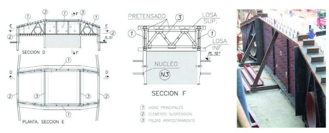
Figura 11. Estructura de suspensión en coronación del núcleo 3. Figure 11. Suspended structure at the crown of core 3.
