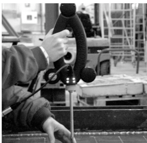
Figura 6. Medición de imperfecciones iniciales.
