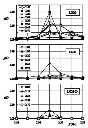
Figura 9. Variación con la frecuencia de oscilación, f, del desplazamiento vertical del puente adimensionalizado con el canto del arco, y/D, para distintos valores de la velocidad reducida Ur = U/(nB), donde U es la velocidad del ensayo, n la frecuencia propia del modelo y B la cuerda de la sección del puente. Los símbolos identifican el valor de la velocidad reducida de acuerdo con la clave incluida en la figura. Resultados correspondientes a las configuraciones LODO, L4D3 y L4D3-D.
