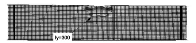
Figura 16. Ly=300 milímetros observada para la viga 1VPL450 (estado de tensiones verticales).
