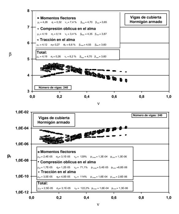
Figura 2. Índice de fiabilidad,  $\beta$ , y probabilidad de fallo,  $p_f$ , en función del ratio entre cargas variables y totales,  $\nu$ , para tres mecanismos de fallo de cada una de las 240 vigas de cubierta de hormigón armado analizadas (Período de referencia: 50 años).
