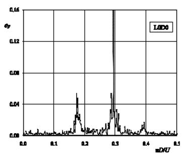
Figura 5. Espectro del coeficiente de fuerza lateral medido en la balanza del túnel A9 para la configuración básica del modelo de ensayos (arco sin añadidos, configuración L0D0).
