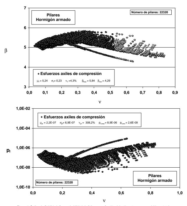
Figura 4. Índice de fiabilidad,  $\beta$ , y probabilidad de fallo,  $p_{f'}$  en función del ratio entre cargas variables y totales,  $\nu$ , para los 22320 pilares de hormigón armado analizados (Período de referencia: 50 años).
