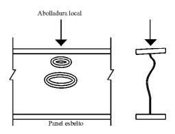
Figura 1. Introducción de cargas concentradas. Extremos opuestos de diseño.
