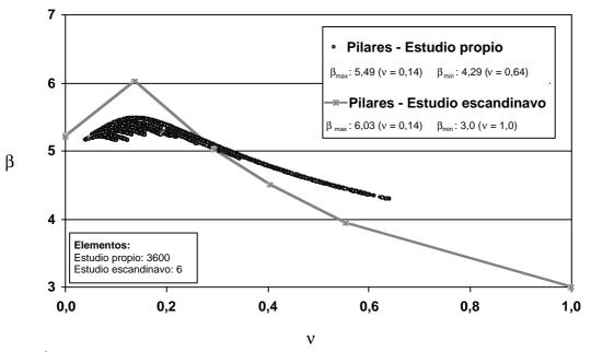
Figura 6. Índice de fiabilidad, β, en función del ratio entre cargas variables y totales, v, para pilares de hormigón armado expuestos a situaciones con la carga de nieve como única acción variable. Comparación de los 3600 resultados del presente estudio con los resultados del estudio [25] (Período de referencia: 50 años).
