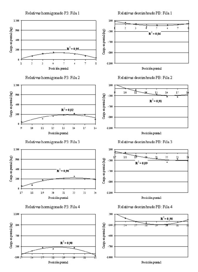
Figura 7. Variaciones de cargas en puntales bajo losas parcialmente endurecidas.
