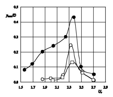
Figura 11. Amplitud adimensional máxima de la oscilación, ymax/D, en función de la velocidad reducida, Ur, para las tres configuraciones ensayadas: arco original (configuración L0D0, círculos negros), arco con deflectores en posición nominal (configuración L4D3, círculos blancos), y arco con deflectores en posición adelantada (configuración L4D3-D, cuadrados).
