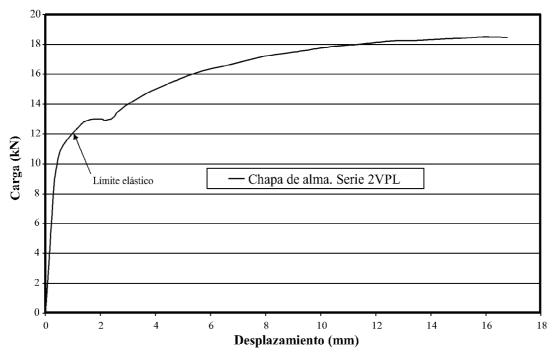
Figura 11. Curva carga-desplazamiento. Probeta ensayada a tracción.
