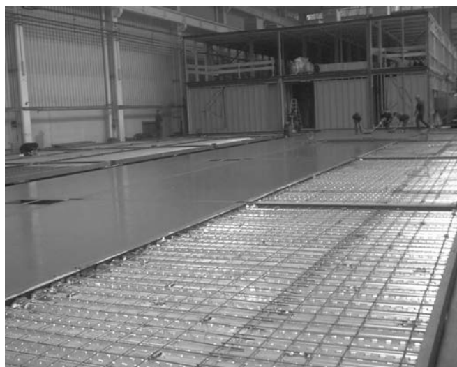
Figura 28. Factoría MODULTEC (Asturias). Interior de la nave con el hormigonado de las placas base de chapa colaborante.
