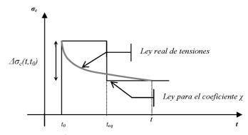
Figura 6. Escalón de tensiones empleado para aproximar la ley de tensiones real.
