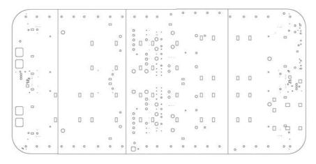
Figura 4. Planta de la estructura con situación general de embebidos, pasatubos y bocas de acceso en la losa superior.
