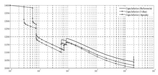
Figura 17. Evolución de las tensiones en la capa inferior de armadura pretesa de la viga.
