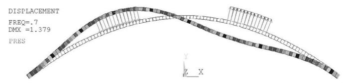
Figura 5. Vibraciones en el arco exento sin deflectores.
