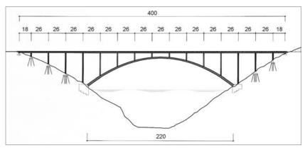
Figura 2. Esquema estructural del puente.
