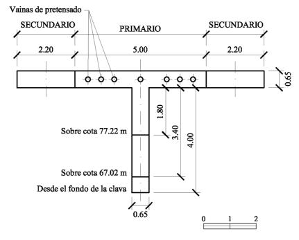
Figura 4 Sección transversal del módulo primario.
