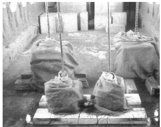
Curado de probetas en cámara climática
