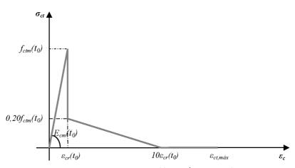
Figura 2. Diagrama constitutivo para el hormigón traccionado.
