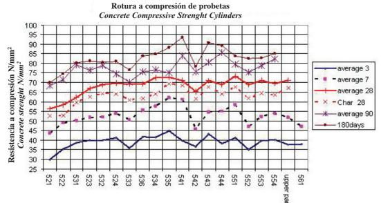
Figuras 8. Estadística de los valores de resistencia a distintas edades del hormigón en las distintas secuencias constructivas.
