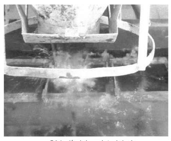
Fabricación de las probetas bajo el agua
