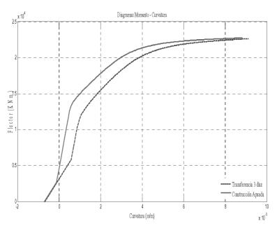
Figura 19. Diagramas momento-curvatura para cada situación constructiva.
