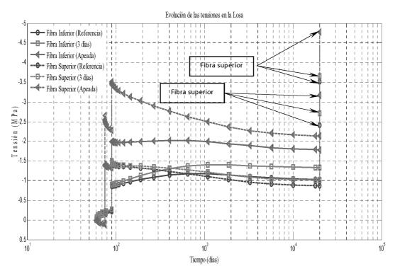
Figura 13. Evolución de las tensiones en las fibras extremas de la losa.
