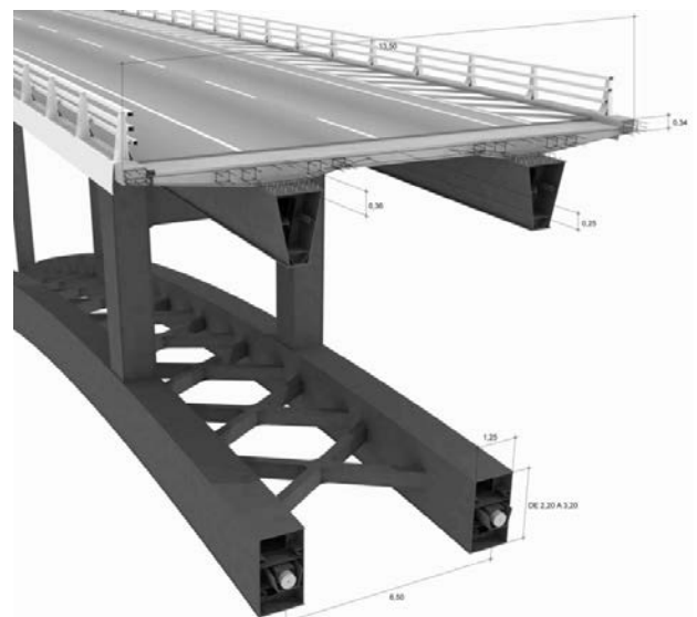
Figura 3. Detalle de la sección transversal.
