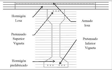
Figura 9. Ejemplo de discretización de una sección compuesta por dos hormigones.
