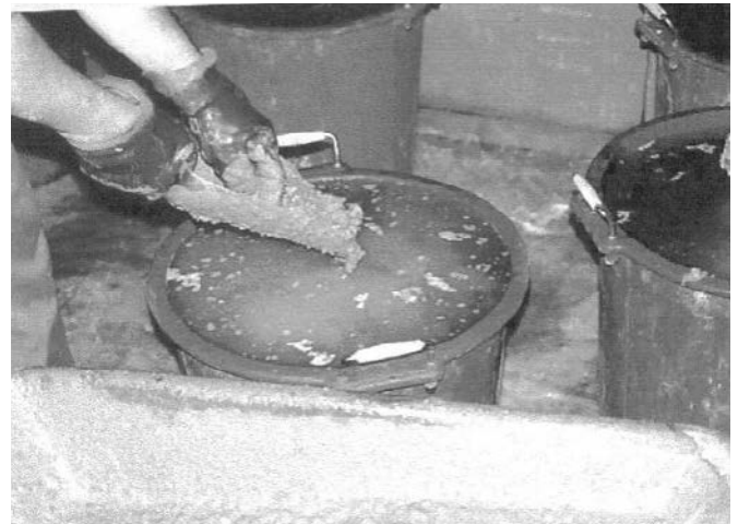
Moldeo de probetas bajo el agua dejando caer el hormigón en caída libre desde el borde de la lámina de agua (aproximadamente 5 cm. sobre la boca del molde) y sin aplicar compactación.
