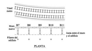
Figura 2. Planta y alzado del muro pantalla con contrafuertes.
