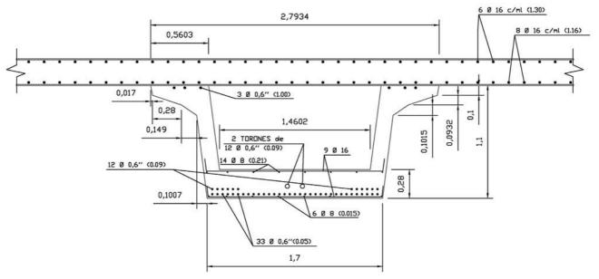
Figura 11. Sección empleada en el análisis.
