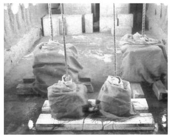
Curado de probetas en cámara climática
