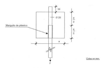
Esquema de la probeta para el ensayo de pull-out
