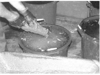
Moldeado de probetas bajo el agua dejando caer el hormigón en caída libre desde el borde de la lámina de agua (aproximadamente 5 cm. sobre la boca del molde) y sin aplicar compactación.
