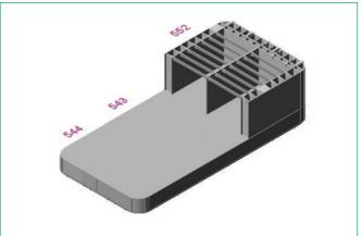
Figura 11.6. Terminación de la losa de los tanques (10.000 m³). Ejecución de los muros superiores con espesores entre 0,6 y 0.45m. y altura de 33m. (7.000 m³ cada secuencia). en aprox. 15-17 días. Colocación de las vigas de soporte de la losa superior, luego de deslizar hasta "554" (aprox. 220 t c/u)
