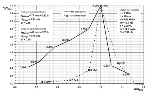
Figura 4. Resultados del ensayo en túnel de viento.
