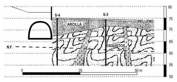
Figura 1. Perfil geológico del terreno en la dirección perpendicular al eje del túnel.
