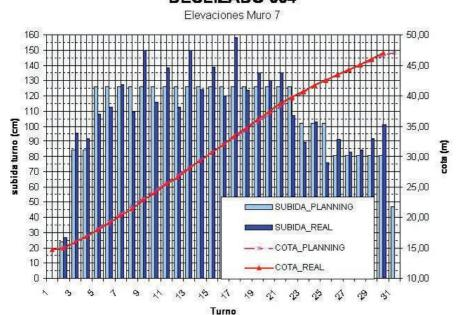
Figura 12. Seguimiento de la Producción y avance de una secuencia de deslizado. Figure 12. Tracking of Production and slipforming sequence progress.
