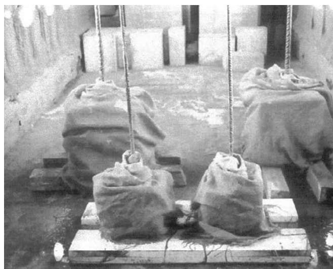
Curado de probetas en cámara climática
