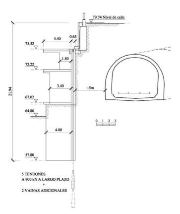
Figura 3. Perfil del muro y sus contrafuertes (perfil del contrafuerte B8).
