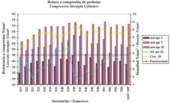
Figuras 9. Estadística de valores de los valores de resistencia a distintas edades y densidades del hormigón en las distintas secuencias constructivas.
