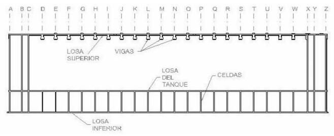
Figura 6. Sección vertical longitudinal Figure 6. Longitudinal vertical cross section.
