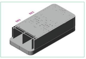
Figura 11.7. Ejecución de las secuencias de la losa superior de 0,5m. de canto.
