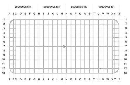
Figura 2. Sección horizontal de la estructura hasta lacota +13.00 desde nivel de dique seco. Celdas doble casco con muros exteriores de 0,6m. de espesor. Muros medianeros de 0,45m. Figure 2. Horizontal cross section up to elevation +13.00, from dry dock level. Dual-hull cells with 0.6 m. thick outside walls.
