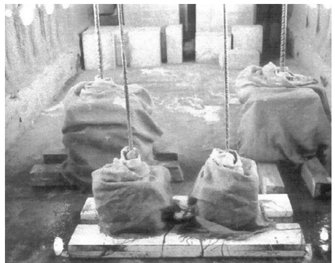
Curado de probetas en cámara climática
