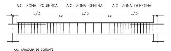
Figura 3. Armadura de cortante de vigas.
