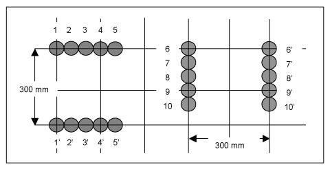
Figura 9. Esquema de ensayos en la campaña para evaluar la influencia de las armaduras.
