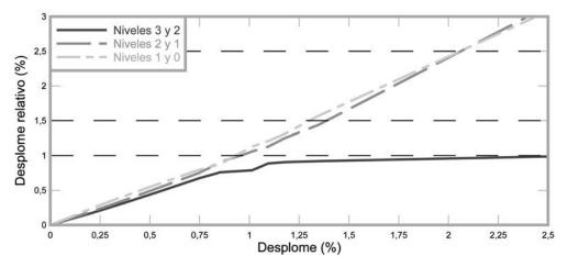
Figura 21. Determinación de los umbrales de daño del edificio porticado con vigas de canto.
