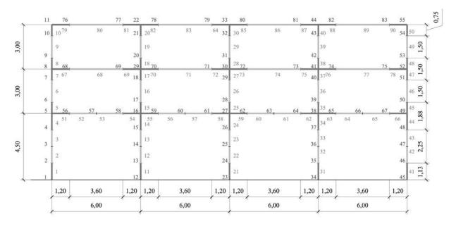
Figura 7. Discretización típica de los pórticos analizados.
