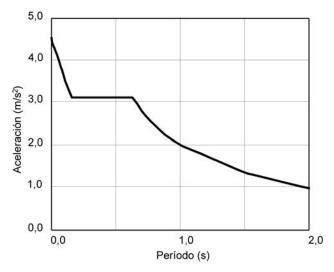
Figura 7. Espectro inelástico derterminado de acuerdo con la norma NCSE-02.
