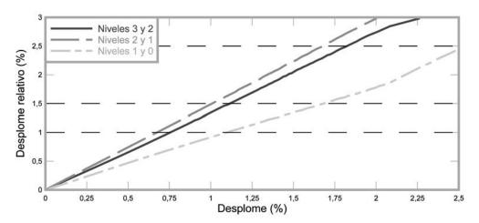
Figura 19. Determinación de los umbrales de daño del edificio con forjados reticulares
