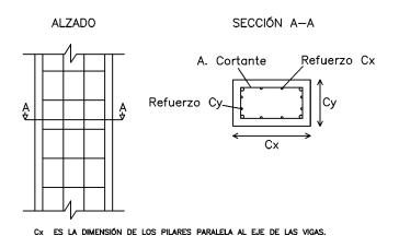
Figura 4. Armadura de pilares.
