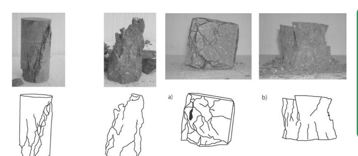
Figura 7. Fisura inclinada en probetas cilíndricas de 150 mm de altura.
