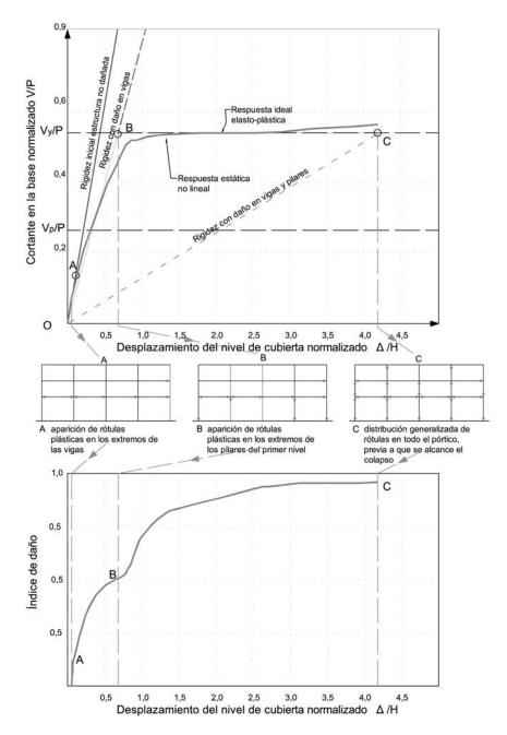
Figura 3. Curva de capacidad y de evolución de daño con la secuencia de formación de rótulas plásticas para: A) aparición de rótulas en los extremos de las vigas, B) aparición de rótulas en pilares de primer nivel y C) aparición generalizada de rótulas en vigas y pilares.
