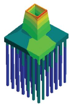
Figura 20. Modelo de interacción terreno-estructura en encepado de pilas 2 y 3. Figure 20. Model of ground-structure interaction in the capping of piers 2 and 3.
