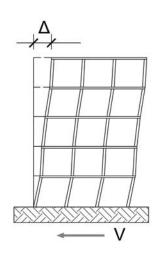
Figura 5. Cálculo de la rigidez estructural bajo cargas de push-over.
