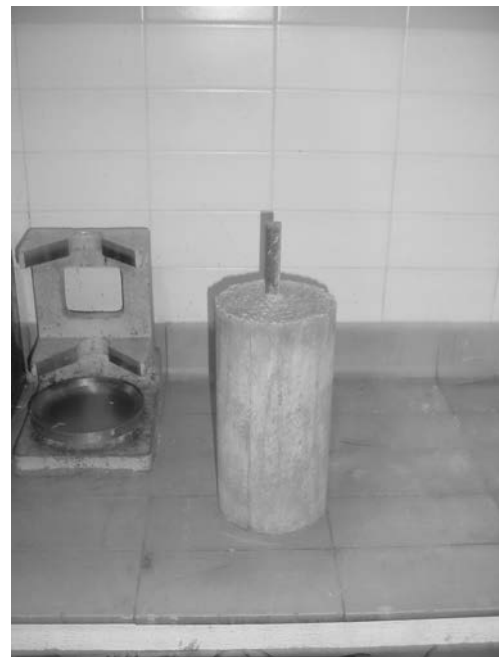
Figura 8.- Probeta mixta acero-hormigón
