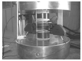
Figura. 2. Probeta D3 con los dos extensómetros resistivos montados para medir la deformación hasta rotura y los dos captadores inductivos utilizados para controlar el ensayo y medir la deformación media.
