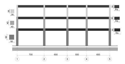
Figura 2. Pórtico equivalente del edificio con forjados reticulares.
