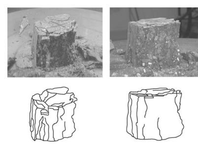
Figura 9. Fisuración en forma de columnas observada en un cubo de 50 mm de arista.
