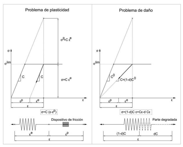
Figura 4. Formas simplificadas de entender el comportamiento elastoplástico y el daño.
