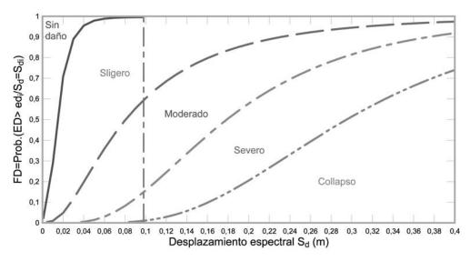
Figura 24. Curvas de fragilidad del edificio porticado con vigas de canto.
