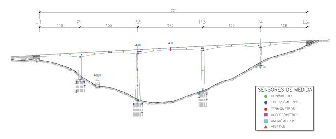
Figura 37. Plano de instrumentación (cotas en metros) Figure 37. Instrumentation drawing (levels in metres).
