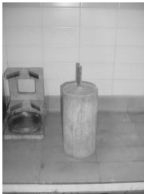
Figura 8.- Probeta mixta acero-hormigón
