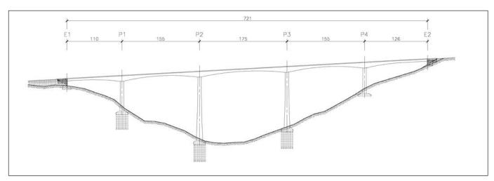
Figura 5. Alzado (cotas en metros). Figure 5. Elevation (levels in metres).
