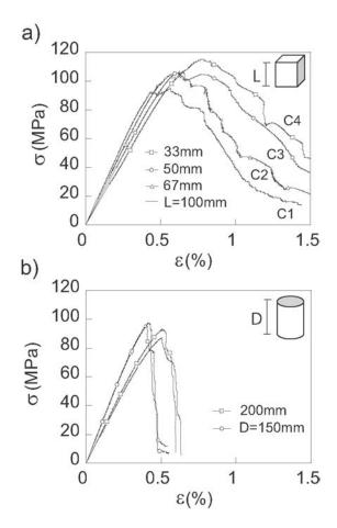
Figura 3. Curvas  $\sigma$ – $\varepsilon$  correspondientes a los diferentes tipos de probetas ensayadas: (a) Probetas cúbicas; (b) Probetas cilíndricas.
