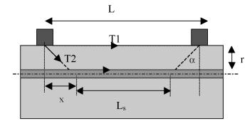
Figura 6. Transmisión ultrasónica indirecta en hormigón armado.
