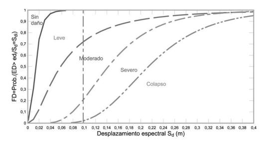
Figura 23. Curvas de fragilidad del edificio porticado con vigas planas.
