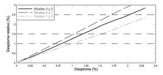
Figura 20. Determinación de los umbrales de daño del edificio porticado con vigas planas.
