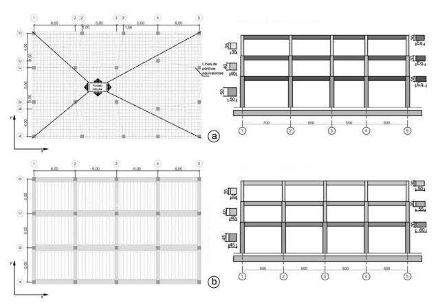
Figura 6. Planta típica del edificio con forjados reticulares (igual en todos los niveles).
