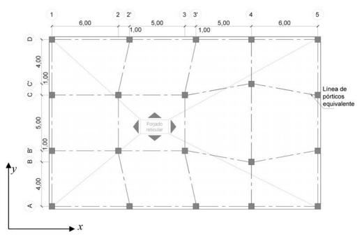
Figura 1. Planta típica del edificio con forjados reticulares (igual en todos los niveles).
