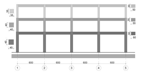
Figura 4. Pórtico del edificio con vigas planas.
