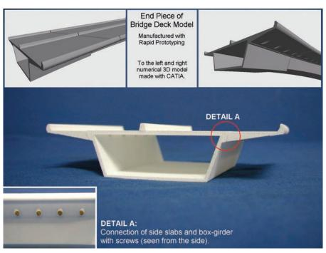
Figura 38. Detalle de modelización de sección del tablero. Figure 38. Detail of the deck cross section's modelling.
