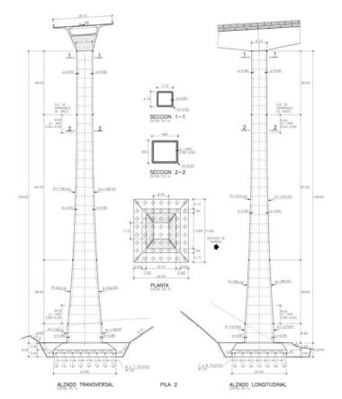
Figura 10. Geometría de pila 2. Figure 10. Geometry of pier 2.
