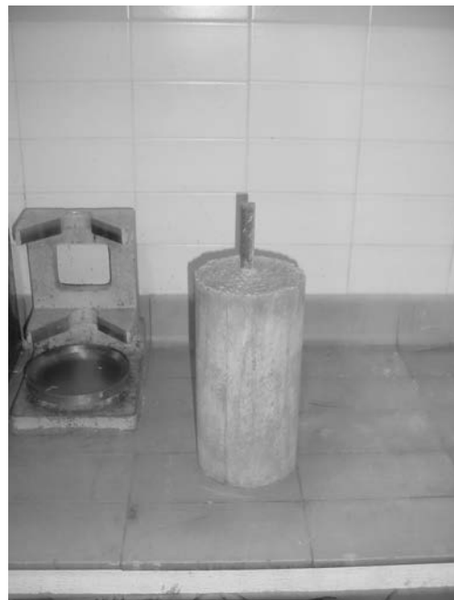
Figura 8.- Probeta mixta acero-hormigón
