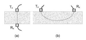
Figura 4. Posición de los palpadores: a) transmisión directa  $(V_c)$ ; b) transmisión indirecta  $(V_r)$ .
