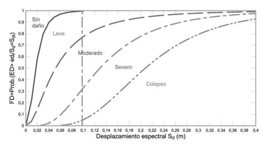
Figura 22. Curvas de fragilidad del edificio con forjados reticulares.
