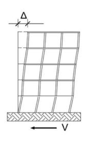
Figura 11. Esquema para la determinación del índice de daño de un elemento estructural.
