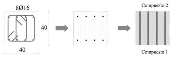
Figura 9. Discretización de las secciones de los elementos.
