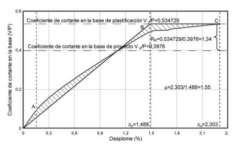
Figura 14. Curva de capacidad idealizada del pórtico exterior del edificio con vigas planas.
