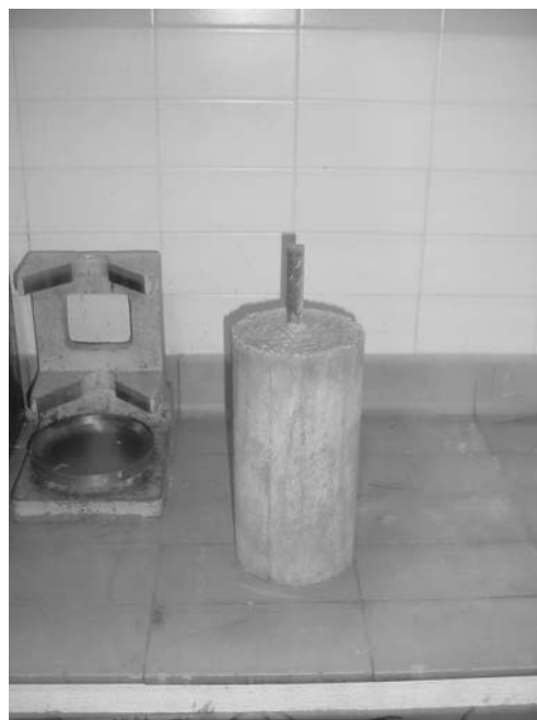
Figura 8.- Probeta mixta acero-hormigón
