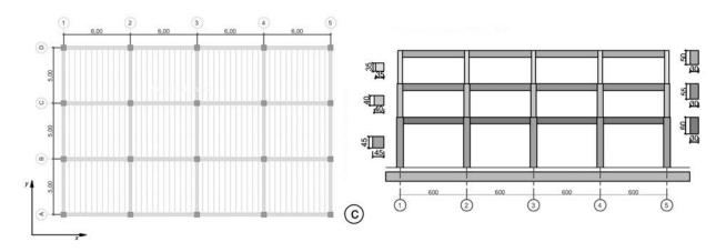
Figura 6 (continuación). Planta típica del edificio con forjados reticulares (igual en todos los niveles).
