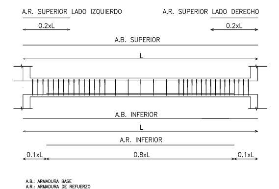
Figura 2. Armadura longitudinal de vigas.
