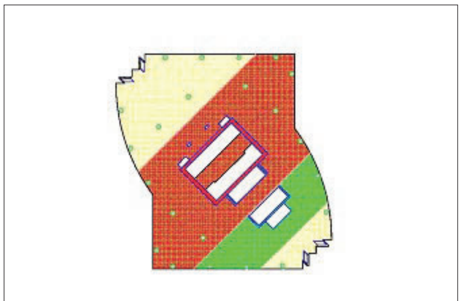
Figura 7. Fase hormigonado zona central, ciclo 2 Torre Espacio. Figure 7. Central area's concreting phase, cycle 2 Torre Espacio.
