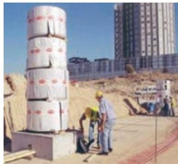
Figura 6. Dispositivos para reducir el rozamiento entre el terreno y la losa de cimentación: colocación de la doble lámina de polietileno (izqda.) y ensayo en verdadera magnitud de su eficacia (dcha.)
