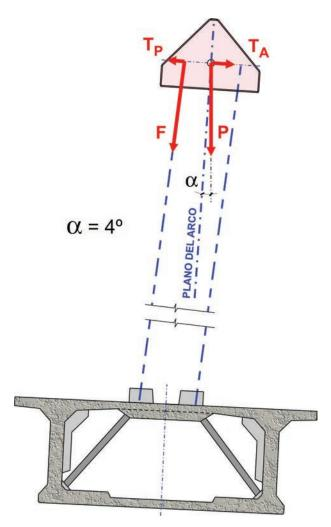
Figura 14. Fuerzas transversales en el arco. Figure 14. Transverse forces in the arch.
