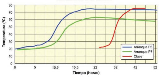
Figura 21. Evolución de las temperaturas del hormigón en arco 2. Figure 21. Variation in concrete temperature in arch 2.
