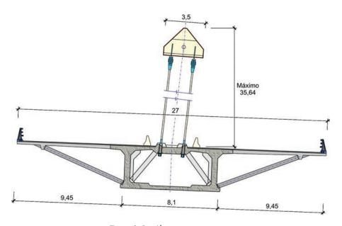
Figura 6. Sección por vanos en arco. Figure 6 Arch span cross-section.
