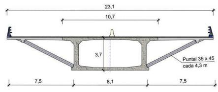
Figura 5. Sección tablero vanos de acceso. Figure 5. Cross-section of deck in approaches.
