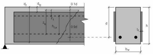
Figura 4. Notación empleada por el modelo de Cheng y Teng para el refuerzo a cortante.
