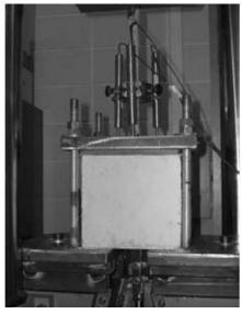
Figura 2. Montaje del ensayo de pull-out.
