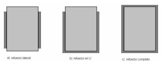
Figura 1. Configuraciones para el refuerzo a cortante.
