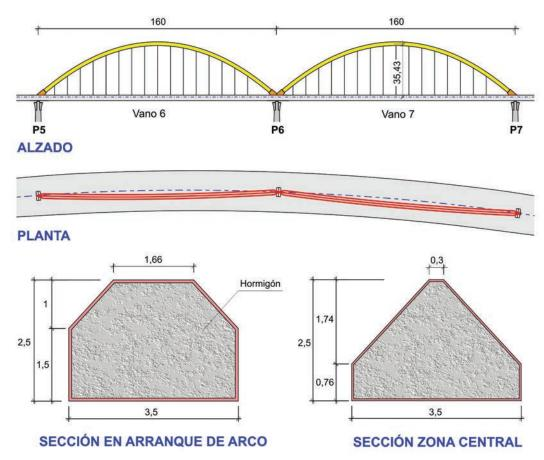
Figura 10. Esquema vanos en arco. Figure 10. Arches.
