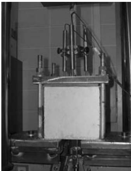
Figura 2. Montaje del ensayo de pull-out.
