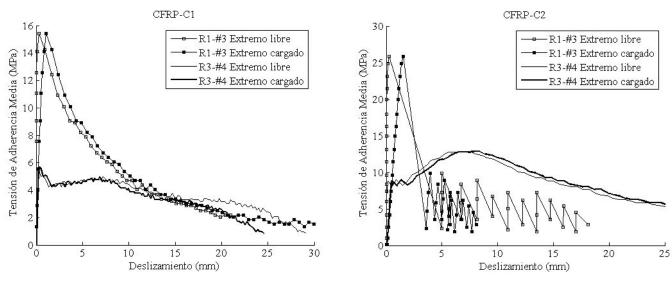
Figura 3. Curvas tensión de adherencia media-deslizamiento para probetas con CFRP y hormigón tipo. a) C1; b) C2.
