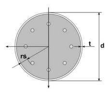
Figura 8. Sección mixta rellena circular.
