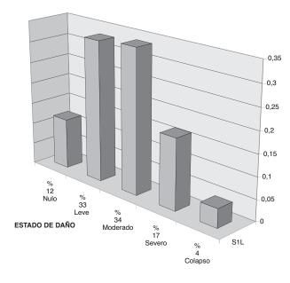
Figura 18. Histograma de probabilidad de daño para Sd = 0.07 m
