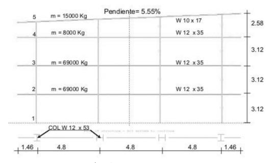
Figura 2. Pórtico de acero resistente a momentos.
