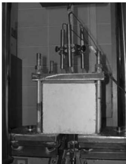
Figura 2. Montaje del ensayo de pull-out.
