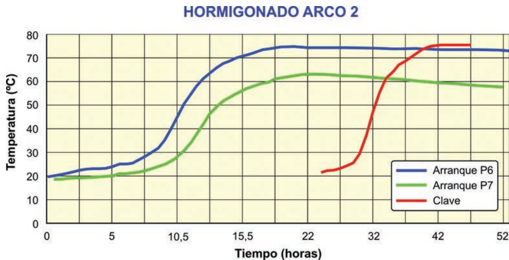
Figura 21. Evolución de las temperaturas del hormigón en arco 2. Figure 21. Variation in concrete temperature in arch 2.
