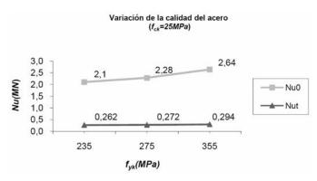
Figura 9. Valores de la carga última axil a temperatura ambiente y a temperatura elevada en función de la calidad del acero estructural.
