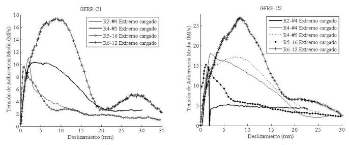
Figura 4. Curvas tensión de adherencia media-deslizamiento para probetas con GFRP y hormigón tipo. a) C1; b) C2.
