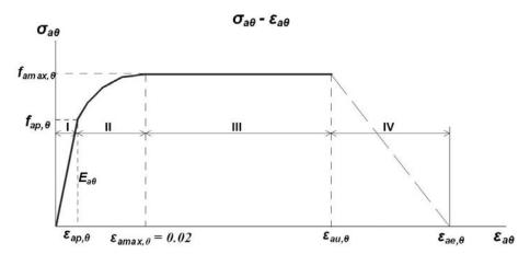
Figura 5. Curva  $\sigma\text{--}\epsilon$  del acero a temperatura elevada.
