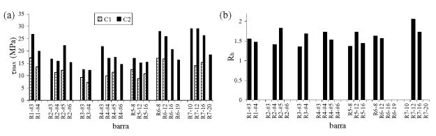
Figura 7. a) Resistencia de adherencia según hormigón C1 o C2; b) Ratio de incremento de la resistencia de adherencia por cambio de hormigón.
