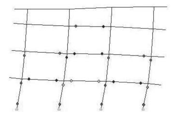
Figura 13. Condición estructural en el umbral del estado de daño de colapso.
