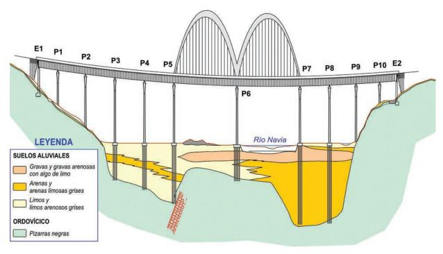
Figura 12. Perfil geotécnico. Figure 12. Geotechnical profile.
