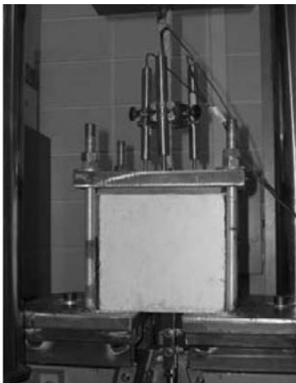
Figura 2. Montaje del ensayo de pull-out.
