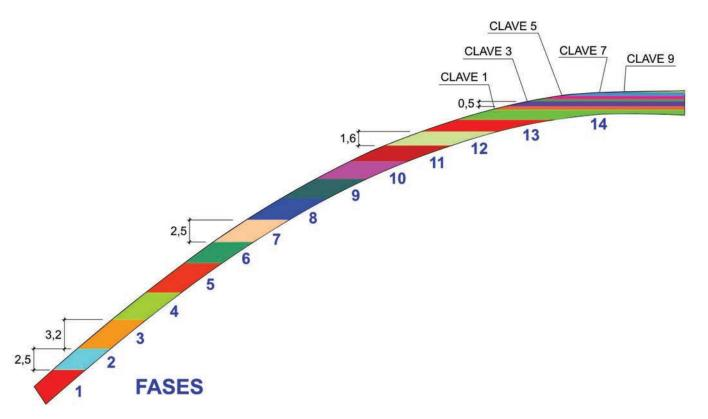
Figura 20. Fases de hormigonado de los arcos. *Figure 20. Arch concreting phases.*
