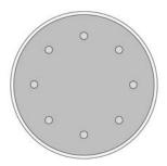
Figura 1. Sección mixta rellena circular.
