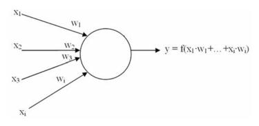
Figura 6. Esquema de funcionamiento de una neurona.
