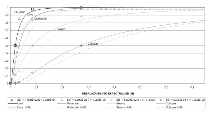
Figura 19. Comparación de las curvas de fragilidad obtenidas para el pórtico de acero arriostrado con las que presenta HAZUS-99
