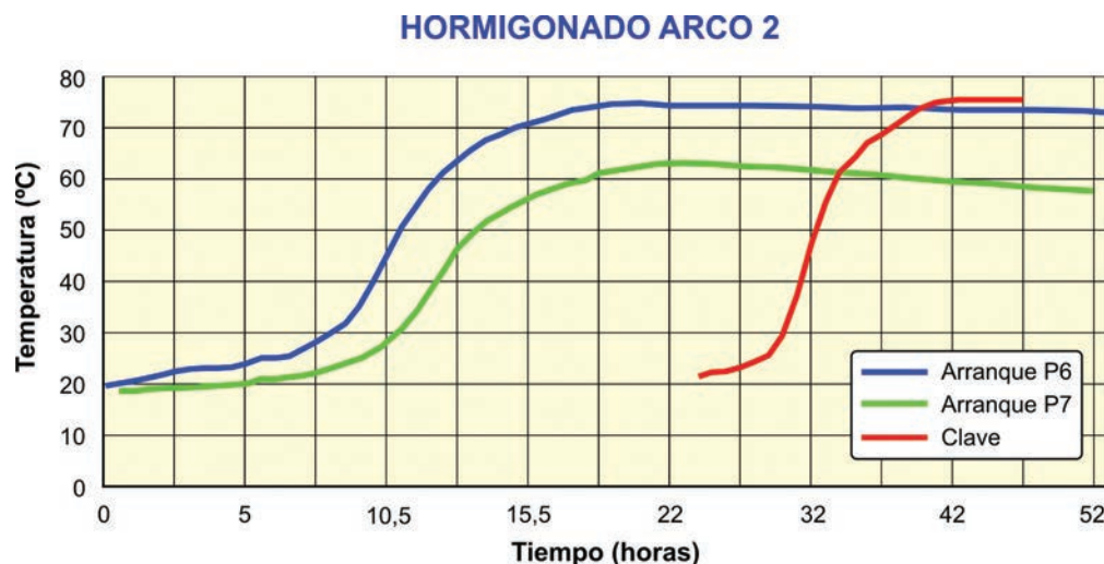
Figura 21. Evolución de las temperaturas del hormigón en arco 2.
