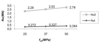
Figura 10. Valores de la carga última axil a temperatura ambiente y a temperatura elevada en función de la calidad del hormigón.
