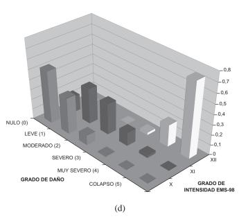
Figura 21. Distribuciones de probabilidad de daño para clase C, D, E y F, de la EMS-98
