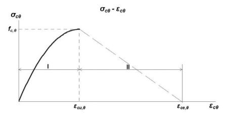
Figura 4. Curva  $\sigma\text{-}\epsilon$  del hormigón a temperatura elevada.
