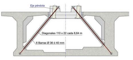
Figura 7 Sección por vanos en arco (detalle) Figure 7. Arch span cross-section (detail).
