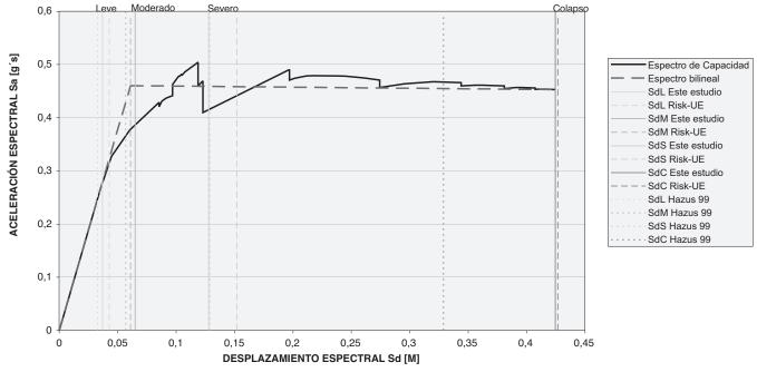
Figura 14. Espectro de capacidad bilineal con umbrales de daño.
