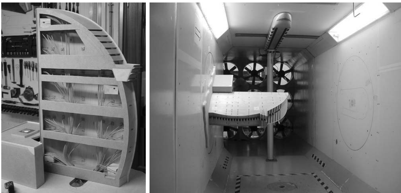
Figuras 21 y 22. Vista interior del cableado para la toma de datos, y vista de la maqueta en el interior del túnel de viento de la E.T.S.I. Aeronáuticos de Madrid (2).
