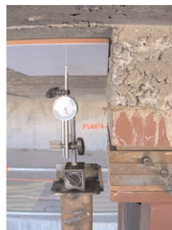
Figura 39. Mecanismo de determinación de la carga en apeos. Micrómetro para determinación de movimientos.
