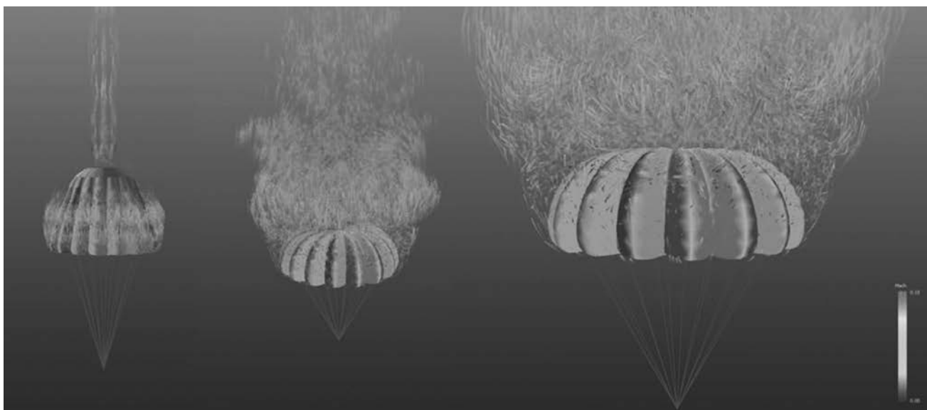
Figura 26. Ejemplo de modelo de ordenador del flujo de aire en torno a un paracaídas. Interacción Fluido-Estructura.
