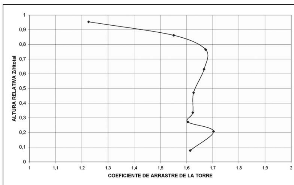
Figura 23. Coeficiente de arrastre de la Torre con viento transversal a la Vela.
