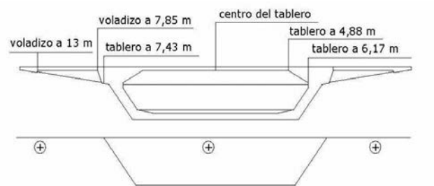
Figura 25. Momentos flectores, obtenidos del MEF, en losa superior y nervios.
