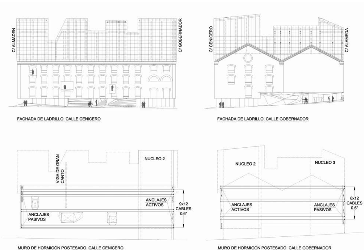
Figura 24. Muro perimetral. Solución con trazado recto horizontal de los cables.
