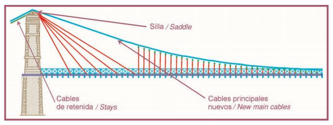
Figura 23. Puente sustentado por el nuevo sistema de cables. Figure 23. Bridge suspended from new cable system.
