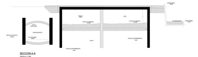
Figura 4. Sección Tipo "9 aÓ Paso paralelo al túnel de metro.
