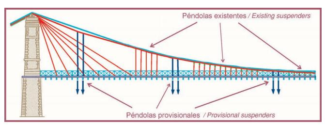
Figura 10. Montaje de péndolas provisionales y primeros escalones de transferencia de carga. Figure 10. Positioning provisional suspenders and initiating load transfer.
