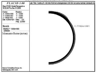
Figura 26. Resultados del análisis mecánico del anillo.
