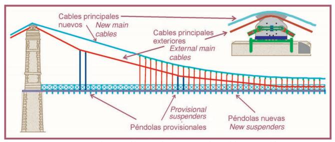
Figura 20. Montaje de nuevos cables principales, montaje y tesado parcial de nuevas péndolas. Figure 20. Mounting new main cables, mounting and partial tensioning of new suspenders.
