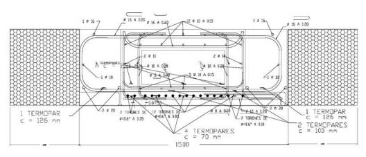
C ES LA DISTANCIA DEL PUNTO DE MEDIDA DE LA TEMPERATURA AL PARAMENTO INFERIOR DE LA PIEZA
