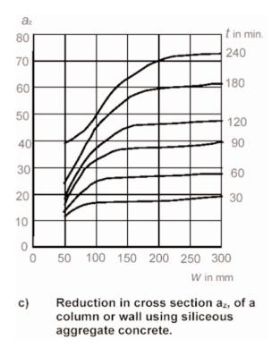
Figura 15. Reducción de sección según EN 1992-1-2 Anejo B.
