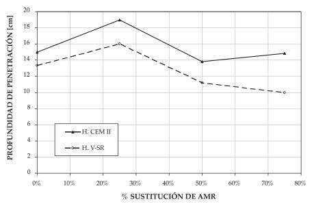
Figura 9. Penetración media de agua bajo presión.
