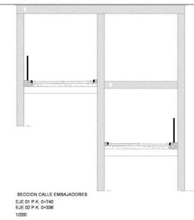
Figura 3. Sección "Tipo 8Ó Calzadas superpuestas y adosadas entre pantallas.
