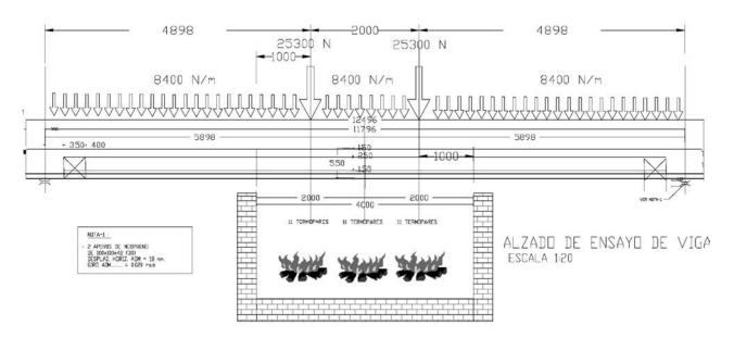
Figura 39. Disposición de los ensayos de las losas de soporte del tráfico.
