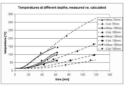
Figura 40. Distribución de temperaturas teóricas y medidas en el ensayo de losa de tráfico.
