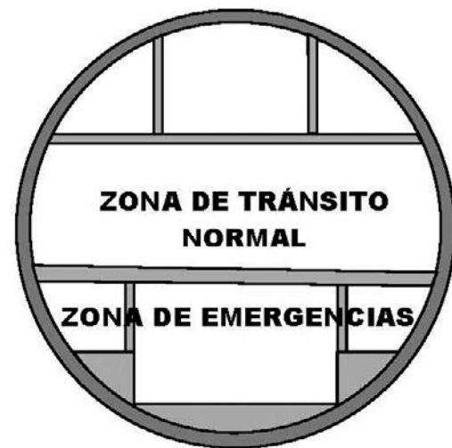
Figura 20. Sectores de fuego en el By-Pass Sur.
