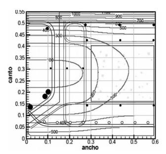
Figura 29. Resultados del análisis térmico de la losa. Isotermas tras 240 minutos de exposición a ISO 834 por cara superior y 120 minutos de exposición a HCM en la inferior. Inicio simultáneo del incendio en ambos sectores.
