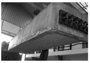
Figura 36. Estado de la cara inferior de la pieza tras el ensayo piloto. No se aprecian signos de *spalling*.
