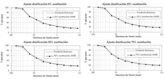
Figura 3. Curvas granulométricas de las diferentes dosificaciones.
