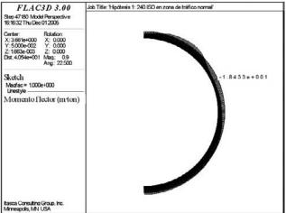
Figura 25. Resultados del análisis mecánico del anillo. Hipótesis 1: tras 240 minutos de fuego ISO 834 en la zona de tránsito normal.
