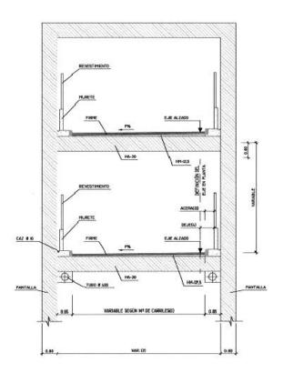
SECCIÓN TIPO RAMPA UNIDIRECCIONAL ENTRE PANTALLAS
