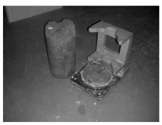
Figura 2. Probeta con 100% de AMR en dosificación, no fue posible el refrentado a 7 días.
