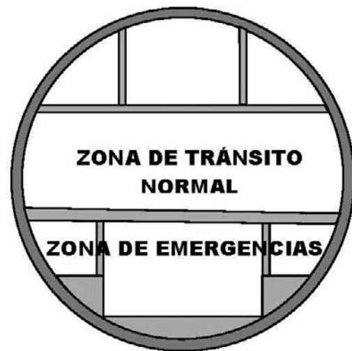
Figura 20. Sectores de fuego en el By-Pass Sur.
