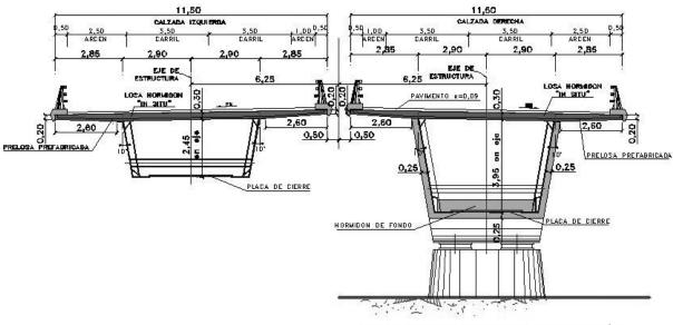
SECCION TRANSVERSAL POR CENTRO DE VANO
