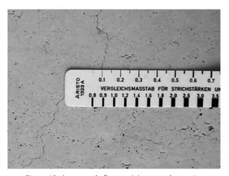
Figura 19. Apertura de fisura máxima pasado un año.
