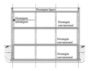
Figura 25. Prototipo de vivienda con hormigón visto con muros de hormigón infraligero.
