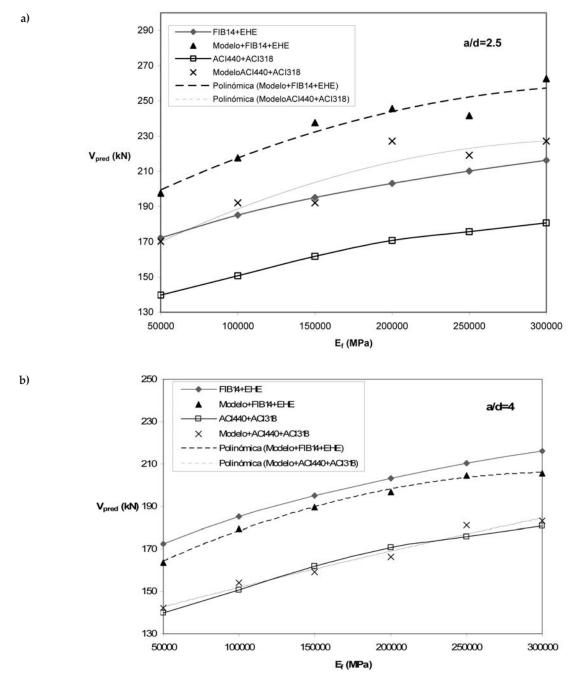
Figura 13. Predicciones de resistencia a cortante en función del módulo de elasticidad del refuerzo externo a) a/d = 2.5 b) a/d = 4
