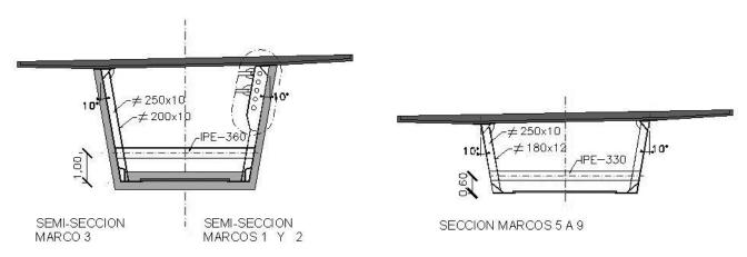
Figura 31. Detalle de marcos transversales en H.
