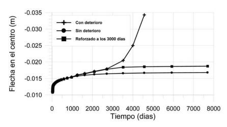
Figura 18. Evolución en el tiempo de la flecha en el centro del puente.
