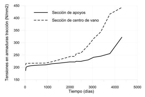
Figura 15. Evolución de la tensión en las armaduras.
