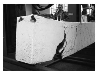
Figura 10. Ensayo con una viga de hormigón infraligero.
