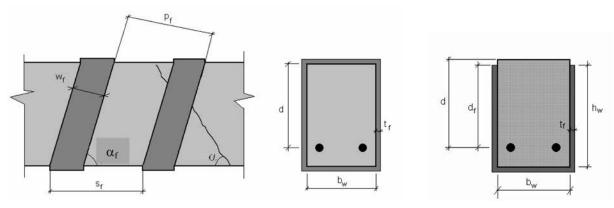
Figura 9. Notación usada para los parámetros de configuración del refuerzo.
