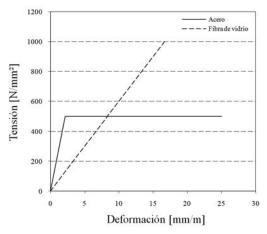
Figura 9. Gráfico comparativo del módulo de elasticidad.
