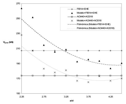
Figura 11. Predicciones de resistencia a cortante para a/d variable.
