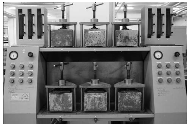
Figura 15. Ensayo de permeabilidad.
