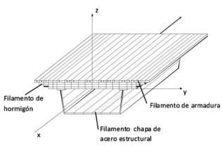
Figura 2. Sección discretizada en fibras.
