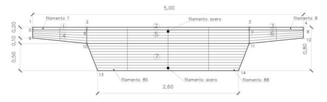
Figura 12. Discretización de la sección transversal de la pasarela.
