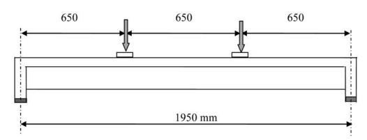
Figura 5. Geometría longitudinal y esquema de carga de las vigas.
