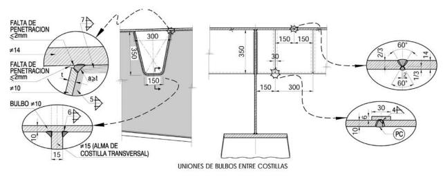
Figure 16. Detalles tipo de chapa ortótropa. Figure 16. Typical details of orthotropic deck.
