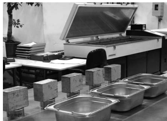
Figura 16. Ensayo de heladicidad.
