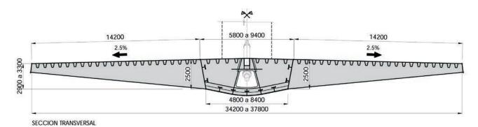
Figura 10. Sección transversal tipo. Figure 10. Typical cross section.
