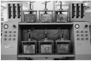
Figura 15. Ensayo de permeabilidad.
