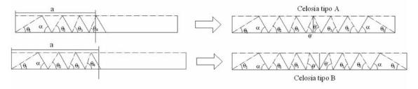
Figura 8. Posibles configuraciones del mecanismo de celosía cuando  $\alpha$ < 90°
