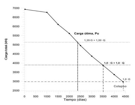
Figura 17. Evolución de la capacidad resistente con el deterioro.
