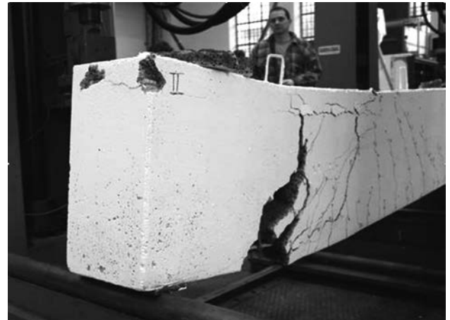
Figura 10. Ensayo con una viga de hormigón infraligero.
