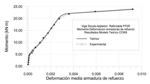
Figura 10. Relación momento - deformación  $\varepsilon_{\rm s}$  en la armadura de refuerzo en la sección central.
