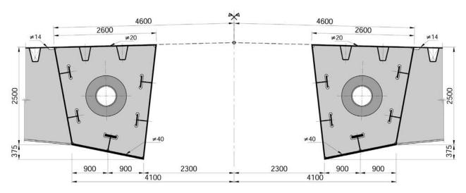
Figura 14. Sección entre pilono y estribo sur. Figure 14. Cross section between the pylon and the South abutment
