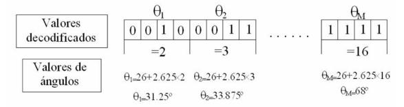
Figura 6. Cromosoma típico para la aplicación del algoritmo genético.
