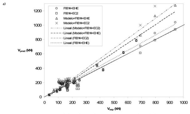
Figura 10 a. Comparación de las predicciones de resistencia a cortante con los resultados experimentales.
