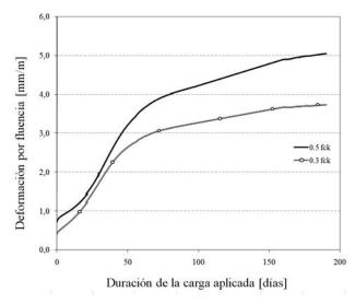
Figura 12. Fluencia del hormigón infraligero.
