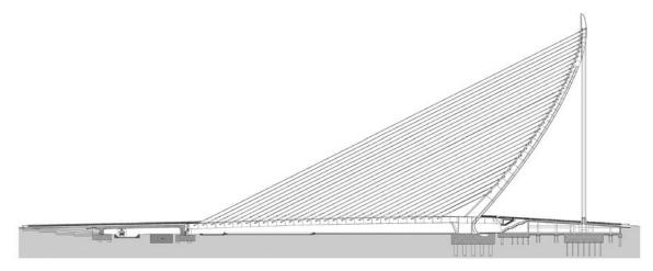
Figure 2. Alzado de puente, vanos de acceso y cimentaciones. Figure 2. Front view of the bridge, approach spans and foundations.
