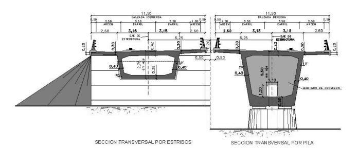
Figura 6. Secciones tipo por zona de hormigón.
