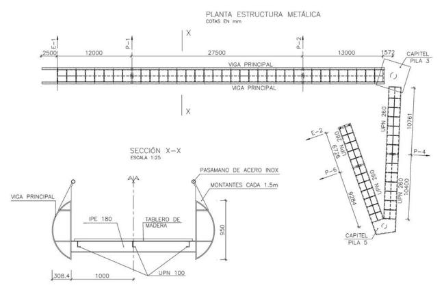
Figura 3. Pasarela del Gat Cendrer. Planta de la estructura y sección transversal de la pasarela.
