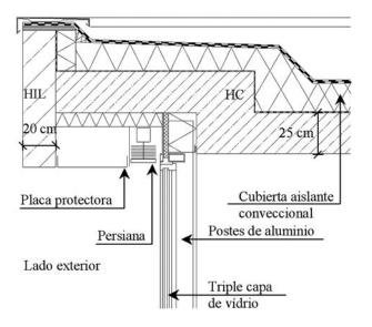
Figura 22. Conexión cubierta-voladizo.
