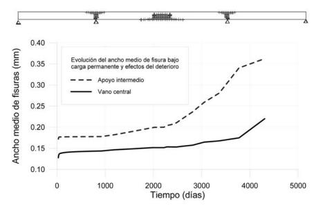
Figura 16. Evolución del ancho medio de fisura en las secciones críticas con el paso del tiempo.
