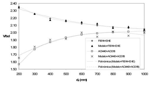
Figura 15. Predicciones de resistencia a cortante en función de la altura del refuerzo externo.
