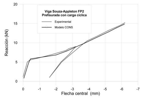
Figura 7. Curva carga-desplazamiento durante el proceso de precarga.
