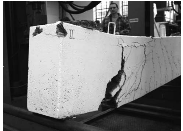
Figura 10. Ensayo con una viga de hormigón infraligero.
