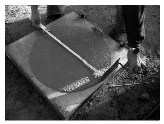
Figura 17. Ensayo de escurrimiento.
