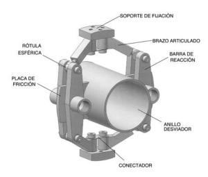
Figura 33. Croquis de amortiguador. Figure 33. Sketch of damper.
