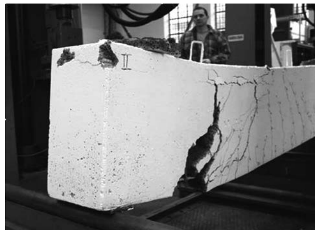
Figura 10. Ensayo con una viga de hormigón infraligero.
