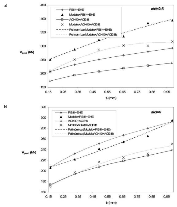
Figura 12. Predicciones de resistencia a cortante en función del espesor del refuerzo externo: a) a/d = 2,5 b) a/d = 4
