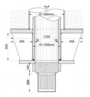
Figura 30. Anclaje retenida. Figure 30. Back stay anchorage.
