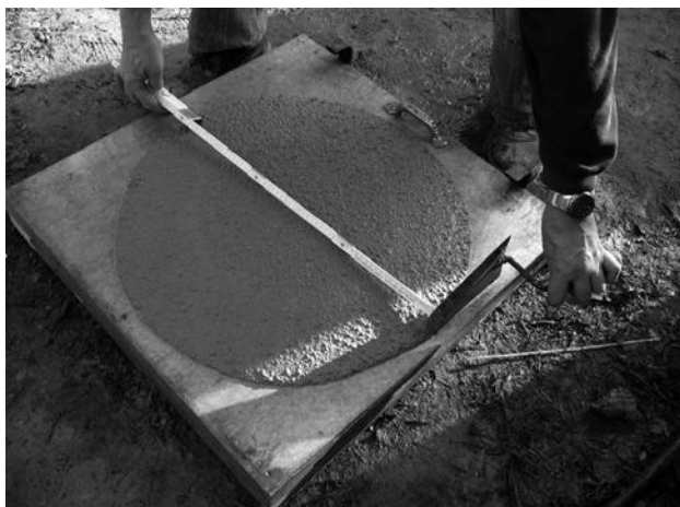
Figura 17. Ensayo de escurrimiento.
