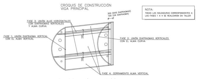
Figura 8. Esquema de construcción de las vigas en cajón.
