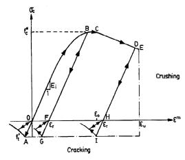
Figura 3. Curva  $\sigma$ - $\epsilon$  del hormigón.
