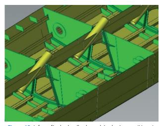
Figura 13. Infografía de detalle de anclaje de tirantes (Horta).
