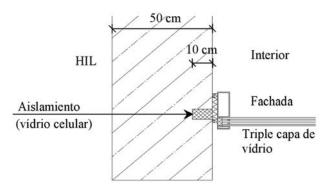
Figura 21. Unión muro-fachada (sección transversal en planta).
