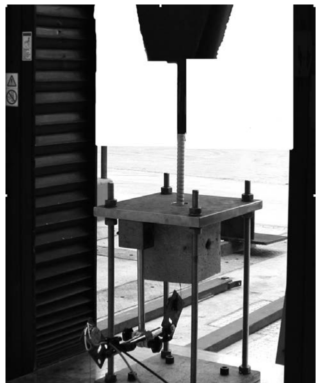
Figura 6. Ensayo de adherencia.
