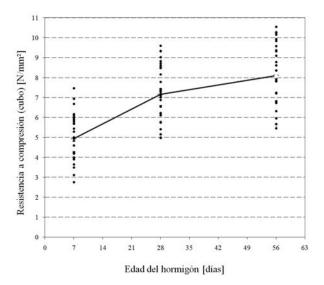
Figura 4. Resistencia a compresión del hormigón infraligero en función de la edad de la mezcla.
