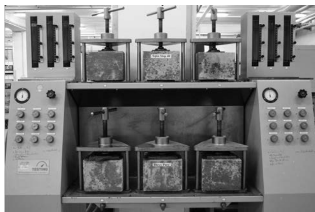
Figura 15. Ensayo de permeabilidad.
