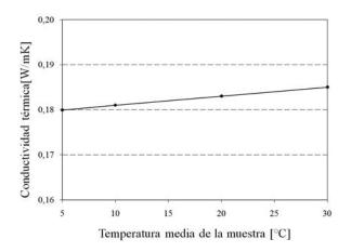
Figura 13. Conductividad térmica del hormigón infraligero.
