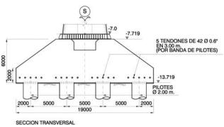
Figura 7. Cimentación de pilono. Sección transversal Figure 7. Foundation of the pylon, Transversal section
