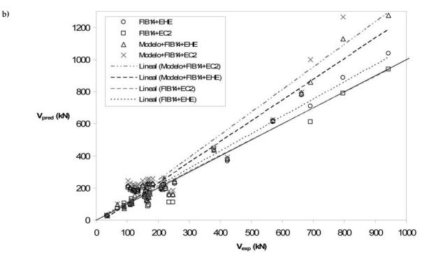
Figura 10 b. Comparación de las predicciones de resistencia a cortante con los resultados experimentales.
