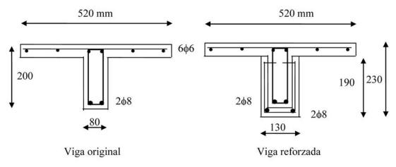
Figura 6. Sección transversal y armadura de la viga original y reforzada.
