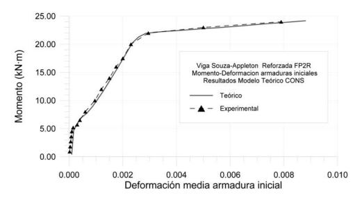
Figura 9. Relación momento - deformación  $\varepsilon_c$  en la armadura inicial en la sección central.
