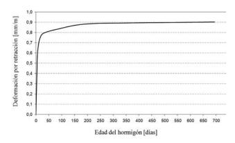
Figura 11. Retracción del hormigón infraligero.
