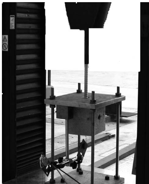
Figura 6. Ensayo de adherencia.
