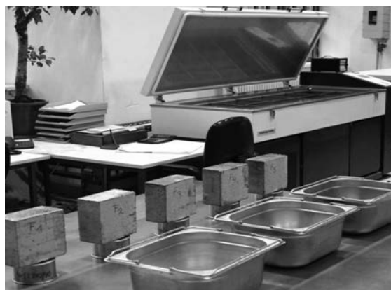
Figura 16. Ensayo de heladicidad.
