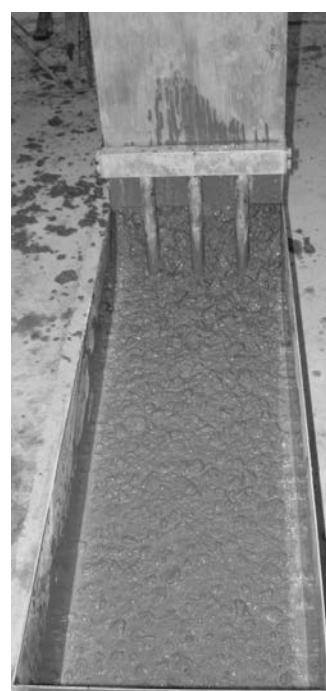
Figura 2. Resultado final del ensayo de la caja en L
