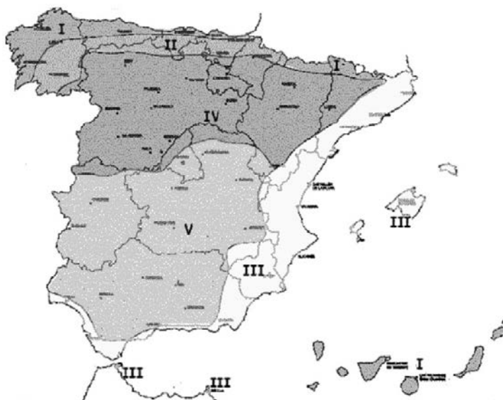
Figura 10. Tabla nº 7 de la IAP de determinación de las diferentes zonas climáticas (z) para obtener la carrera de temperaturas medias
