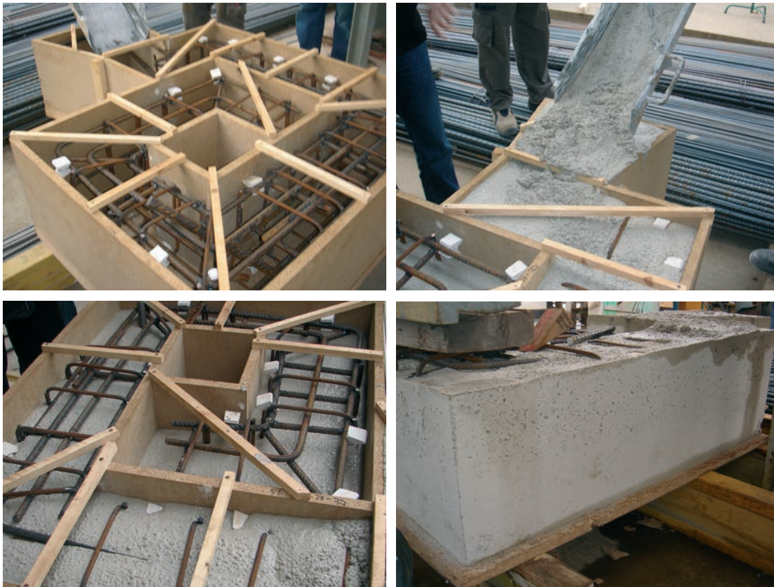
Figura 18. Estructura para la primera prueba del HAC realizada el 20 de febrero del 2009. Fuente propia Figure 18. Mould for the first SCC test conducted on 20 February 2009. Source: authors
