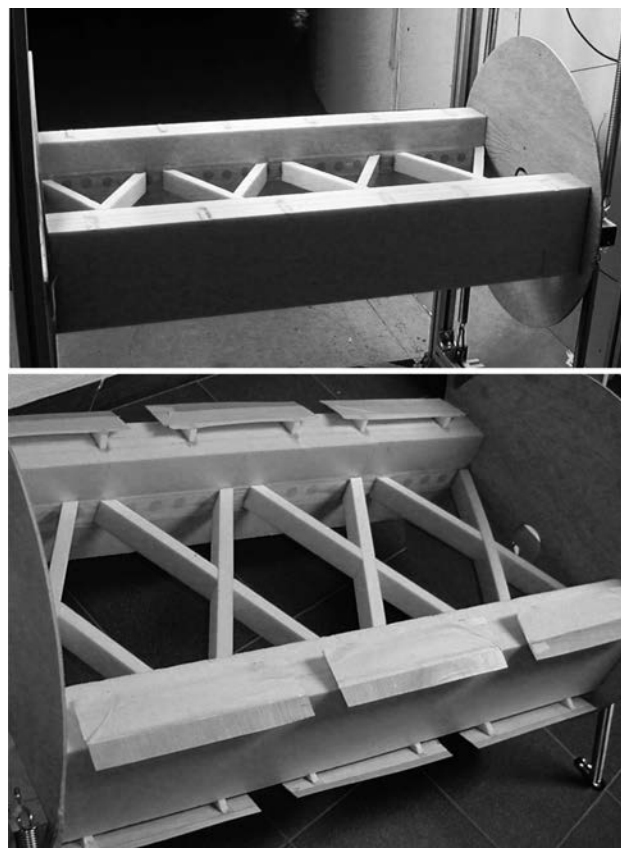
Figura 3. Vistas del modelo de ensayos dinámicos del arco del puente Arcos de Alconétar, sin deflectores, y con deflectores; de IDR/UPM
