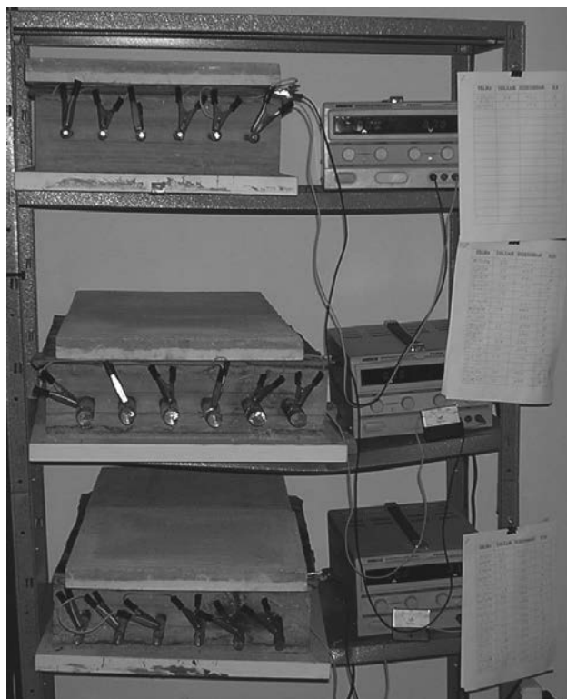
Figura 10. Vista general del ensayo de corrosión acelerada
