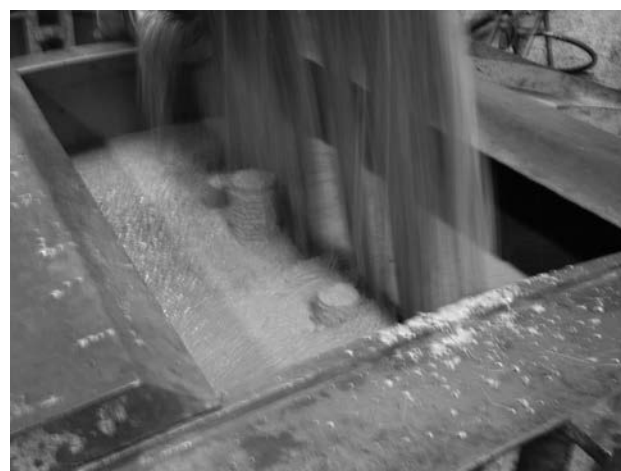
Figura 11. Lámina de caída del HAC con fibras
