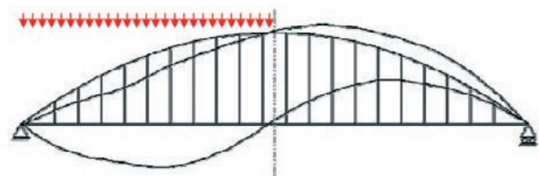
Figura 6. Leyes de momentos flectores en un bowstring con péndolas verticales sometido a sobrecargas asimétricas Figure 6. Bending moment distribution in a bowstring with vertical hangers and non-symmetric live loads
