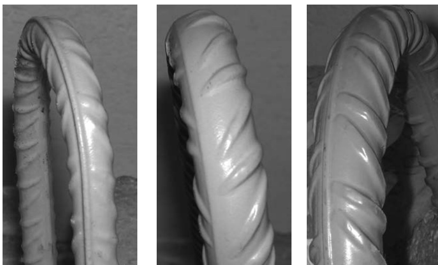
Figura 6. Barras de los tres diámetros tras el ensayo de doblado a 180^\circ . No se aprecian daños en el revestimiento de resina epoxi
