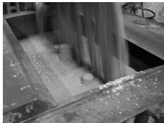
Figura 11. Lámina de caída del HAC con fibras
