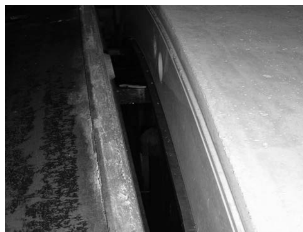
Figura 18. Acabado superficial de la cara lateral de la dovela de la dosificación 1
