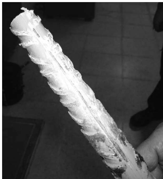
Figura 19. Estado superficial de una barra revestida de resina después del ensayo de arrancamiento
