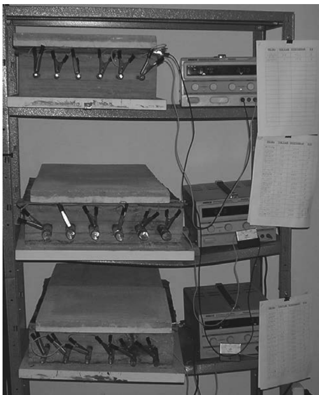
Figura 10. Vista general del ensayo de corrosión acelerada
