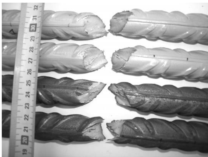
Figura 4. Barras tras el ensayo de tracción
