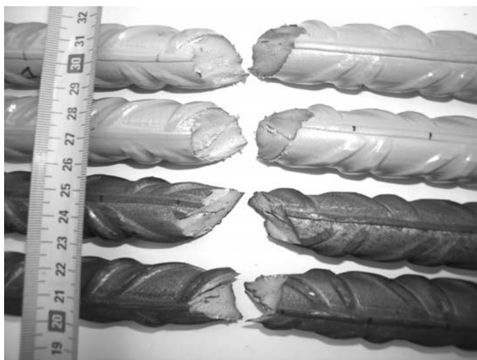
Figura 4. Barras tras el ensayo de tracción
