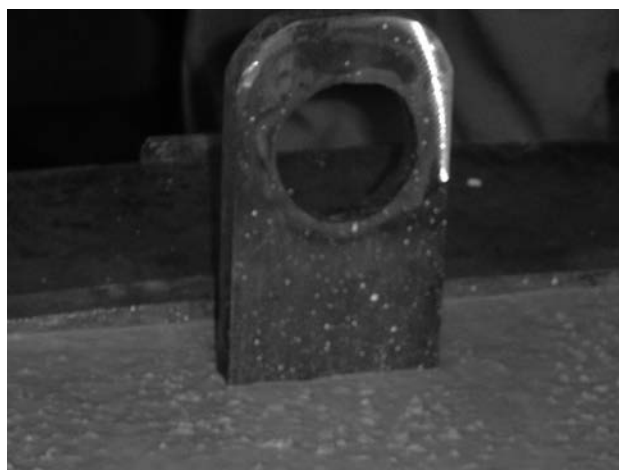
Figura 4. Detalle de reducción de espesor
