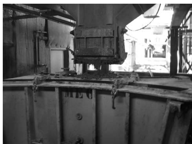
Figura 5. Detalle del hormigonado con molde vertical
