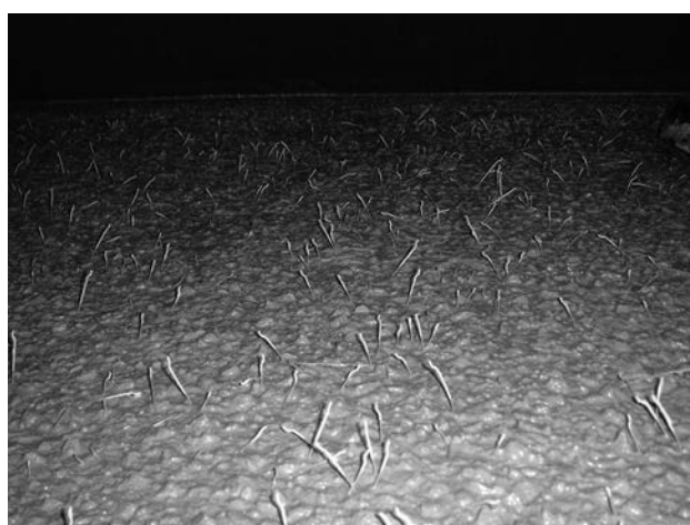
Figura 12. Distribución de las fibras en el hormigón en el interior del molde
