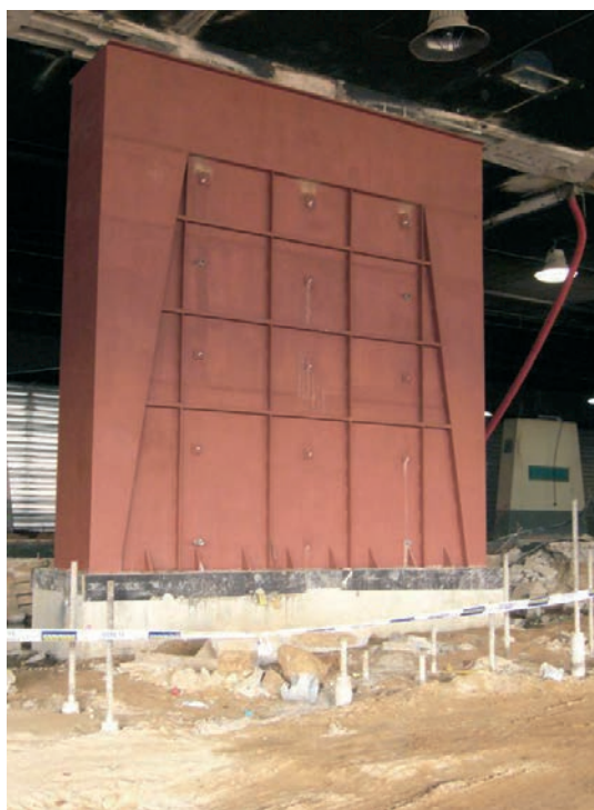
Figuras 13 y 14. Refuerzo de pilares
