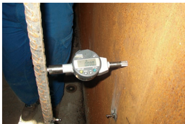
Figura 17. Control de deformaciones transversales en el alma
