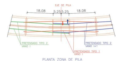
Figura 18. Planta asimétrica del pretensado exterior longitudinal
