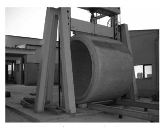
Figura 1. Ensayo de tres aristas o de aplastamiento. Cortesía de PREFRAGA.
