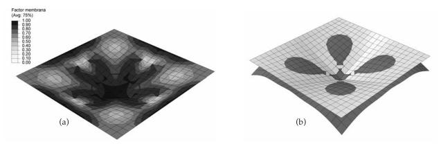
Figura 9. Forma A: (a) Factor de membrana; (b) Deformada, Blanco=Sin deformar, Gris=Deformada (x200)
