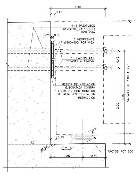
Figura 8. Estribo fijo de tablero de vigas prefabricadas continuas. Detalle de anclaje
