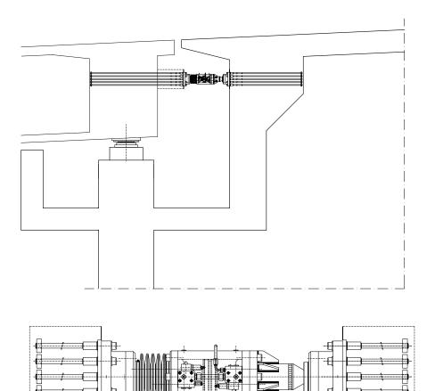
Figura 16. Amortiguador sísmico
