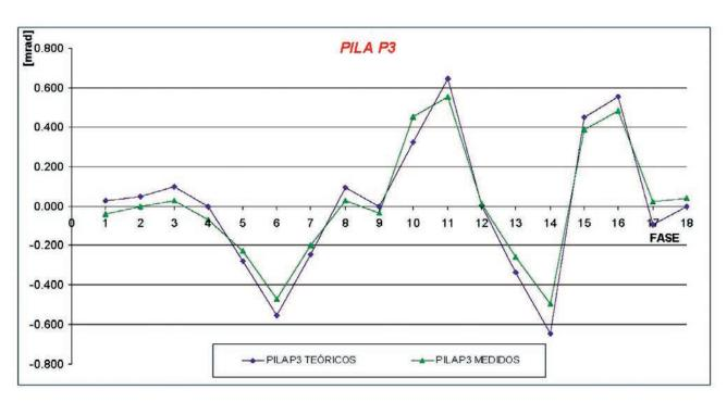
Figura 43. Giros medidos y calculados en la pila P3 durante la prueba de carga Figure 43. Measured and calculated rotations of the top of the pier P3 on the load test
