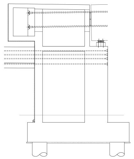
Figura 12. Parque de fabricación de puente empujado. Detalle de anclaje entre parque y estribo
