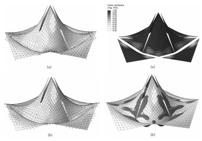
Figura 22. Direcciones principales de tensiones en la cubierta de Ntra. Sra. de Guadalupe: (a) Compresiones; (b) Tracciones
