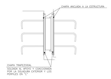
Figura 6. Apoyo lateral extraíble
