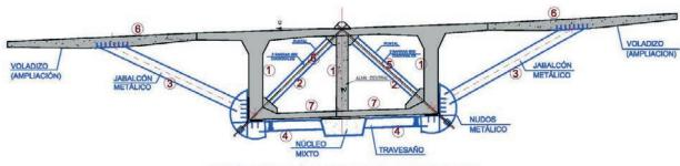
INSTRUMENTACIÓN TRANSVERSAL DEL TABLERO
