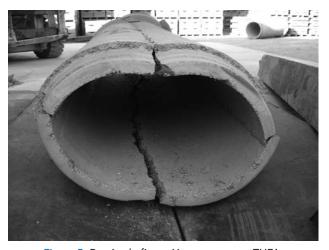
Figura 5. Patrón de fisuración en rotura en THFA. Cortesía de PREFRAGA
