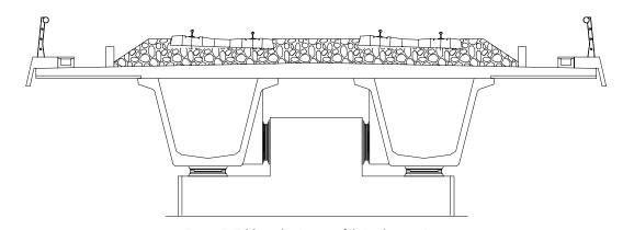
Figura 5. Tablero de vigas prefabricadas continuas
