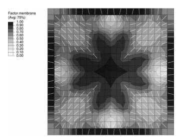
Figura 28. Factor de membrana en la Forma A considerando fisuración (f<sub>ct</sub>=1,0 MPa) y orientación de las fisuras
