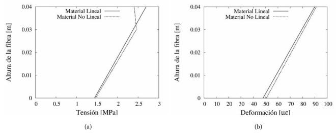
Figura 27. Sección fisurada de la forma A con material lineal y no lineal: (a) Tensiones; (b) Deformaciones
