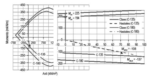
Figura 12. Diagramas axil-momento últimos y trayectorias obtenidas para las secciones en clave y riñones en la simulación del EA para el tubo 2,80 m C-135 y C-180
