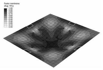
Figura 25. Factor de membrana en la Forma A considerando fisuración (f<sub>ct</sub>=2,5 MPa)
