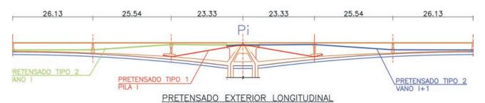
Figura 15. Pretensado exterior longitudinal. Alzado, familias tipo 1 y 2. Figure 15. External longitudianl prestressing. Front view of tendons type 1 and 2
