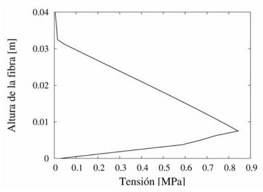
Figura 29. Distribución de tensiones en una fisura totalmente desarrollada en la forma A (f<sub>ct</sub>=1,0 MPa)
