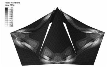
Figura 26. Factor de membrana en la Iglesia de Guadalupe considerando fisuración (f<sub>ct</sub>=2,5 MPa)
