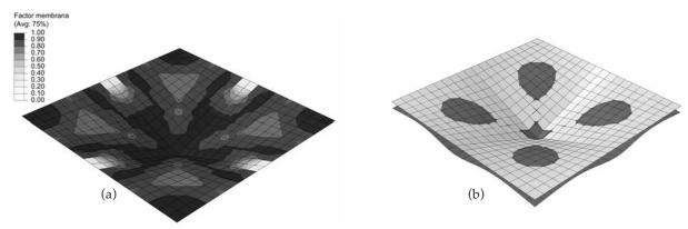
Figura 10. Forma A con los bordes fijos en su dirección: (a) Factor de membrana; (b) Deformada, Blanco=Sin deformar, Gris=Deformada (x200)
