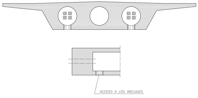
Figura 15. Estribo fijo de tablero tipo losa pretensada. Cajetín de acceso a anclajes
