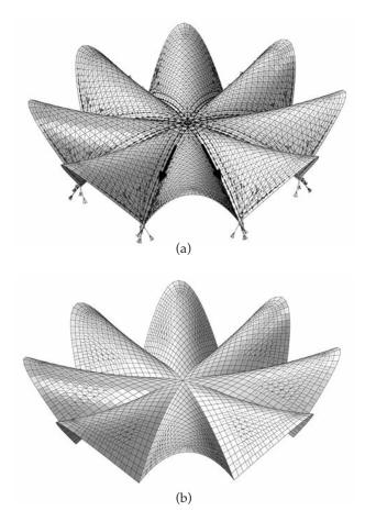
Figura 17. Direcciones principales de tensiones en la cubierta de Los Manantiales: (a) Compresiones; (b) Tracciones
