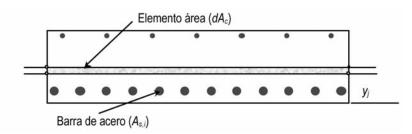
Figura 8. Ejemplo de discretización de una sección de tubería
