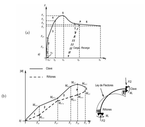
Figura 4. Diagramas cualitativos: a) Carga-desplazamiento en clave y b) Momento-carga para una tubería con capacidad de redistribución plástica completa.
