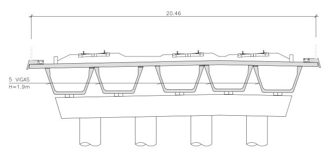
Figura 2. Puente de vigas isostáticas. Sección
