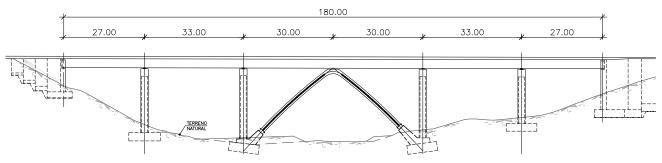
Figura 17. Puente con conexión a punto fijo intermedio. Alzado
