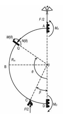
Figura 9. Esquema estático considerado por el modelo ATH
