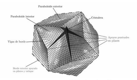
Figura 20. Descripción estructural de la cubierta de Guadalupe
