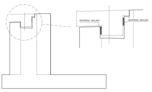
Figura 13. Estribo fijo de tablero tipo losa pretensada. Sección y detalle de anclaje
