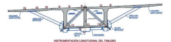
Figura 42. Instrumentación dispuesta en el tablero (los números indican la designación de cada banda extensométrica)
