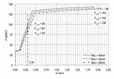
Figura 13. Curva F – w para el tubo D<sub>n</sub> 2.800 mm C-135 según el recubrimiento nominal
