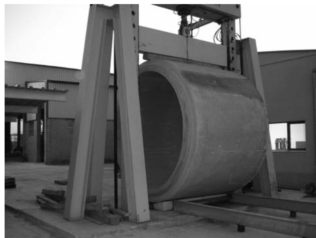
Figura 1. Ensayo de tres aristas o de aplastamiento. Cortesía de PREFRAGA.
