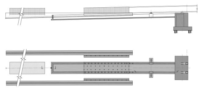
Figura 11. Parque de fabricación de puente empujado. Planta y alzado
