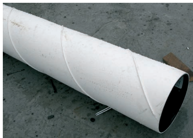
Figura 29. Vaina exterior de los tirantes Figure 29. External sheath of the cables
