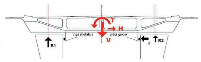
Figura 12. Esquema del diafragma extremo sobre pila P1 Figure 12. End diaphragm on pier P-1 Load diagram
