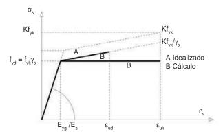
Figura 3. Ley de tensión-deformación del acero
