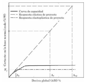
Figura 4. Curva de capacidad, respuesta elástica y elastoplástica
