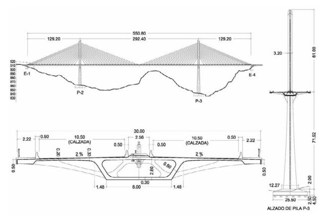
Figura 1. Puente atirantado de Bucaramanga (Colombia), luces 129,20 + 292,40 + 129,20 = 550,80 m
