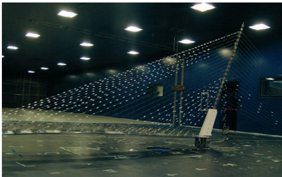
Figura 32. Maqueta para el modelo de túnel de viento en el Politécnico de Milán
