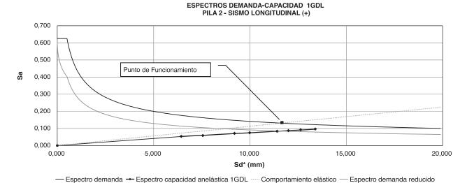
Figura 14. Curvas de capacidad y demanda en la pila 2 para sismo longitudinal positivo.
