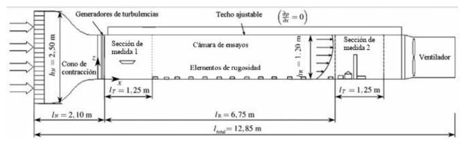
Figura 1. Esquema del túnel de capa límite
