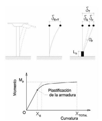
Figura 8. Ductilidad en desplazamientos en las pilas de una
