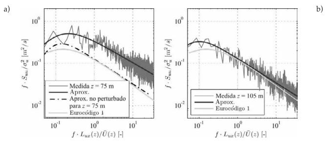
Figura 7. Espectros medidos del viento para z = 75 m (a) y z = 105 m ( $\theta = 0^{\circ}$ ) (b)
