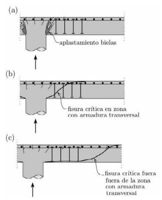
Figura 5. Modos de rotura en losas con armadura transversal:
