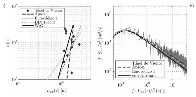
Figura 4. Escala integral de longitud (a) y espectro del viento (b)
