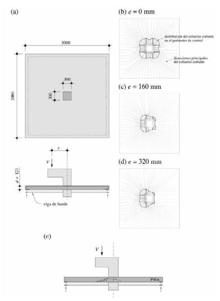
Figura 11. Transferencia de momento entre losa y columna: (a) geometría y cargas de los ensayos de Krüger [49] (cotas en [mm]); (b-d) campos de cortante para diferentes excentricidades de la carga (0, 160 mm and 320 mm respectivamente); y (e) sección del elemento P30A (excentricidad igual a 320 mm) tras la ruptura de punzonamiento
