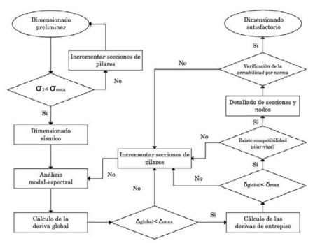
Figura 2. Flujograma del procedimiento de dimensionado sísmico
