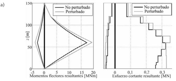
Figura 8. Momentos flectores (a) y fuerzas laterales resultantes (b) obtenidos de la simulación ( $\theta$  = 30°)
