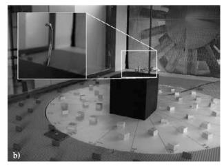
Figura 2. Elementos de rugosidad en la cámara de ensayos (a) y sonda de medida TFI Cobra (b)
