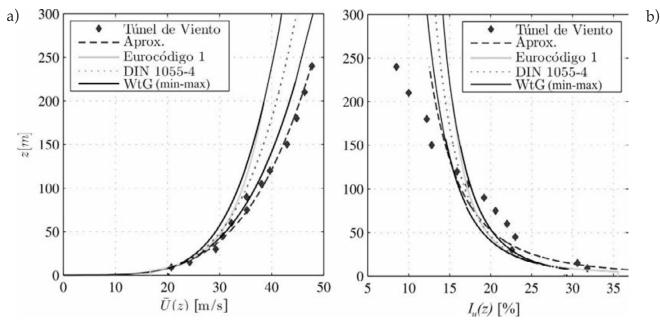
Figura 3. Perfiles de velocidad media (a) y de intensidad de turbulencia (b)
