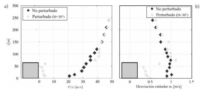
Figura 6. Perfiles de velocidad (a) y de desviación estándar (b) medidas con la intrusión del edificio ( $\theta$  = 30°)
