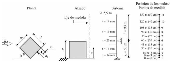
Figura 5. Definición de  $\theta$ , posición de la sonda TFI Cobra y modelo en Elementos Finitos: sistema y nodos
