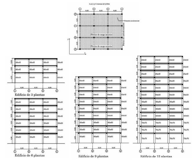
Figura 5. Vista en planta y alzados de los edificios estudiados
