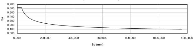
Figura 11. Espectro de aceleraciones y diagrama de demanda de desplazamiento asociado a un sistema (MGDL)
