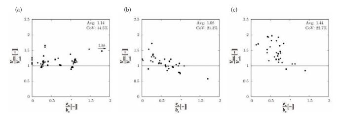
Figura 13. Comparación del EC-2 con ensayos sobre columnas: (a) interiores; (b) de borde y (c) de esquina (series experimentales según [38])
