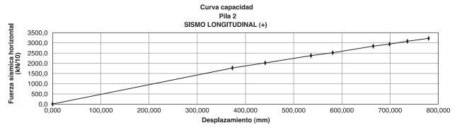
Figura 13. Curva de fuerza incremental-desplazamiento en pila 2 para sismo longitudinal positivo
