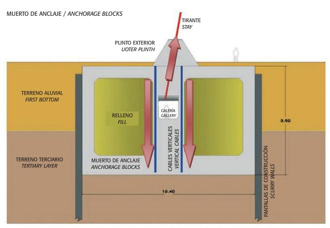
Figura 29. Sección transversal de muerto de anclaje Figure 29. Anchorage block cross-section
