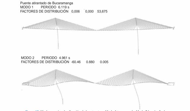
Figura 10. Modos propios de vibración de la estructura: Modo 1 transversal y Modo 2 longitudinal
