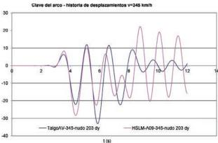
Figura 12. Resultados del cálculo dinámico en la clave del arco Figure 12. Results of the dynamic analysis at the arch key
