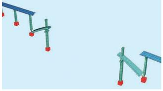
Tramo de arco tras retirada de la cimbra porticada Arch segment after the dismantling of frame centering
