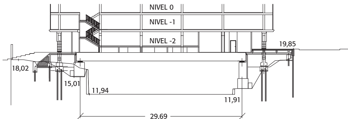
Figura 22. Sección por la viga 21, losa 1 al lado del Pont-Neuf (Av. Charles de Gaulle)
