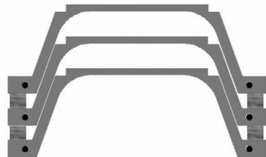
Figura 9. Sistema de apilado de los elementos primarios
