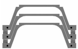
Figura 9. Sistema de apilado de los elementos primarios
