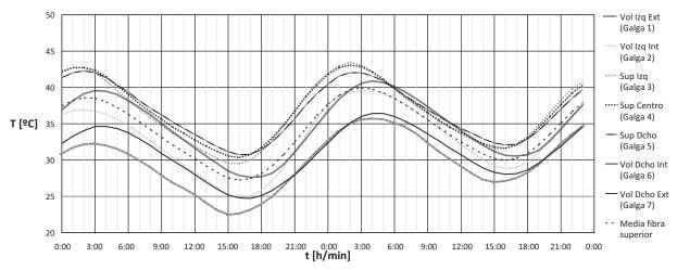
Figura 11. Comparación entre los valores de temperaturas para los sensores de la fibra superior, sensores del 1 al 7, y su valor medio, para dos días de verano, el 16 y 17 de Julio del 2009
