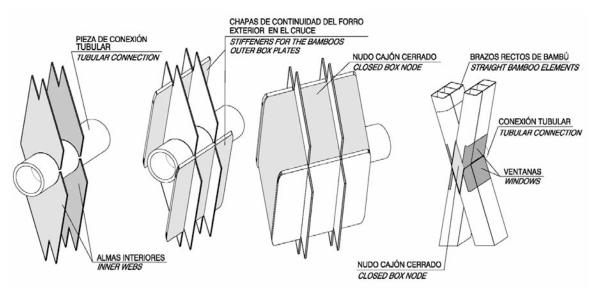
Figura 27. Secuencia constructiva nudo de cruce de bambúes Figure 27. Construction process of a bamboo cross intersection node
