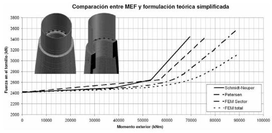
Figura 16. Comparación de resultados. Fuerza en los elementos de pretensado de unión acero-hormigón en torre híbrida
