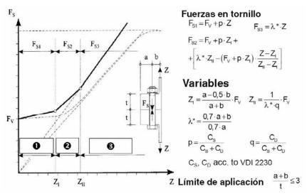
Figura 14. Formulación de [15]. Figura tomada de [5]
