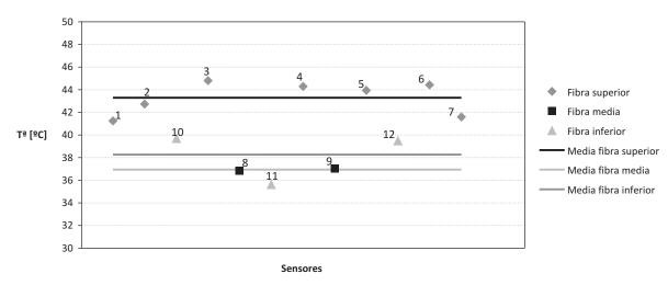
Figura 9. Valores de temperatura en los sensores de la sección 5 para el día más caluroso. 23/08/2009 a las 19:00
