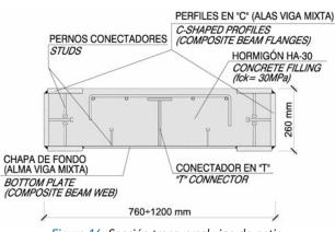
Figura 16. Sección transversal viga de patio Figure 16. Cross section of patio beam
