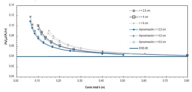
Figura 6.  $(A_s f_{vd})/(A_c f_{cd})$  en función del canto h, incluyendo el efecto escala y considerando diversos recubrimientos
