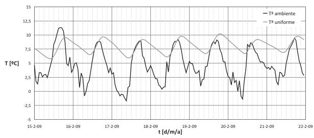
Figura 17. Comparación de la evolución de la temperatura uniforme del tablero y la del ambiente durante una semana de invierno del 15 al 21 de febrero del 2009
