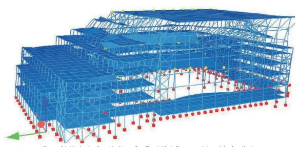
Figura 24. Modo de vibración Norte-Sur (T = 1,10 s). Esquema del modelo de cálculo
