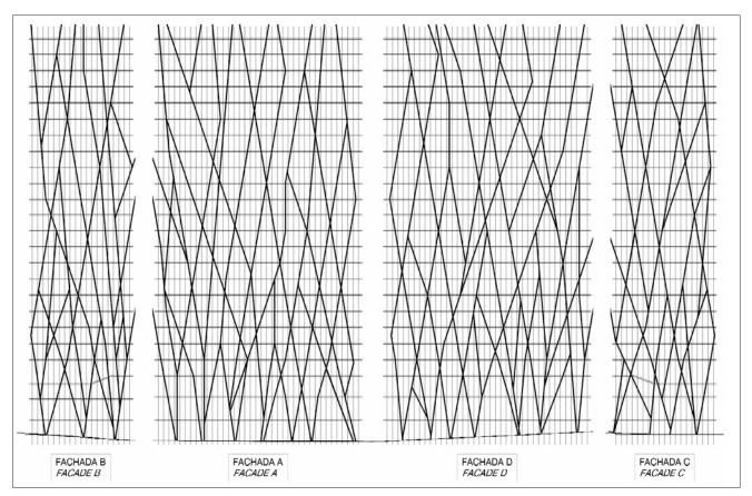
Figure 21. Capa exterior fachada (bambúes)
