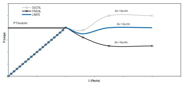
Figura 1. Transición frágil - dúctil en viga armada en función de la cuantía
