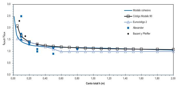
Figura 2. Efecto escala en la resistencia a flexotracción
