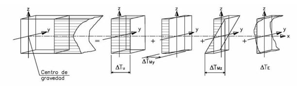
Figura 4. Modelo de representacion de la accion termica en puentes, propuesto por el Eurocódigo 1 [10]
