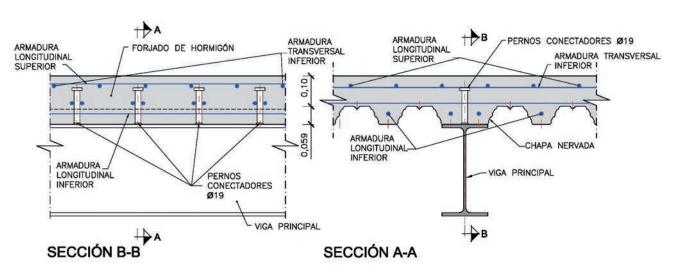
Figura 5. Esquema de forjados mixtos y detalle de viga principal mixta conectada al forjado
