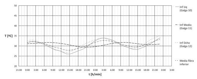
Figura 13. Comparación entre los valores de temperaturas para los sensores de la fibra inferior, sensores del 10 al 12, y su valor medio, para dos días de verano, el 16 y 17 de Julio del 2009
