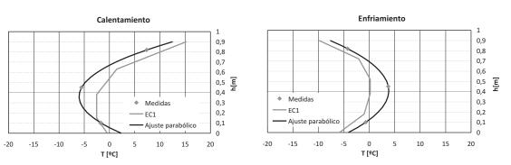
Figura 27. Comparación entre el gradiente no lineal del Eurocódigo 1 [10] con los valores medios de las fibras instrumentadas y con el ajuste parabólico estimado según el apartado 4.1
