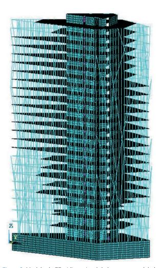
Figura 9. Modelo de EF tridimensional de la estructura global Figure 9. 3D FEM model of the global structure
