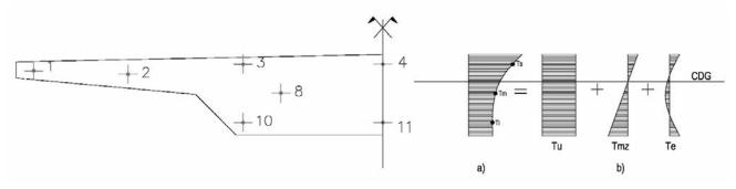
Figura 6. a) Temperatura media de las fibras superior, Ts, media, Tm, e inferior, Ti, obtenida a partir de los resultados experimentales, y el ajuste parabólico supuesto. b) Modelo de temperatura uniforme, gradiente lineal y no lineal representativo de las medidas experimentales, de acuerdo con el modelo propuesto por el Eurocódigo 1 [10] para representar la acción térmica en puentes.
