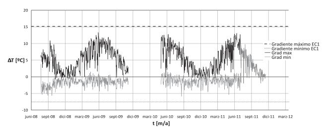
Figura 21. Variación del gradiente lineal de temperatura en el tablero, máximo y mínimo, con el tiempo
