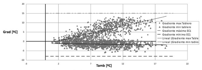
Figura 25. Relación entre el gradiente lineal y la variación diaria de temperatura ambiente
