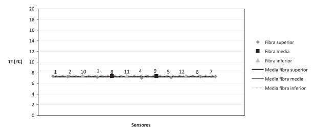
Figura 7. Valores de temperatura en los sensores de la sección 5 para el día más frio. 01/01/2009 a las 10:00
