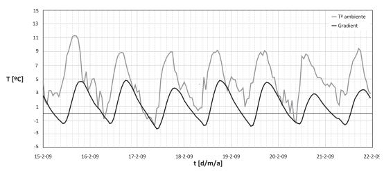
Figura 24. Comparación del gradiente del tablero con la temperatura ambiente durante una semana de invierno
