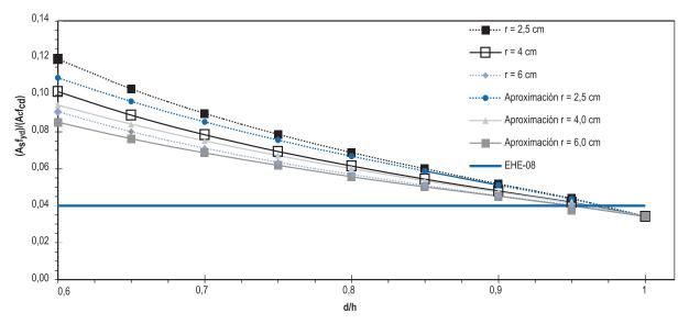
Figura 5. (A<sub>s</sub>f<sub>vd</sub>)/(A<sub>c</sub>f<sub>cc</sub>) en función de d/h, incluyendo el efecto escala y considerando diversos recubrimientos
