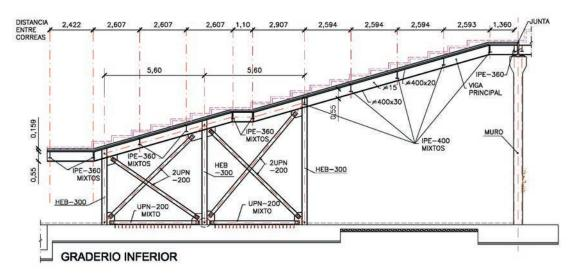
Figura 33. Arriostramientos sismorresistentes del graderío inferior
