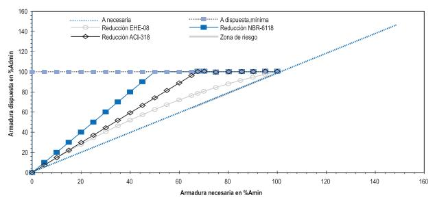
Figura 13. Reducción de la armadura mínima exigida en función de la armadura necesaria por cálculo
