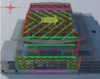
Figuras 17 y 18. Esquema resistente frente al sismo de la cubierta y pórticos de arriostramiento, en la dirección Este-Oeste (Figura 17) y en la dirección Norte-Sur (Figura 18)
