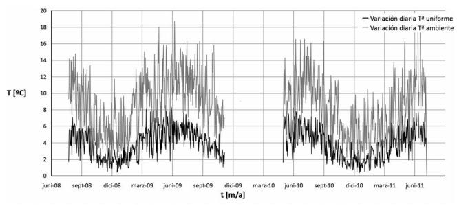
Figura 20. Variación diaria de la temperatura ambiente y de temperatura uniforme en el tablero
