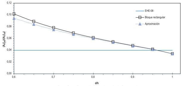
Figura 4.  $(A_s f_{vd})/(A_c f_{cd})$  en función de d/h, incluyendo el efecto escala
