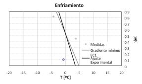
Figura 22. Comparación entre gradiente lineal del Eurocódigo 1 [10] con valores estimados a partir de las medidas experimentales de temperatura en el tablero
