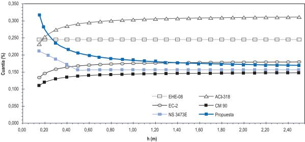
Figura 9. Cuantía mínima en función de h ajustando la expresión propuesta en función de fck. f<sub>ck</sub> = 40 MPa
