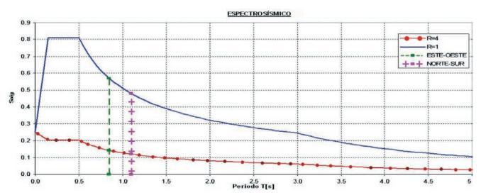
Figura 3. Espectro sísmico de diseño de la norma argelina para un amortiguamiento de  $\xi = 4\%$  y valores del coeficiente de reducción de fuerza sísmica R = 1 y R = 4
