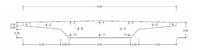
Figura 3. Situacion de los sensores en cada una de las secciones transversales instrumentadas
