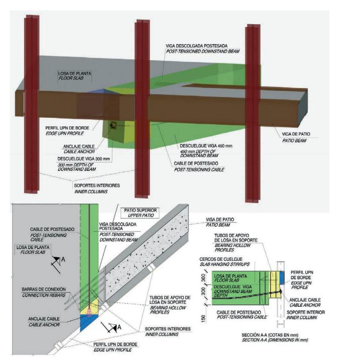
Figura 13. Detalle de apoyo de viga descolgada postesada en soporte metálico y encuentro con viga de patio Figure 13. Support detail of post-tensioned downstand beam on steel column and intersection with patio beam
