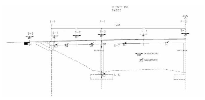
Figura 2. Situación de las secciones intrumentadas del tablero
