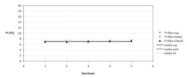
Figura 8. Valores de temperaturas medias para las distintas fibras y secciones para el día más frío. 01/01/2009 a las 10:00
