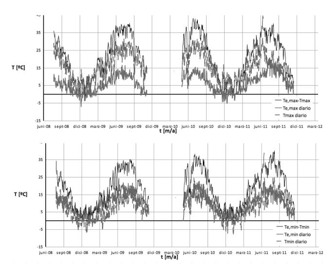
Figura 18. a) Evolución con el tiempo de la temperatura uniforme máxima diaria del tablero, la temperatura ambiente máxima de ese mismo día y la diferencia entre ambas. b) Evolución con el tiempo de la temperatura uniforme mínima diaria del tablero, la temperatura ambiente mínima de ese mismo día y la diferencia entre ambas
