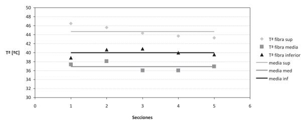
Figura 10. Valores de temperaturas medias para las distintas fibras y secciones para el día más caluroso. 23/08/2009 a las 19:00
