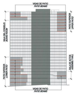
Figura 15. Esquema disposición de vigas de patio Figure 15. Layout scheme of patio beams
