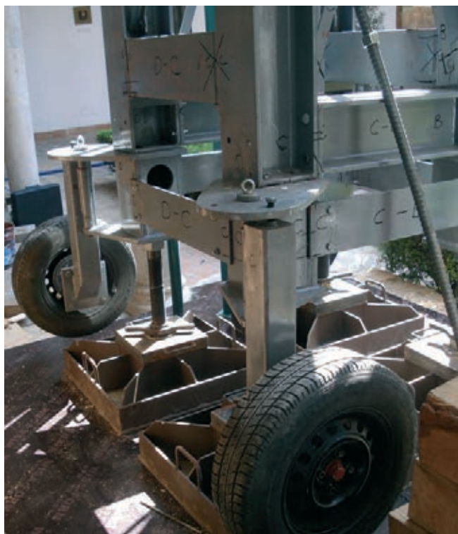
Figura 8. Detalle del doble apoyo con reparto y sobre neumáticos y detalle de las uniones atornilladas de la parte superior. También se aprecia parte de la instrumentación y la falta de acuíñado en el sector exterior.
