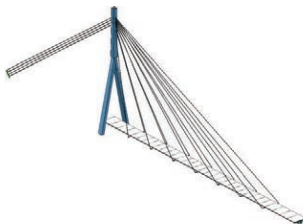
Figura 12. Modelo numérico empleado para la evaluación estructural
