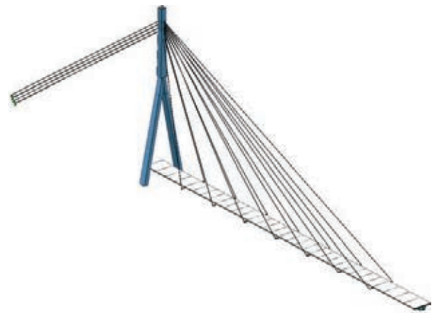
Figura 12. Modelo numérico empleado para la evaluación estructural
