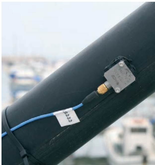
Figura 10. Acelerómetro MEMS empleado
