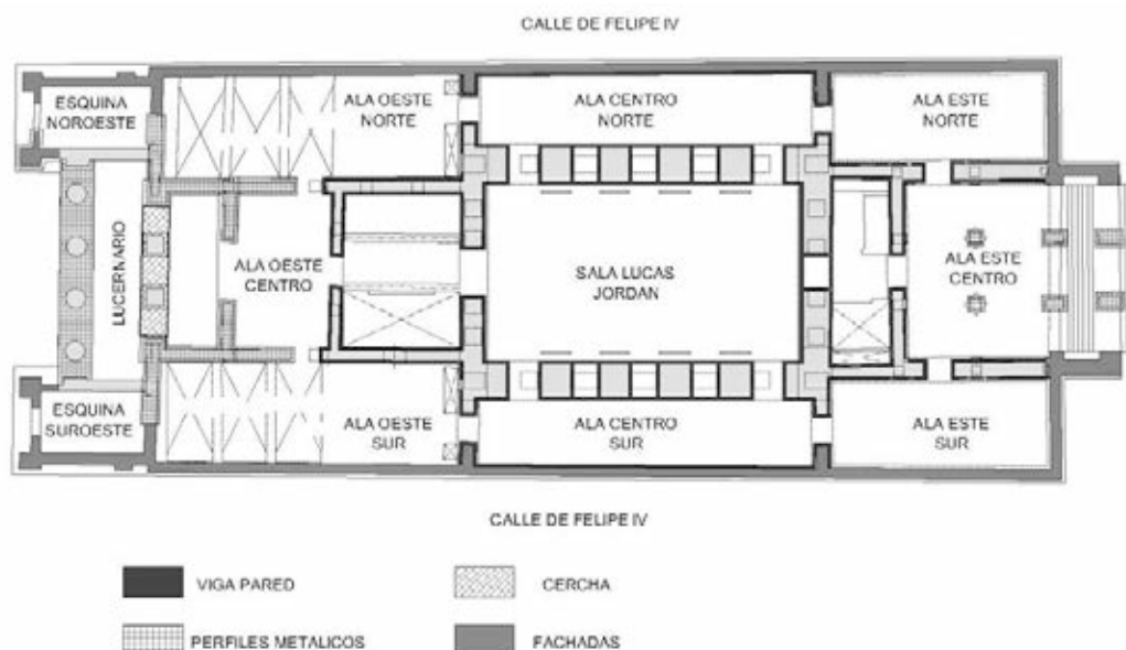
Figura 3. Soluciones estructurales por zonas
