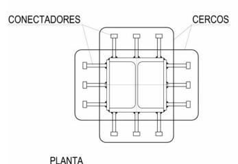
Figura 8. Detalle de punzonamiento mediante pernos conectadores.
