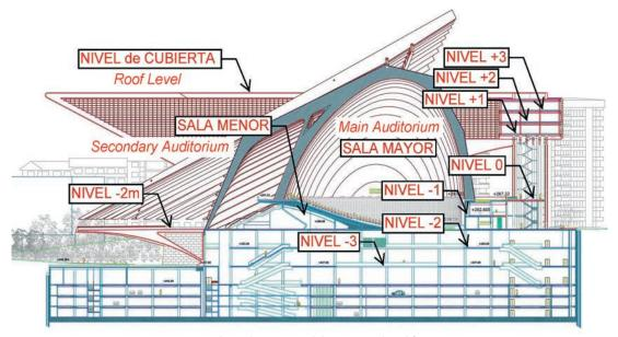
Figure 3. Sección por el eje de simetría del conjunto de edificaciones Buenavista Figure 3. Transverse section by the symmetry axis of the Buenavista building complex
