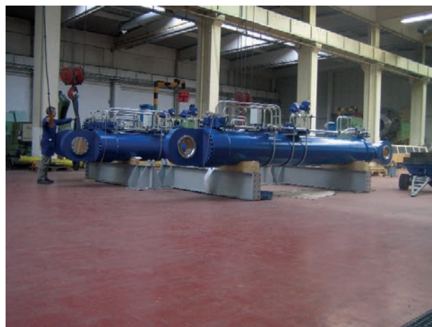
Figura 29. Cilindros hidráulicos de accionamiento Figure 29. Hydraulic cylinders
