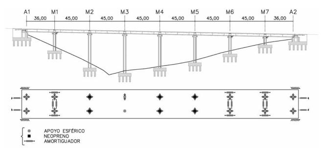
Figura 17. Esquema de aislamiento y amortiguación (SG28)
