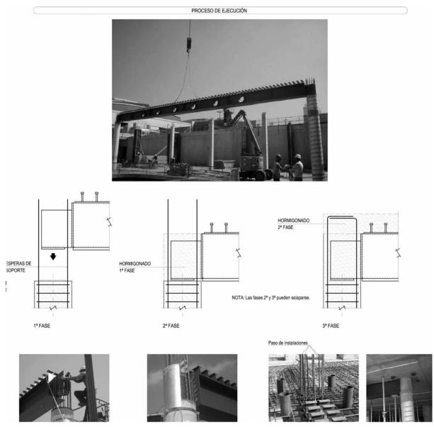
Figura 9. Detalle de apoyo de la parte metálica de vigas mixtas en soportes de hormigón sin equipo de soldadores en obra
