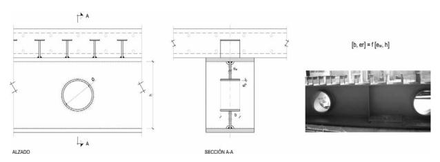
Figura 11. Detalle de refuerzo de alma tipo para conservar capacidades resistentes y deformacionales
