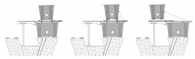
Figura 28. Alzados de las fases de ripado en la pila P.1-2
