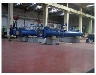
Figura 29. Cilindros hidráulicos de accionamiento Figure 29. Hydraulic cylinders
