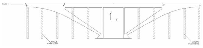
Figura 38. Esquema de la primera fase de montaje de la estructura Figure 38. Scheme of the first stage of the construction process
