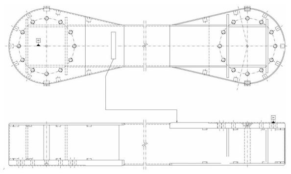
Figura 25. Geometría de las barras que forman parte del sistema de arriostramiento Figure 25. Geometry of the bars belonging to the bracing system
