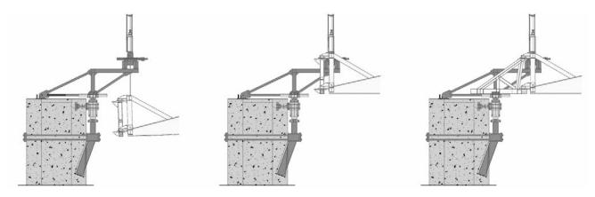
Figura 18. Principio recuperación de flecha con pórtico auxiliar en cabeza de pila
