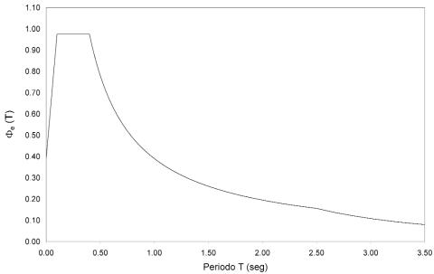
Figura 12. Espectro de respuesta elástico horizontal
