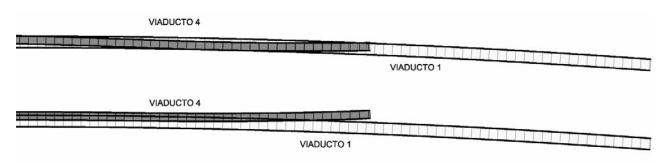
Figura 26. Posición en planta viaducto V4 antes y después de la maniobra de ripado
