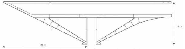
Figura 10. Geometría y dimensiones generales de los pórticos de soporte de las consejerías Figure 10. Geometry and general dimensions of the supporting main portals of the office buildings
