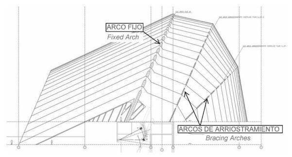
Figura 20. Costillas fijas, arco fijo y arcos de arriostramiento entre las mismas Figure 20. Fixed ribs and bracing arches between them
