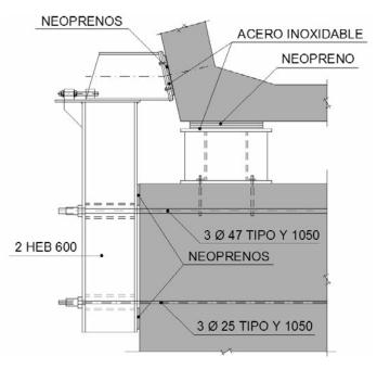
Figura 18. Dispositivo de guiado en cabeza (SG25 y SG28)
