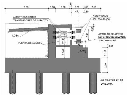
Figura 5. Estribo A2 de la estructura SG28 (segunda fase), con cámara accesible para amortiguadores longitudinales
