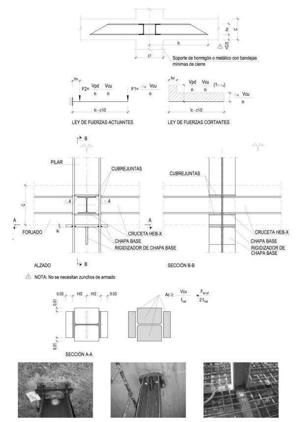
Figura 7. Detalle de punzonamiento mediante crucetas con base en ACI 318-99. Fotos cortesía de D. Rafael Fortézar. DRAGADOS.
