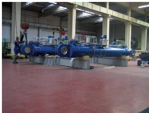
Figura 29. Cilindros hidráulicos de accionamiento Figure 29. Hydraulic cylinders
