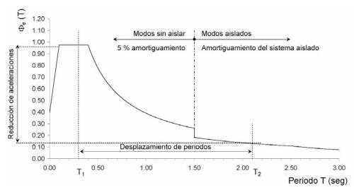
Figura 13. Esquema genérico de reducción de acción sísmica [9]
