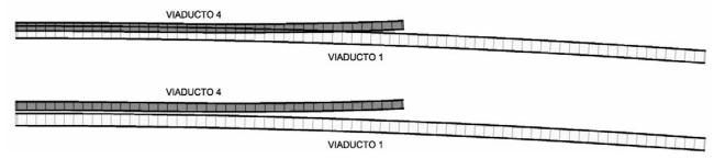
Figura 30. Posición en planta viaducto V4 antes y después de la maniobra de izado
