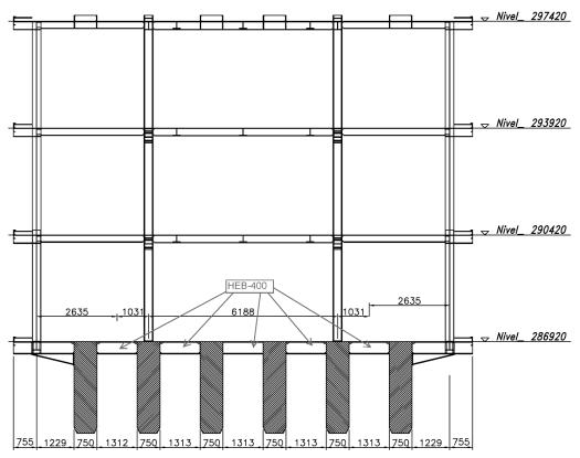
Figura 13. Pórtico transversal tipo del entramado metálico de los edificios (consejerías)
