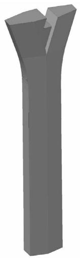
Figura 6. Vista 3D de la pila P.2-2 con fuste de sección hexagonal y dintel doble
