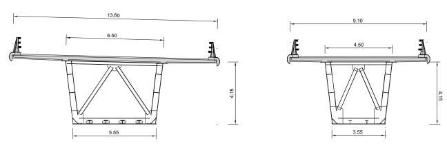
Figura 3. Sección viaducto V1 (izquierda) y viaducto V4 (derecha)
