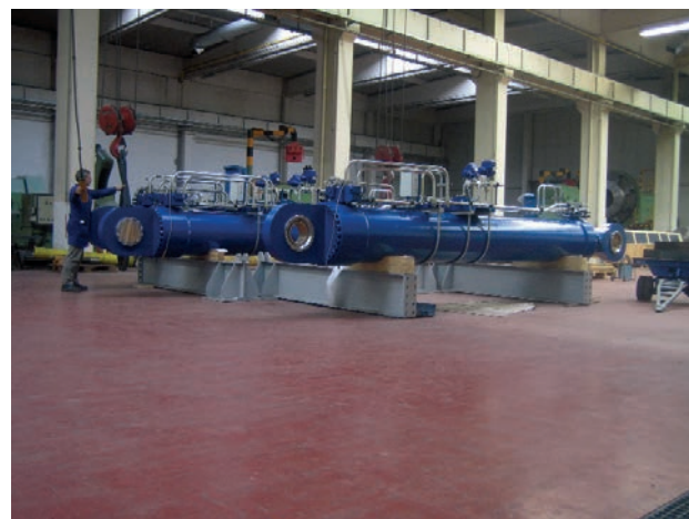
Figura 29. Cilindros hidráulicos de accionamiento Figure 29. Hydraulic cylinders
