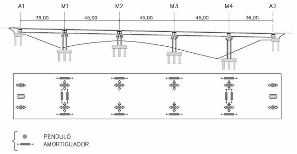
Figura 19. Esquema de aislamiento y amortiguación (SG27)
