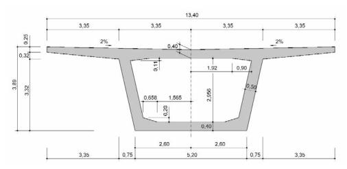
Figura 1. Sección transversal tableros SG25 y SG28
