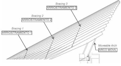
Figura 23. Vista general de las costillas móviles, el arco móvil y el sistema de arriostramiento transversal
