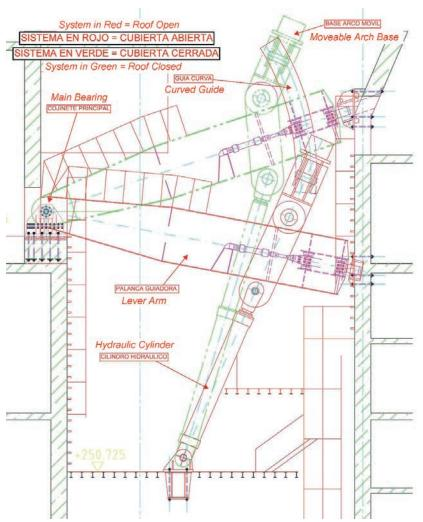
Figura 27. Sistema de accionamiento de la cubierta móvil Figure 27. Operation system of the moveable roof
