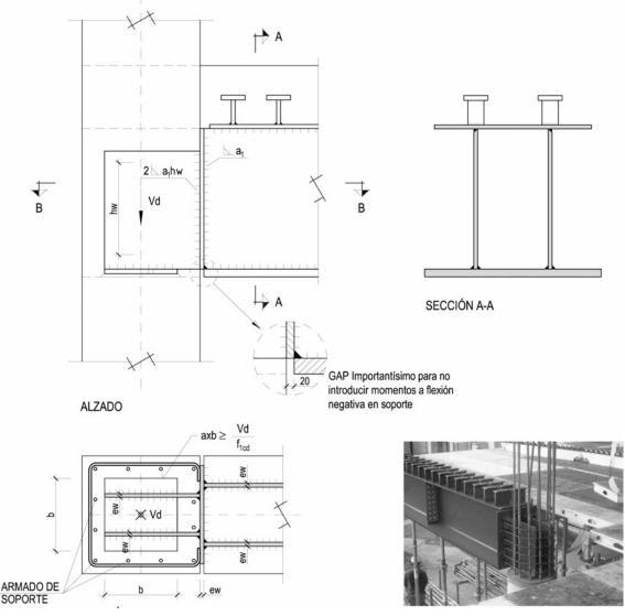
Figura 10. Procedimiento constructivo
