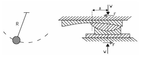
Figura 15. Principio de funcionamiento de un dispositivo FPS
