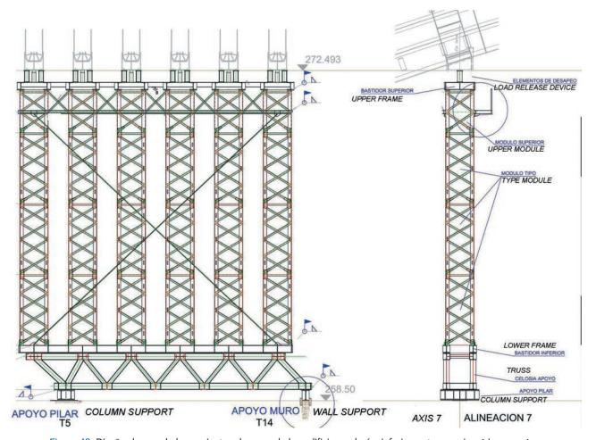
Figure 43. Diseño de uno de los conjuntos de apeo de los edificios: celosías inferiores, torres y bastidor superior Figure 43. Design of one of the auxiliary structures used to mount the main portals: lower trusses, towers and upper frame
