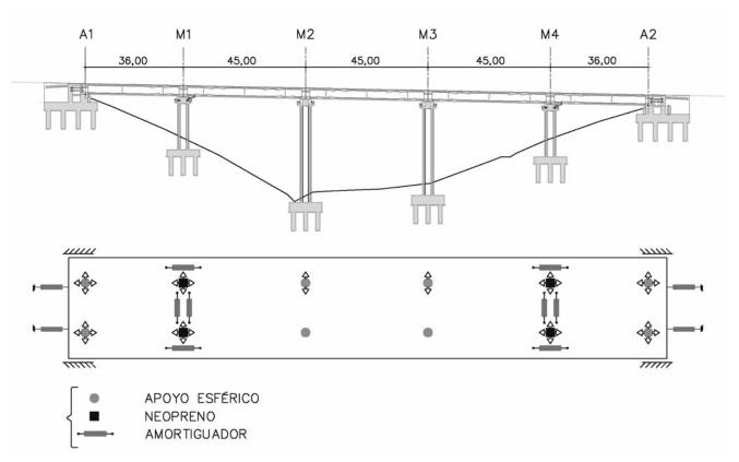
Figura 16. Esquema de aislamiento y amortiguación (SG25)
