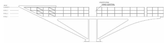
Figura 40. Montaje del entramado metálico secundario de uno de los edificios de Consejerías, a excepción del vano central Figure 40. Mounting of the secondary steel frame of the office buildings except for the central span
