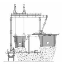
Figura 33. Alzados de las fases de izado
