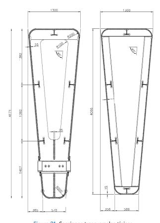
Figura 21. Secciones transversales típicas de las costillas móviles Figura 21. Typical transverse sections of the moveable ribs
