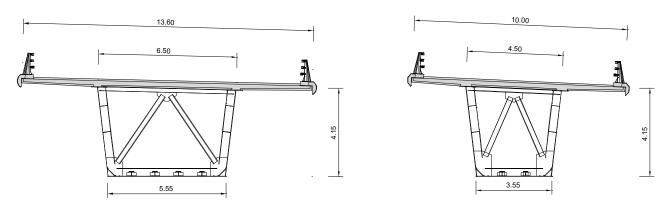
Figura 4. Sección viaducto V2 (izquierda) y viaducto VR2 (derecha)
