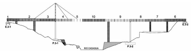
Figura 40. Esquema de alzado del viaducto V3 con todos los elementos auxiliares de montaje, ilustrando las fases de montaje e incluyendo la colocación de la dovela central nº 10
