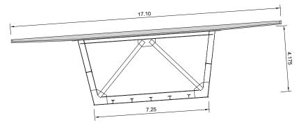
Figura 5. Sección viaducto V3
