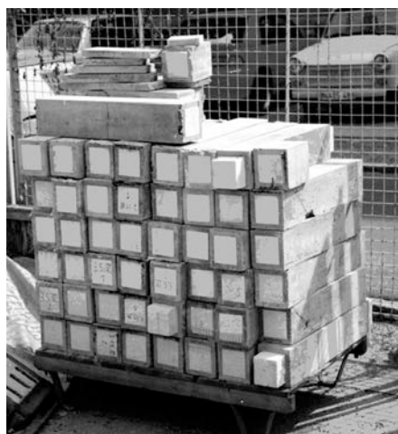
Figura 1. Primeras probetas de hormigón con textiles: (izq.) dinteles de ventanas con matriz de poliestireno; (dcha) resultados experimentales (ensayo a flexión) [5]
