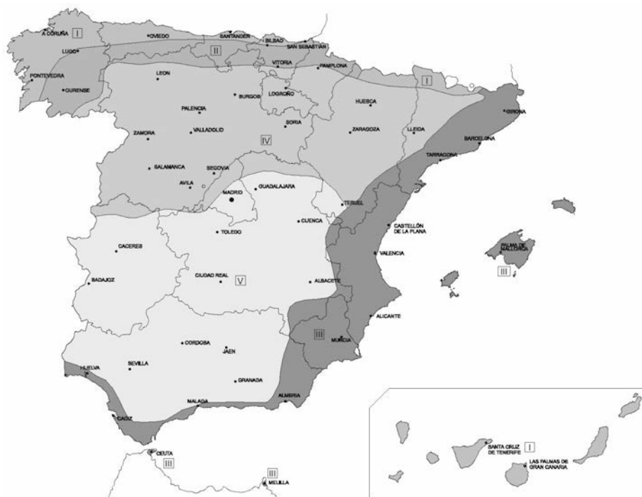
Figura 1. Zonas “z” para la obtención de la variación uniforme de temperatura del puente (Figura 7 de la IAP-98[2])
