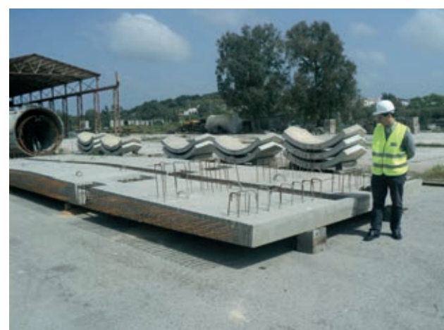
Figura 26. Losa prefabricada de positivos en la planta durante su fabricación Figure 26. Sagging zone precast slab at the shop during fabrication
