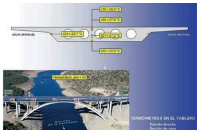
Figuras 19a y 19b. Infogramas con instrumentación térmica del arco de hormigón de la calzada derecha y de la sección de losa aligerada instrumentada del tablero
