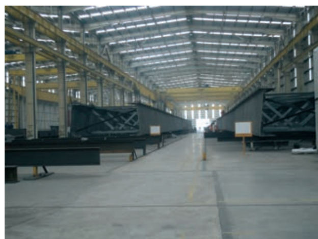
Figura 21. Fabricación en taller y transporte a obra de dovelas metálicas del tablero Figure 21. Fabrication at Shop and transport of steel deck segments to the site
