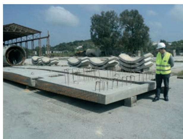
Figura 26. Losa prefabricada de positivos en la planta durante su fabricación Figure 26. Sagging zone precast slab at the shop during fabrication
