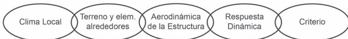
Figura 1. Cadena de carga del viento de Davenport (denominada así en asamblea general por unanimidad, IWEC 2011 [13]).
