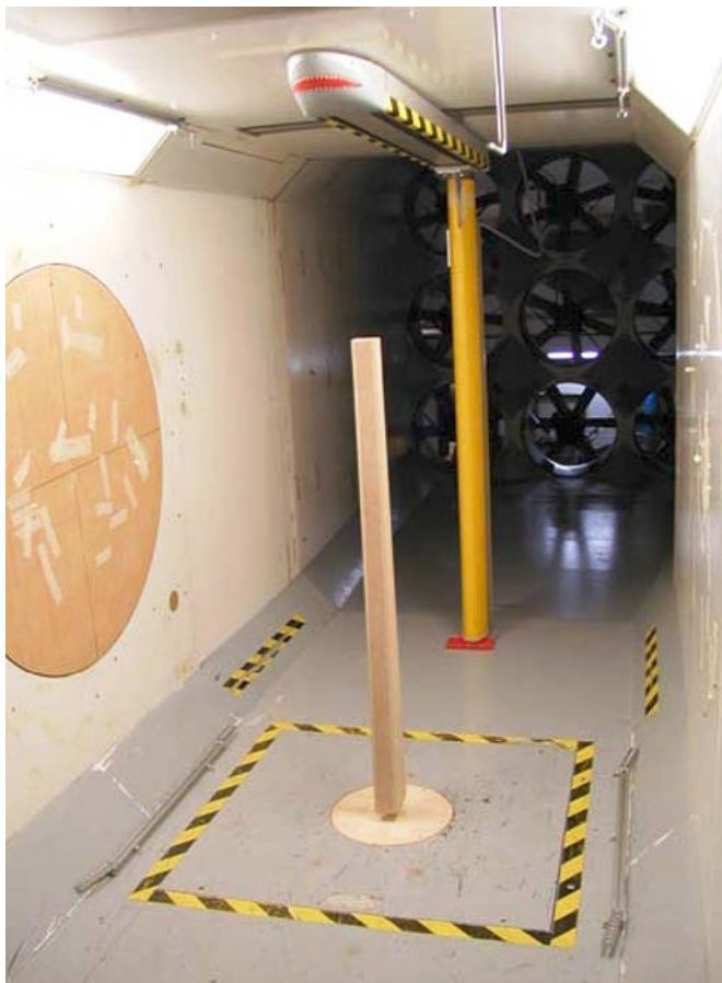
Figura 12. Ensayo de viento seccional de la pila 4.
