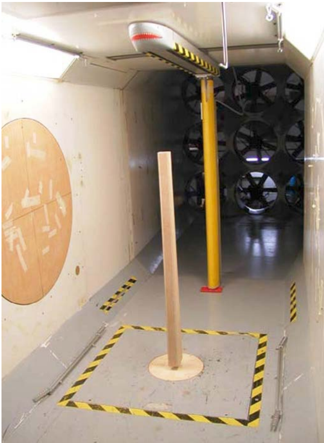
Figura 12. Ensayo de viento seccional de la pila 4.
