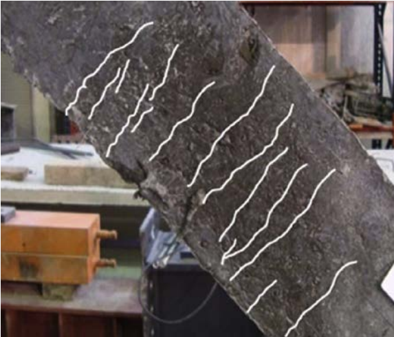
Figura 18. Patrón de fisuración de una diagonal traccionada al 2,5% de deformación media.
