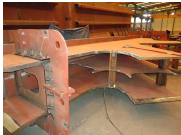
Figura 15. Vista de fabricación de un nudo tumbado.
