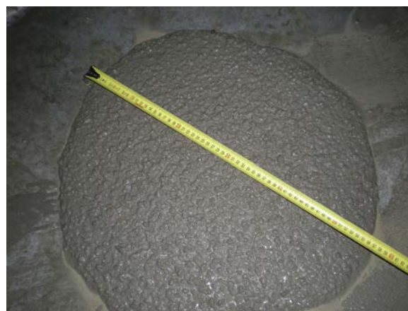
Figura 2. Ensayo de escurrimiento.
