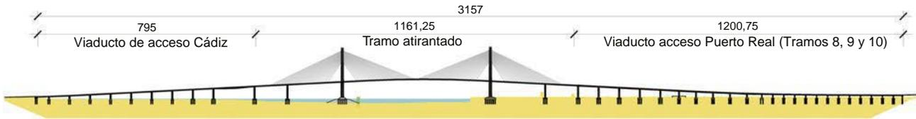
Figura 1. Alzado general del puente.
