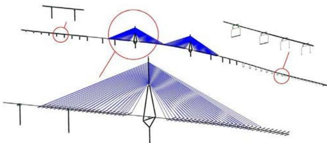
Figura 5. Modelo de barras del puente completo.
