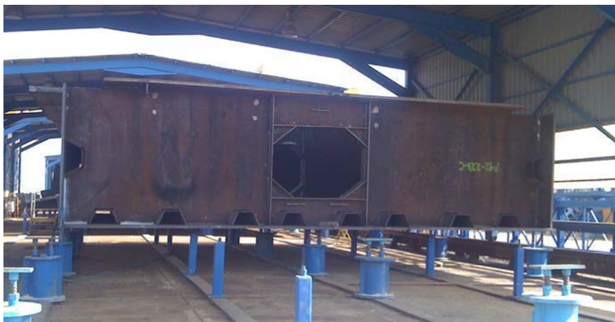
Figura 6. Cajón central en fabricación.
