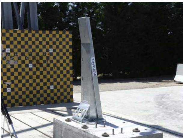
Figura 7. Ensayos de impacto de los pretils.
