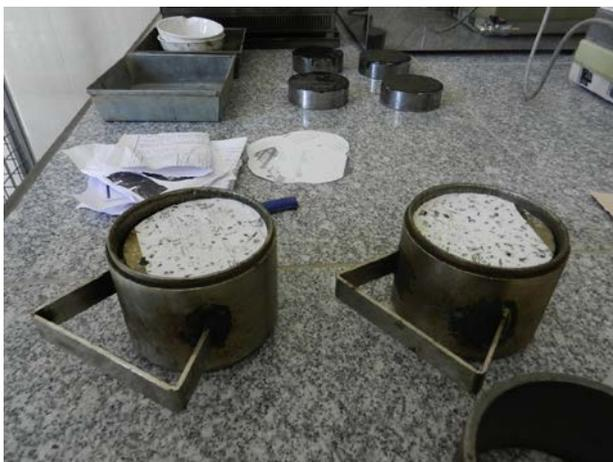
Figura 4. Probetas del firme del tramo desmontable.
