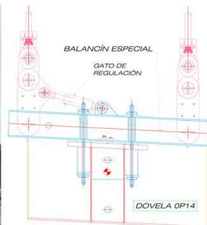
Figura 3. Balancín especial para el izado de la dovela de pila.
