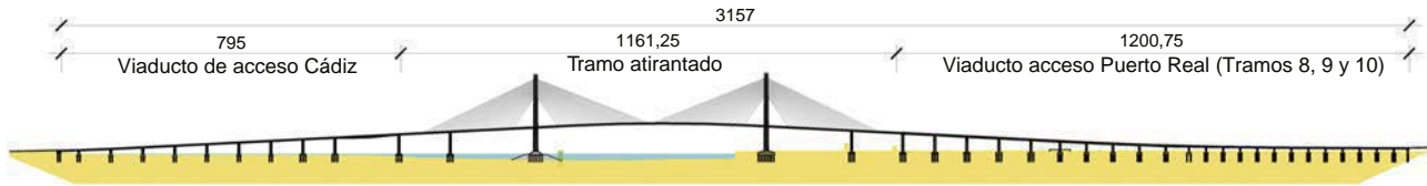
Figura 1. Alzado general del puente.
