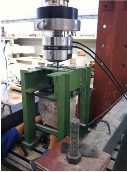
Figura 11. Ensayo de adherencia pull-out en laboratorio.
