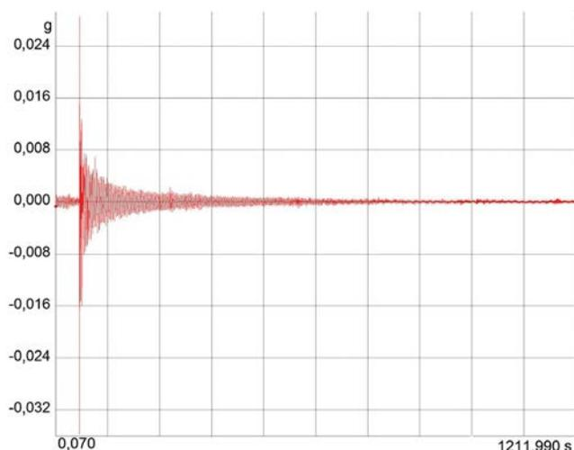
Figura 2. Acelerograma vertical en centro de vano.
