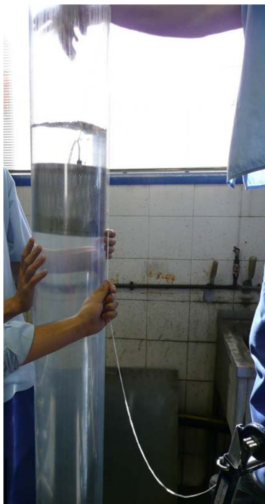
Figura 3. Caída libre del cesto por la columna de agua.
