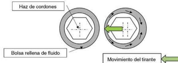
Figura 6. Piezas y funcionamiento de los amortiguadores IHD.
