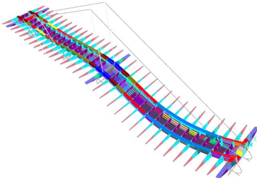
Figura 13. Cálculo del empuje y deformada del dintel.
