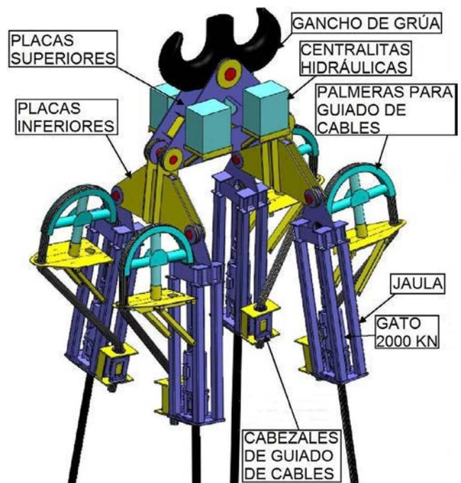
Figura 2. Dispositivo de nivelación de carga suspendida.
