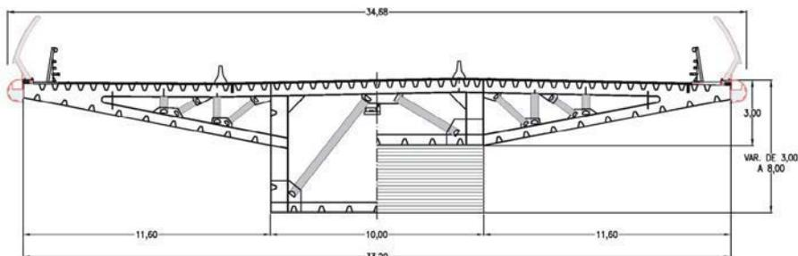
Figura 17. Alzado y sección transversal del puente desmontable.
