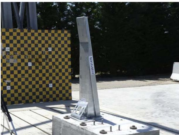
Figura 7. Ensayos de impacto de los pretils.
