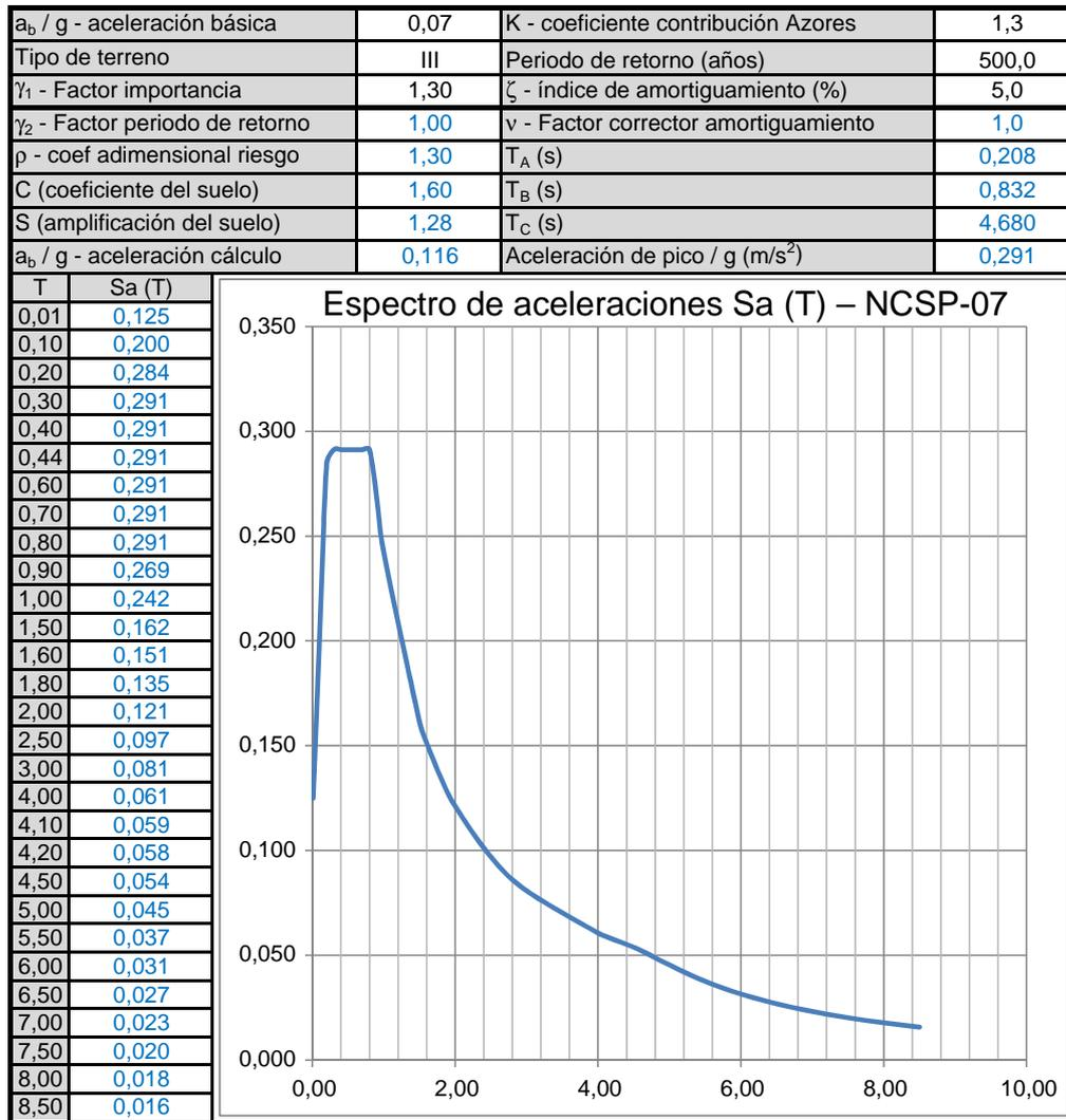
Figura 1. Definición del espectro de respuesta de aceleraciones.
