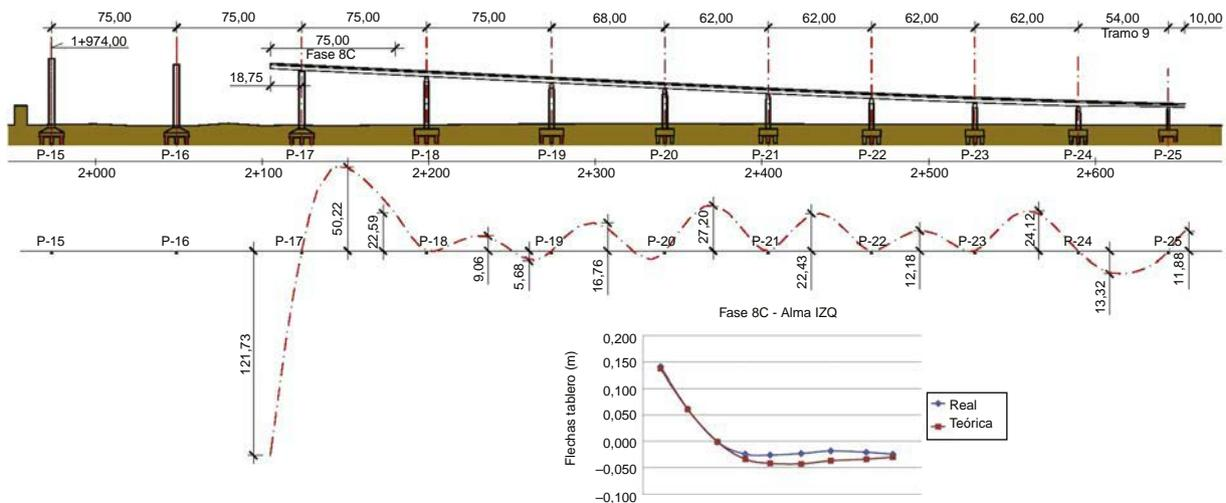
Figura 17. Contraflechas de ejecución en el tablero.
