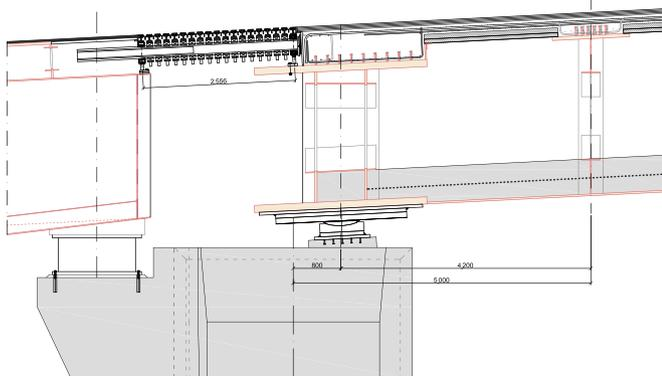
Figura 27. Junta de dilatación modular en pila 10.
