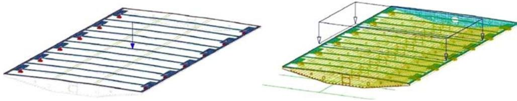
Figura 8. Esquema de modelo de elementos finitos para estudiar el esfuerzo rasante en la losa superior producido por diversas cargas, puntual y distribuida.
