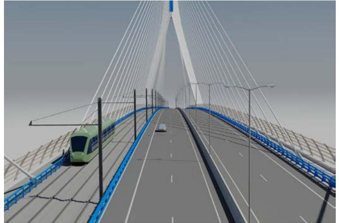
Figura 8. Infografía de la configuración de tráfico y equipamientos de la sección transversal.
