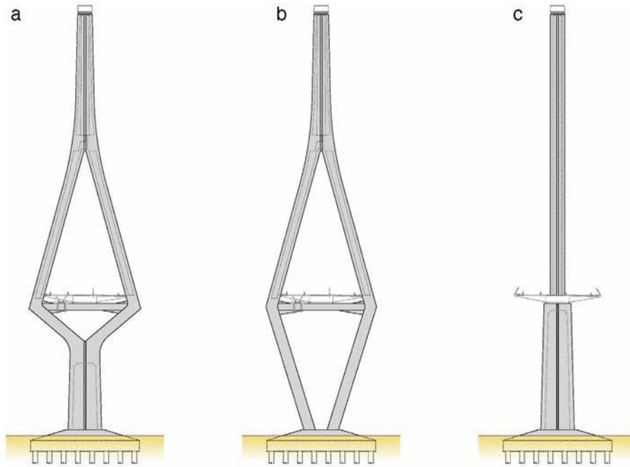
Figura 21. Distintas configuraciones de las torres de atirantamiento.
