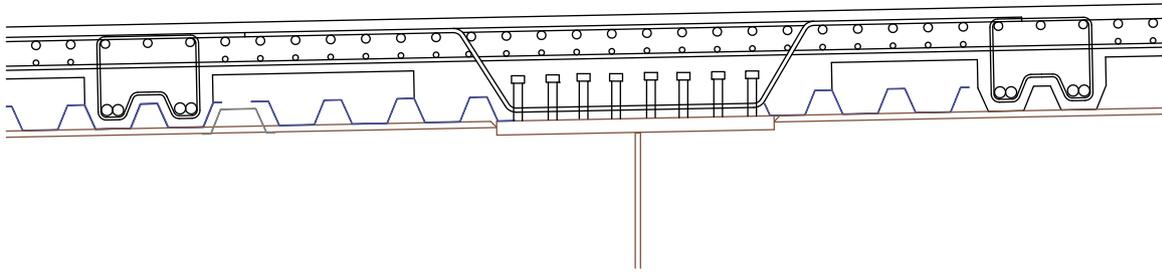
Figura 11. Solución de losa aligerada con chapa grecada.
