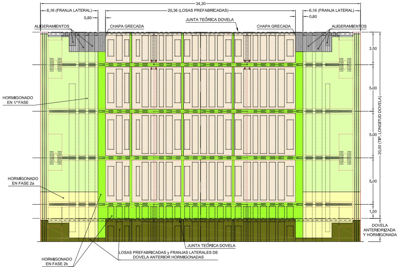
Figura 9. Distribución de losas en dovela tipo.
