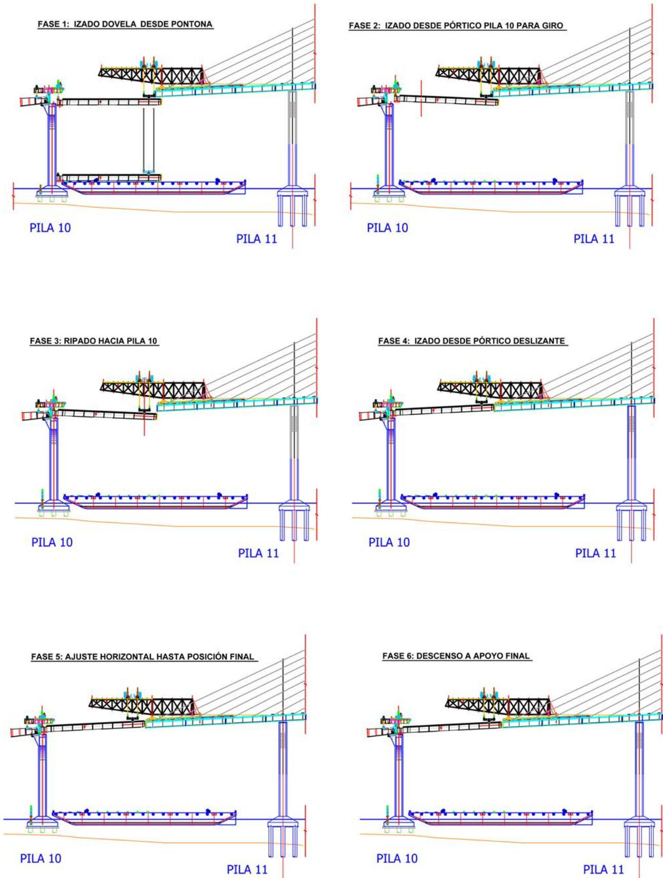
Figura 18. Cinemática de colocación de la dovela extrema.
