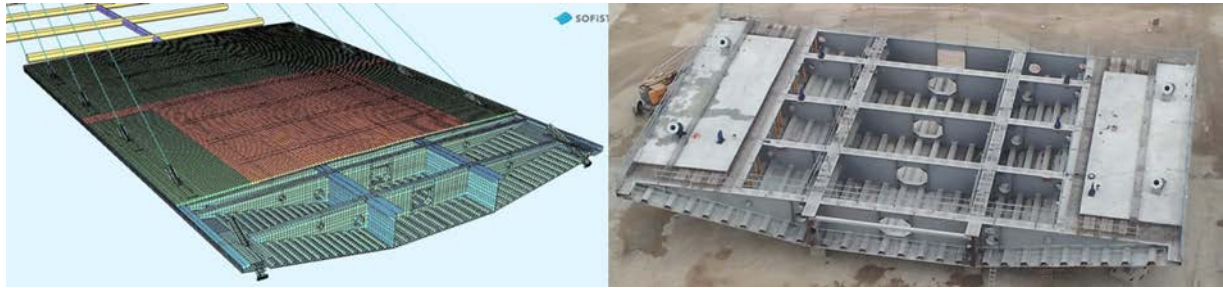
Figura 7. Modelo de elementos finitos de ciclo tipo de dovela.
