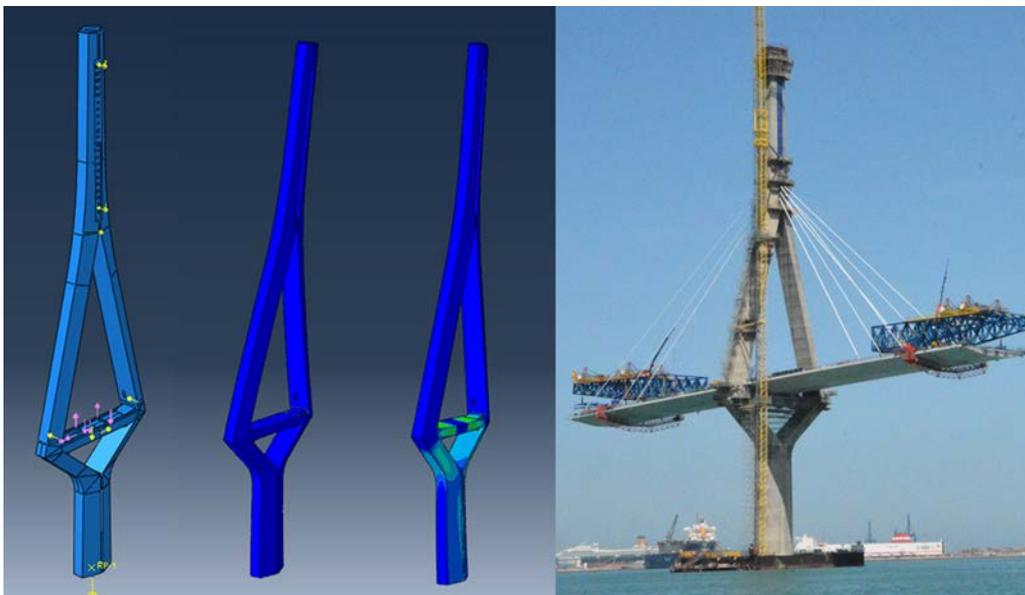
Figura 21. Modelo de torre completa para calibrar modelo de barras.
