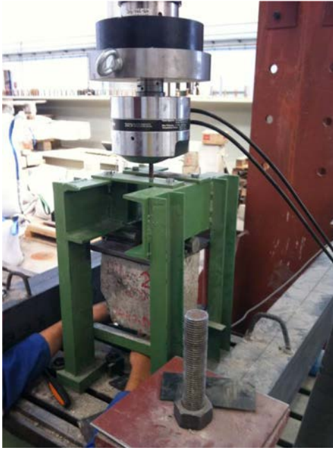
Figura 11. Ensayo de adherencia pull-out en laboratorio.
