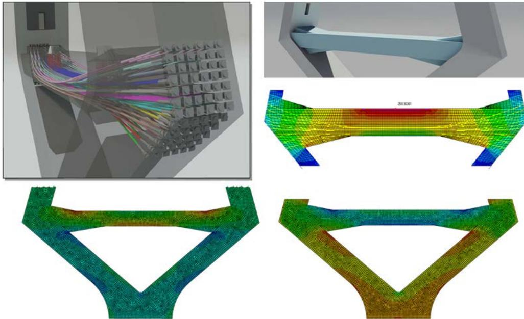
Figura 22. Perspectiva y modelo de riostra pretensada.
