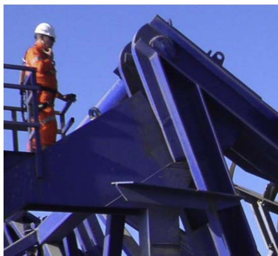
Figura 8. Pescante. Detalle de cuelgue superior.
