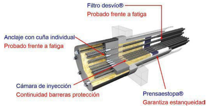
Figura 2. Anclaje Freyssinet.
