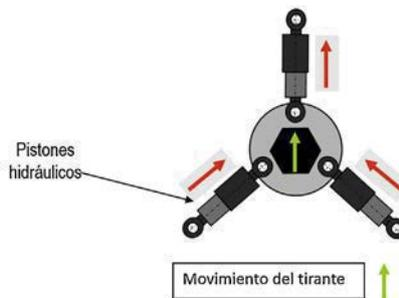
Figura 7. Piezas y funcionamiento de los amortiguadores IRD.
