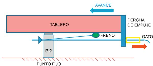
Figura 8. Esquema del sistema de empuje y retenida.
