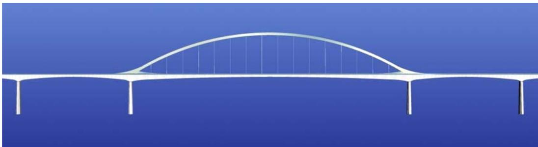
Figura 4. Estudio previo de soluciones con arco de tablero inferior.
