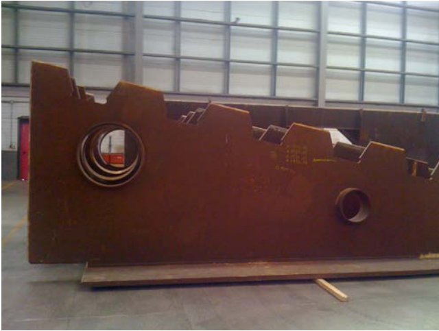
Figura 7. Voladizo en fabricación.
