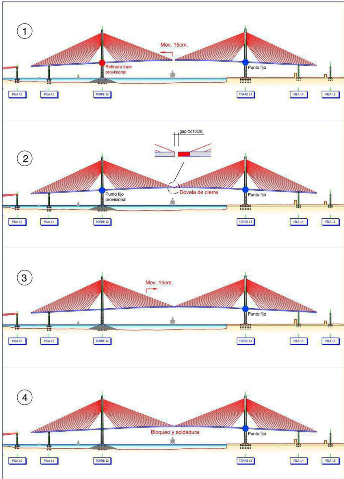
Figura 8. Sistema de movimiento y bloqueo del tablero.
