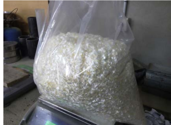
Figura 5. Fibras del firme del tramo desmontable.
