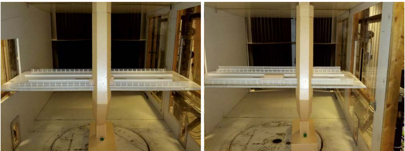
Figura 8. Maqueta de modelo seccional. Estudio de influencia de las torres en la acción del viento sobre los vehículos.
