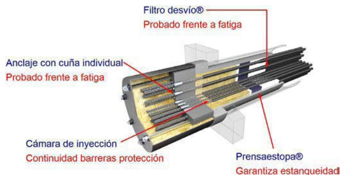
Figura 2. Anclaje Freyssinet.
