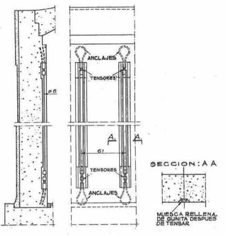
Fig. 2.-Detalle de las barras verticales de pretensado.
