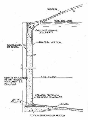
Fig. 7.—Sección vertical parcial que muestra la disposición de las armaduras.
