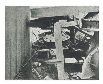
Fig. 4.—Detalle del dispositivo de arrollamiento del cable.
