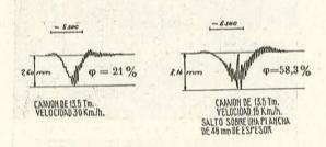
Fig. 9.—Medidas dinámicas (antes de la colocación del revestimiento asfáltico).
