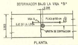
Fig. 15.—Ensayo de carga núm. 20, sin pretensado
