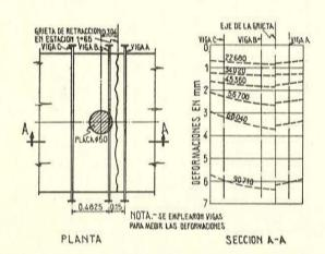
Fig. 14.—Ensayo de carga núm. 16 con pretensado longitudinal de 17,57 kg/cm² y sin transversal.
