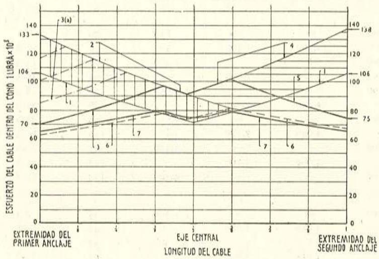
Fig. 4.—Curvas mostrando el efecto de deslizamiento.
