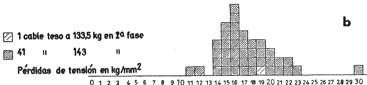
Fig. 15.—Tzado de los cables longitudinales.—Pérdidas totales de tensión (T inicial en el manómetro; Tm después de la fijación de los anclajes, deducida de los alargamientos).
