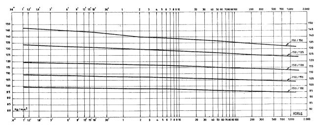
Fig. 31.—Diagramas de relajación bajo diversas tensiones iniciales después de un estirado previo a 150  $\rm kg/mm^2.$
