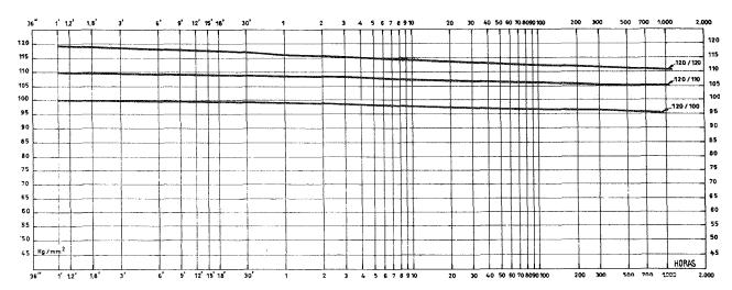
Fig. 28.—Diagramas de relajación bajo diversas tensiones iniciales después de un estirado previo a 120 kg/mm².
