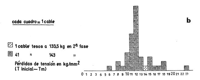
Fig. 11.—Tesado de los cables longitudinales.—Pérdidas de tensión antes de la fijación de los anclajes (T en kg/mm² leída en el manómetro; T media deducida de los alargamientos medidos).
