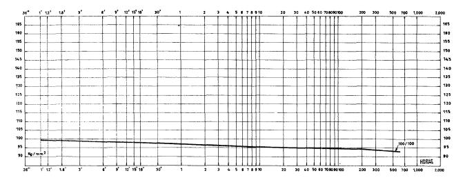
Fig. 26.—Diagramas de relajación bajo diversas tensiones iniciales después de un estirado previo a  $100~{\rm kg/mm^2}$ .
