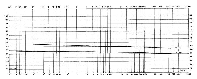
Fig. 27.—Diagramas de relajación bajo diversas tensiones iniciales después de un estirado previo a 110 kg/mm².
