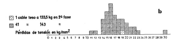
Fig. 15.—Tesado de los cables longitudinales.—Pérdidas totales de tensión (T inicial en el manómetro; Tm después de la fijación de los anclajes, deducida de los alargamientos).
