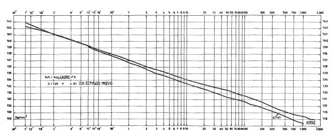
Fig. 24.—Diagramas de relajación bajo tensión inicial de 145 kg/mm² después de un estirado previo seguido de fluencia durante dos minutos.
