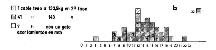
Fig. 12.—Tesado de los cables longitudinales.—Acortamientos, en mm, durante la fijación de los anclajes para los dos extremos.
