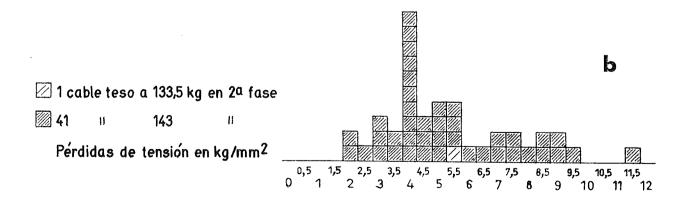
Fig. 14.—Tesado de los cables longitudinales.—Pérdidas de tensión, en kg/mm², durante la fijación de los anclajes.
