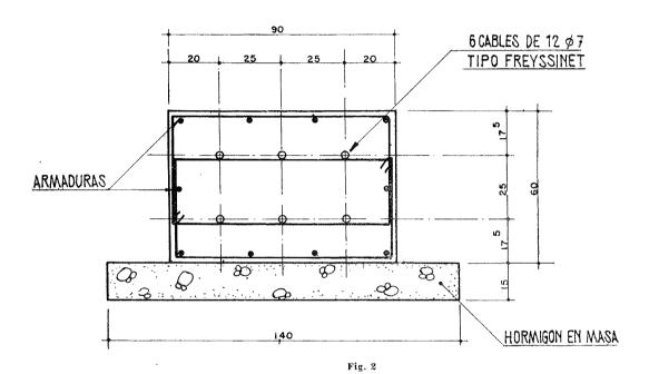
Una vez experimentadas las pérdidas de pretensado, el esfuerzo final quedó reducido a 230 t, superior todavía a la máxima reacción horizontal del arco bajo la solicitación más desfavorable.
