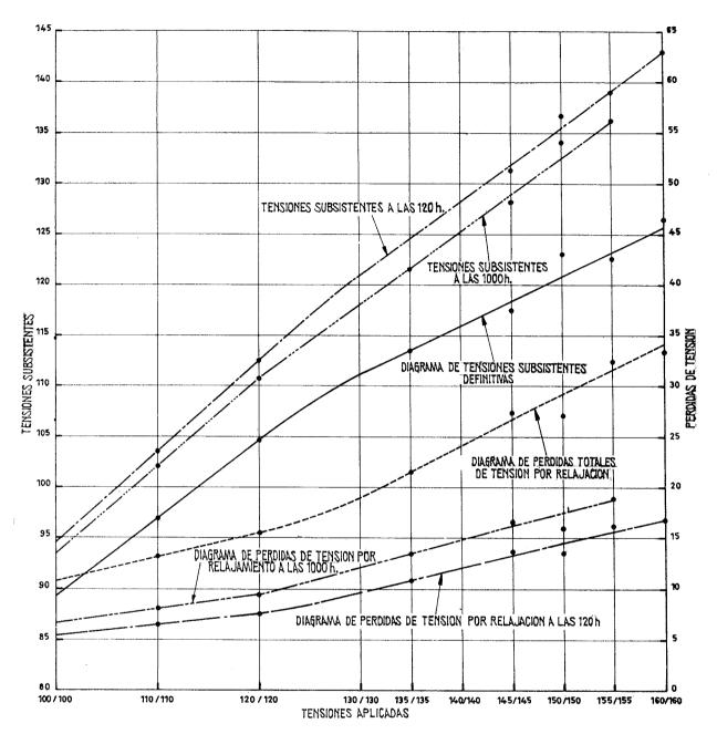
Fig. 33.—Diagramas de tensiones subsistentes obtenidas a las 120 horas, a las 1.000 horas, y definitivas, para tensiones iniciales de 100 a 160 kg/mm², después de un estirado previo, durante dos minutos, bajo tensiones de igual valor.
