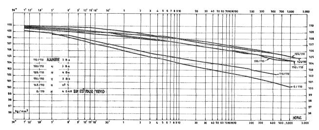
Fig. 21.—Diagramas de relajación bajo tensión inicial de 110 kg/mm² después de un estirado previo seguido de fluencia durante dos minutos.
