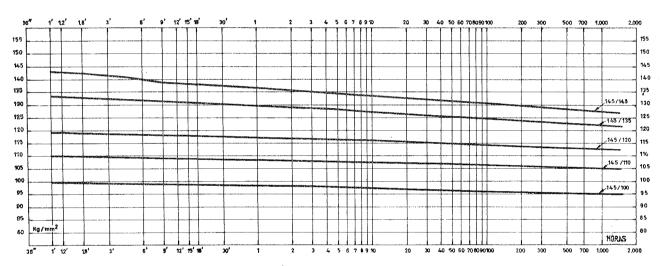
Fig. 30.—Diagramas de relajación bajo diversas tensiones iniciales después de un estirado previo a 145 kg/mm².
