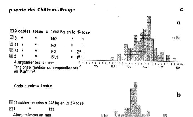
Fig. 10.—Tesado de los cables longitudinales.—Alargamientos unitarios y tensiones antes de la fijación de los anclajes.
