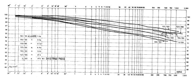
Fig. 20.—Diagramas de relajación bajo tensión inicial de  $100~{\rm kg/mm^2}$  después de un estirado previo seguido de fluencia durante dos minutos.
