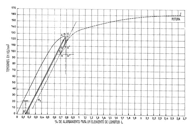
Fig. 35.-Variaciones de las tensiones en el medio de la viga.
