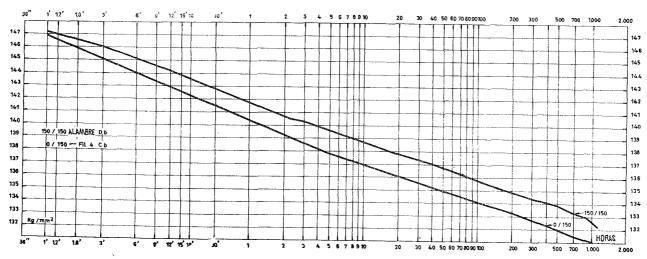
Fig. 25.—Diagramas de relajación bajo tensión inicial de 150 kg/mm² después de un estirado previo seguido de fluencia durante dos minutos.
