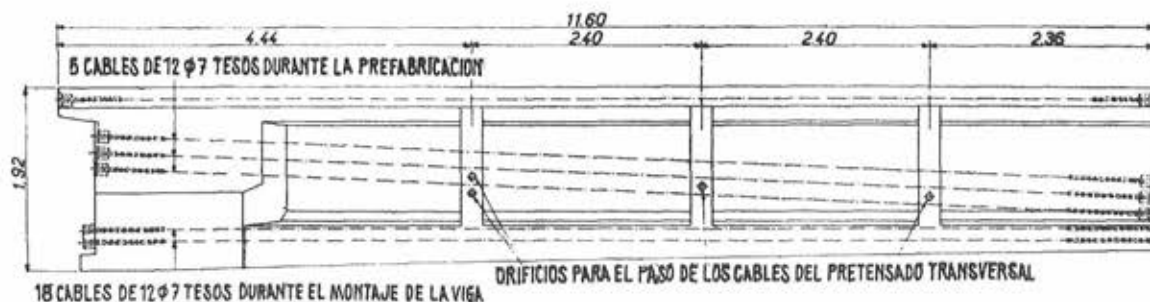
Fig. 8.—Vista, en alzado, del elemento extremo de una viga (el elemento central, hasta el momento de su montaje en obra, lleva solamente un cable de pretensado).
