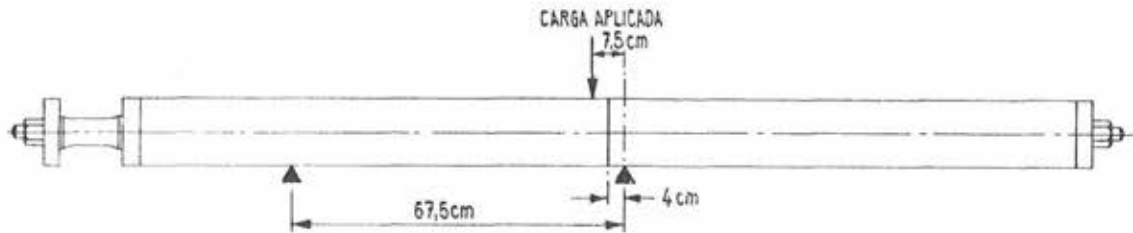
Fig. 5.—Esquema representativo del dispositivo de carga utilizado para los ensayos de las juntas lisas entre elementos colocados simplemente a tope.
