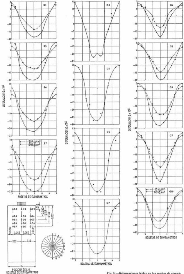
Fig. 24.—Deformaciones leidas en las rosetas de elongámetros colocadas en un bloque de anelaje tipo C, con relación  $a_1/a=0.67$ .
