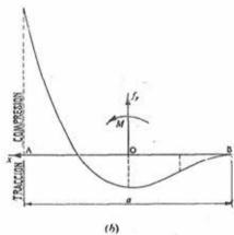
Fig. 4.—Bloque de anclaje y distribución de las tensiones transversales de acuerdo con la teoría de Magnel.
