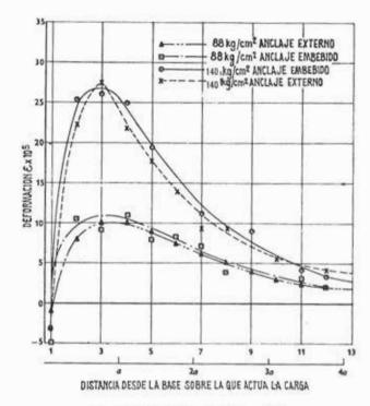
(a) Probetas tipo A  $(a_i/a = 0.72)$
