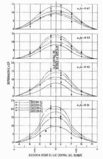
Fig. 23. — Deformaciones transversales experimentales correspondientes a las secciones transversales 2, 3, 4 y 5, para relaciones  $a_1/a=0.31;\ 0.43;\ 0.53$  y 0.67.
