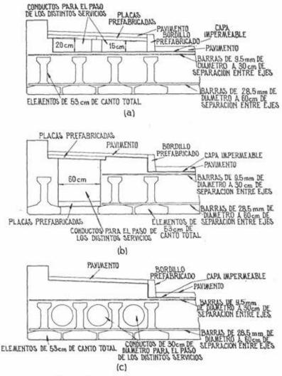
Fig. 2.-Distintas soluciones para los bordes del tablero
