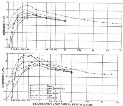
33. - Deformaciones transversales, teóricas y experimentales, en bloexperimentales, en blo-ques de los tipos AI y BI. a<sub>1</sub>/a=0,72 y 0,63, p=88 ki-los/centímetro cuadrado.
