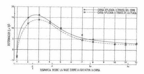
Fig. 14. — Deformaciones transversales medidas sobre el eje central de bloques tipo B, bajo carga aplicada a través de placa y a través de cono. Compresión uniforme: p≈88 kg/cm².
