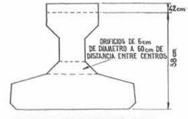
SECCIONES PREFABRICADAS I Y II
