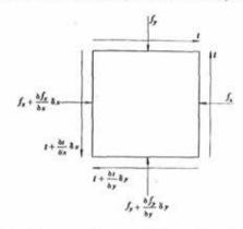
Fig. 5.—Condiciones de equilibrio en un elemento infinitesimal.
