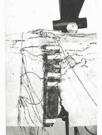
Vigas de hormigón pretensado ensayadas a flexión.
