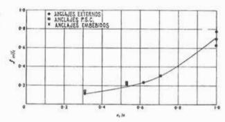
Fig. 39.—Relación entre f<sub>cr/fc</sub> y a<sub>1</sub>/a para bioques sin armadura transversal, con anclajes externos y embebidos.
