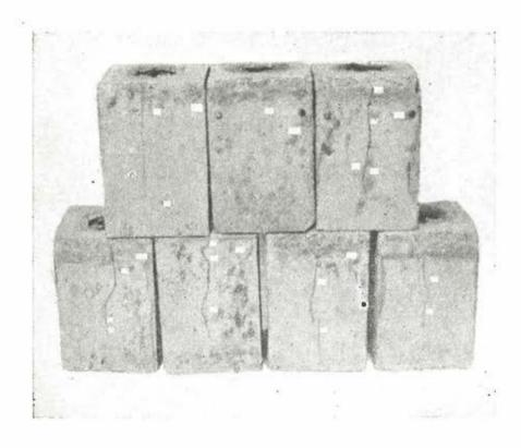
Fig. 29.—Aspecto de las fisuras en bloques con anclajes tipo P. S. C. y distintas zuantias de armadura transversal.
