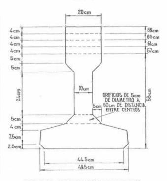
SECCIONES PREFABRICADAS III, IV, V, VI Y VII
