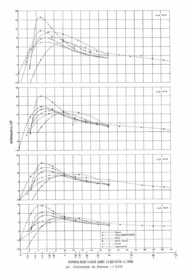
Fig. 32.—Deformaciones transversales, teóricas y experimentales, para distintas relaciones a<sub>t</sub>/a<sub>.</sub>
