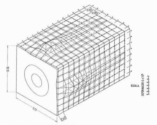
Fig. 22.—Perspectiva isométrica de las deformaciones transversales en un bloque del tipo C. Relación  $a_1/a=0,31$ .
