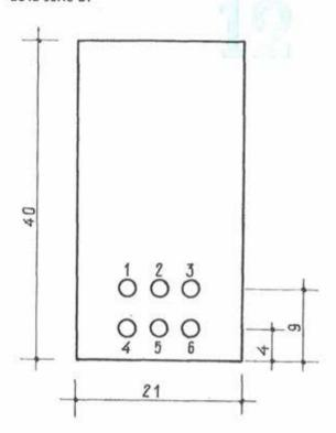
Observaciones: de l'amite elástico de los redondos ordinarios, deducido en el ensayo que se cita. Mrot el Walor del momento flector producido, sobre la sección central, por el peso propio de la pieza más las cargas aplicadas, en el instante de alcanzarse la rotura.
