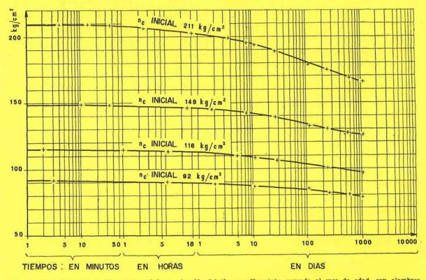
Fig. 7.—Variación de la tensión del hormigón, en función del tiempo.—Hormigón cargado al mes de edad, con alambres de acero patentado.
