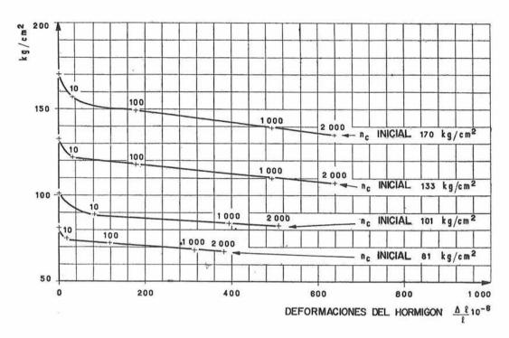
Fig. 10.—Diagramas de tensiones-deformaciones lentas, del hormigón.—Hormigón cargado al año de edad. Las cifras marcadas sobre las curvas indican días.
