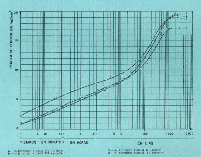
Fig. 4.—Diagrama de relajación de los alambres trefilados.—Tensión inicial  $\simeq 0.66$  R.—Hormigón pretensado al año de edad.
