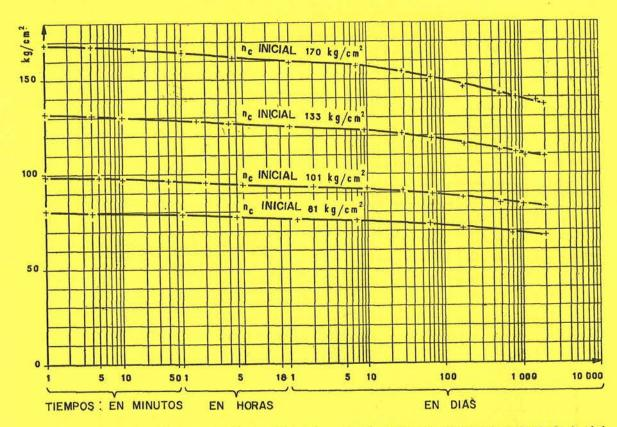
Fig. 6.—Variación de la tensión de compresión en el hormigón, en función del tiempo.—Hormigón cargado al año de edad, con alambres trefilados.
