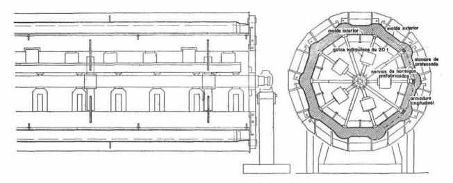
Fig. 1.—Secciones, longitudinal y transversal, de la máquina utilizada para la fabricación de las tuberías. El alambre de pretensado se sujeta, en los vértices del polígono, en unos redondos longitudinales que, a su vez, se apoyan sobre nervios de hormigón, prefabricados. La tensión se introduce mediante gatos hidráulicos de 20 toneladas, que empujan los alambres hacia el exterior.
