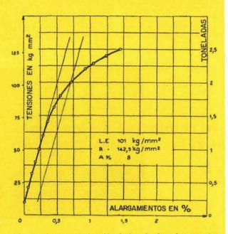
Fig. 1.—Diagrama de tracción de los alambres de acero, trefilados, utilizados para los ensayos con hormigones de un año de edad.
