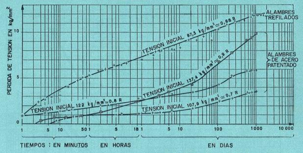
Fig. 3.-Diagrama de relajación de los alambres aislados.
