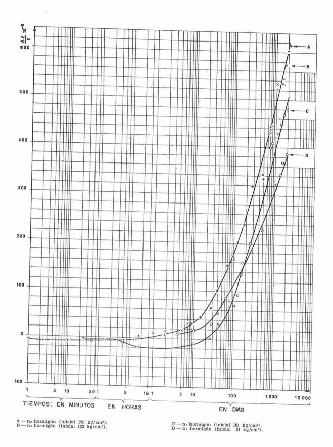
Fig. 8.—Diagrama de deformaciones lentas del hormigón.—Hormigón cargado al año de edad.
