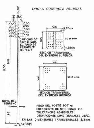
Fig. 1.—Detalle de uno de los postes de hormigón pretensado, de sección tranversal cuadrada, tipo 36/400.
