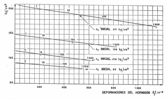
Fig. 11.—Diagramas de tensiones-deformaciones lentas del hormigón (deducida la retracción).—Hormigón cargado al mes de edad. Las cifras marcadas sobre las curvas indican días.
