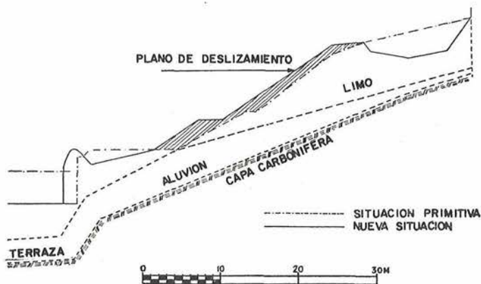
Figs. 28 y 29. Sección esquemática y una vista de la Colina de Cointe, que domina la estación de Guillemins, en Lieja. En la fotografía puede apreciarse la importancia de los daños causados por el deslizamiento de las capas del terreno.
