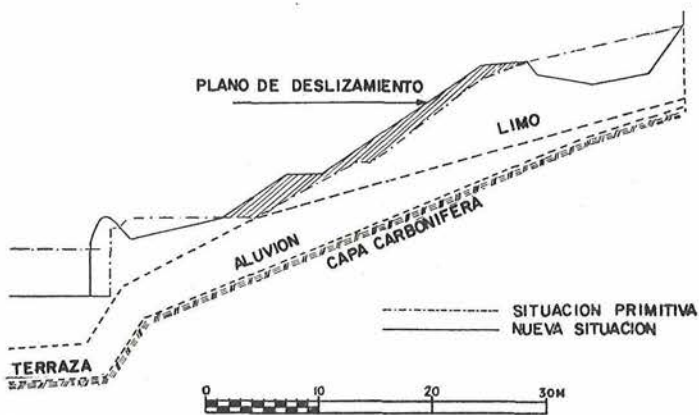
Figs. 28 y 29. Sección esquemática y una vista de la Colina de Cointe, que domina la estación de Guillemins, en Lieja. En la fotografía puede apreciarse la importancia de los daños causados por el deslizamiento de las capas del terreno.
