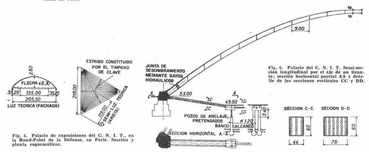
Por razones constructivas, el tramo del tirante que va desde el estribo hasta el correspondiente pozo de anclaje, aparece dividido en dos elementos paralelos, de  $60 \times 44$  cm de sección, cada uno, constituidos por veintidós cables de 41 m de longitud adecuadamente recubiertos de hormigón.
