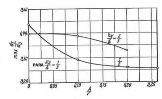
Fig. 23. Influencia de la magnitud de la reacción de apoyo  $\frac{A}{V}$ , en la máxima tensión principal en relación a  $\sigma_0 = \frac{V}{b.d}$ , o sea  $\frac{\sigma_{1mdx}}{\sigma_0}$ , para diferentes posiciones del punto de aplicación de las fuerzas de tesado y reacción del apoyo.
