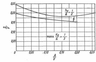
Fig. 21. Influencia de la magnitud de la reacción del apoyo  $\frac{A}{V}$ , sobre el esfuerzo cortante  $\frac{Z}{V}$ , para diferentes posiciones del punto de aplicación de las fuerzas de tesado y reacción de apoyo.
