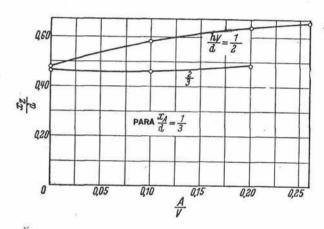
Fig. 22. Influencia de la magnitud de la reacción de apoyo  $\frac{A}{V}$ , en la distancia  $\frac{N_x}{d}$  del punto de aplicación del esfuerzo cortante, para diferentes posiciones del punto de aplicación de las fuerzas de tesado y reacción de apoyo.
