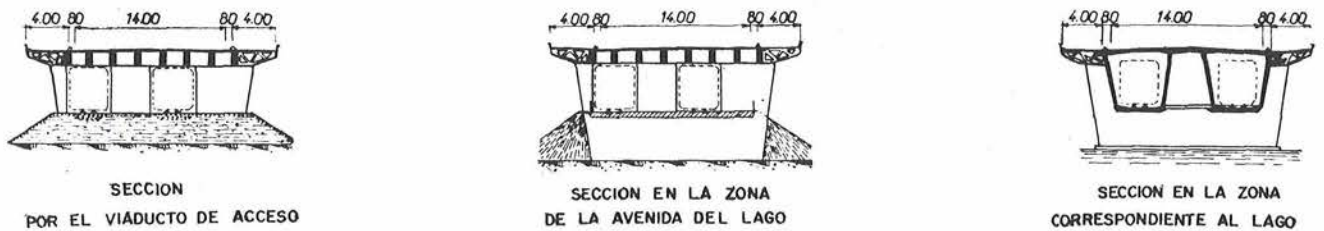
Fig. 9. Puente de Abidjan. Diversas secciones transversales del puente. En la cabeza superior de las vigas se apoya la calzada de la carretera, un andén para peatones y una pista para ciclistas. Las vías del ferrocarril pasan, por debajo, por el interior de las vigas-cajón.
