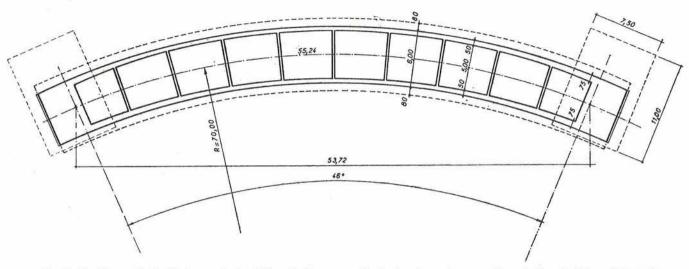
Fig. 2.—Sección en planta. Flecha en planta: 5,50 m. Tablero: en cajón de 6 m de anchura, con dos voladizos de 0,80 m. Espesor de la losa superior: 0,20 m. Riostras distanciadas unos 5,50 m. Las zapatas presentan una excentricidad de 5 m sobre los pilares y del lado de la convexidad del puente.
