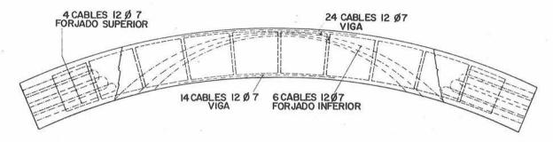
Fig. 8.-Cableado del tablero. Planta.
