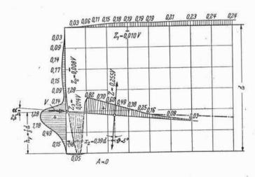
FIG. 20CON ADHERENCIA  $h_v=\frac{1}{3}d$ ,  $\chi=0$  (MODELO 6, ENSAYO 18)
