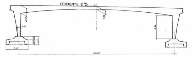
Fig. 1.—Sección longitudinal. El hueco que se ve bajo las zapatas da la vuelta completa. Transmite al suelo las torsiones aplicadas al pilar. El tablero presenta una esbeltez de 1/50. El reborde de detrás de los pilares y al nivel del tablero, sirve de apoyo a los tramos de acceso.
