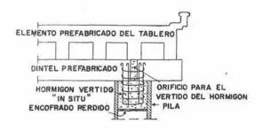
Fig. 16. Puente sobre el lago Pontchartrain. Detalle esquemático de la unión de la pila con el dintel.
