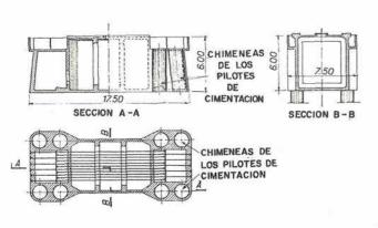
Fig. 10. Puente de Abidjan. Secciones y planta de uno de los cajones de cimentación de las pilas.
