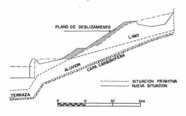
Figs. 28 y 29. Sección esquemática y una vista de la Colina de Cointe, que domina la estación de Guillemins, en Lieja. En la fotografía puede apreciarse la importancia de los daños causados por el deslizamiento de las capas del terreno.
