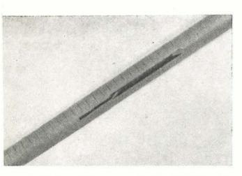
Fig. 27. Tubo  $\emptyset$  10 mm con ranura para el alojamiento del elongámetro.
