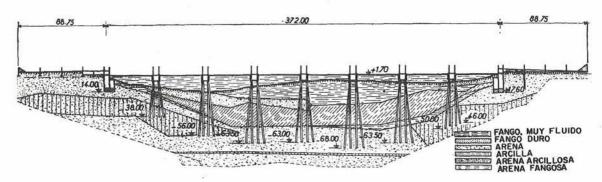
Fig. 8. Puente de Abidjan. Corte geológico en el que pueden apreciarse las desfavorables condiciones existentes para la ejecución de la cimentación.
