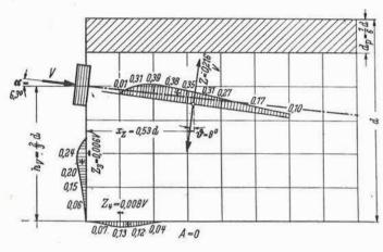
FIG.18. VIGA T,  $h_v=\frac{2}{3}d$ , A=0 (MODELO 4, ENSAYO 16)
