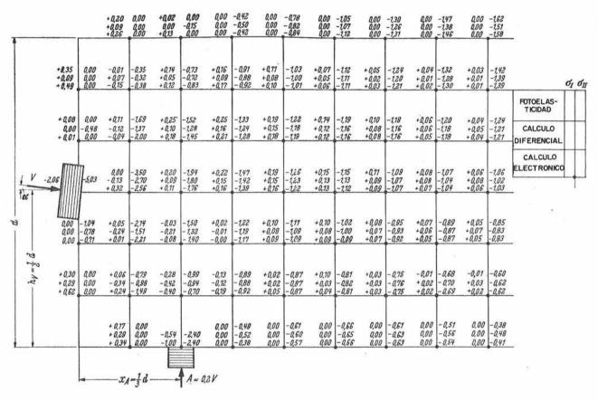
Fig. 24. Comparación en el ensayo núm. 9 de las tensiones resultantes y de las obtenidas teóricamente.
