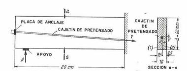
Fig. 1. Esquema explicativo de los modelos ensayados por fotoelasticidad.
