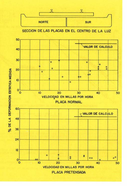
Fig. 4. Impacto total medido sobre el hormigón en el puente de Hunnewell, Missouri.
