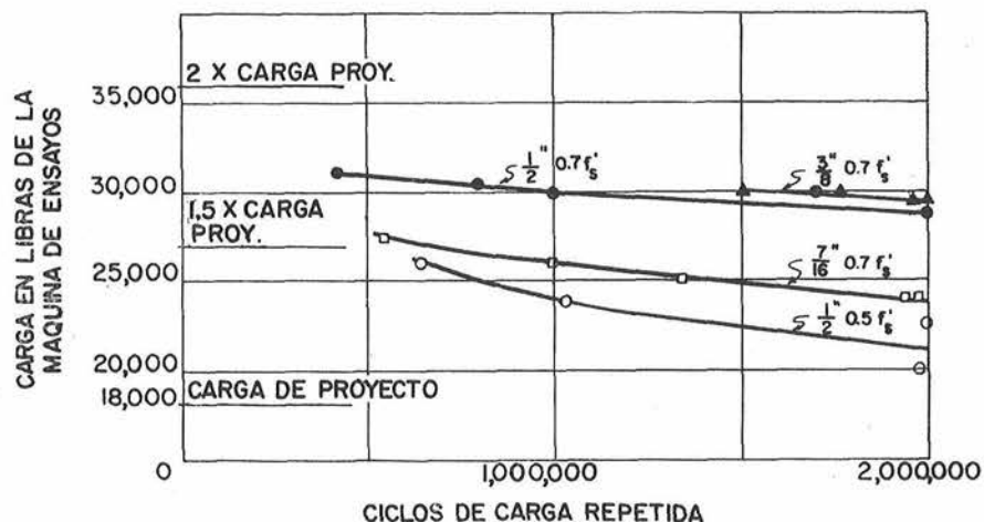
Fig. 6. Influencia del tamaño de los alambres de pretensado en la resistencia a la fatiga.
