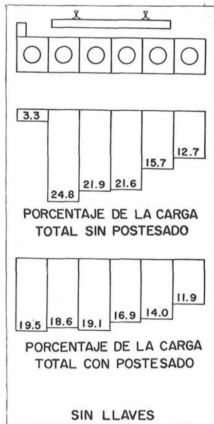
Fig. 10. Distribución trans- versal con llaves de trans- misión de cortante. Puen- te de Pompano Beach, Florida.
