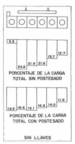
Fig. 11. Distribución transversal sin llaves de transmisión de cortante. Puente de Pompano Beach, Florida.
