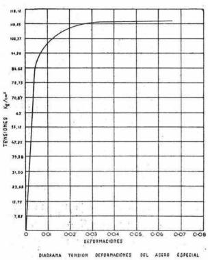
DIAGRAMA TENSION DEFORMACIONES DEL ACERO ESPECIAL Fig. 20.
