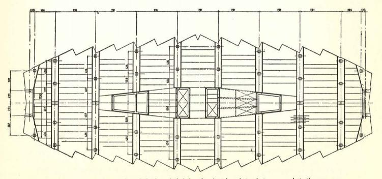
Fig. 19.—Disposición en planta de las losas de forjado y las vigas de arriostramiento en una planta tipo.
