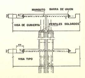
Fig. 23.—Unión entre las vigas de cubierta del edificio.
