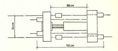
Fig. 22.—Gato de pretensado (planta).
