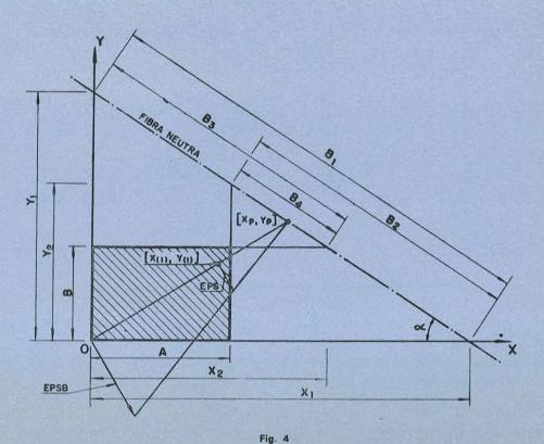
Se hallan primero las coordenadas de los puntos de intersección de la f. n. con los lados de la sección (fig. 4):
