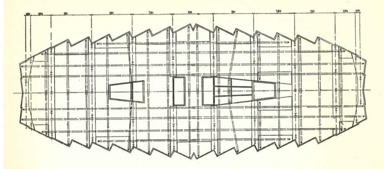
Fig. 18.—Disposición de los cables de pretensado en una planta tipo.
