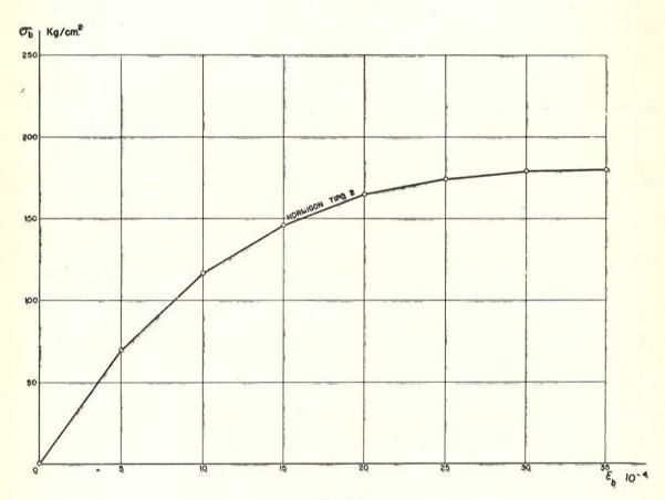
Fig. 6 Diagrama tensión-deformación del hormigón
