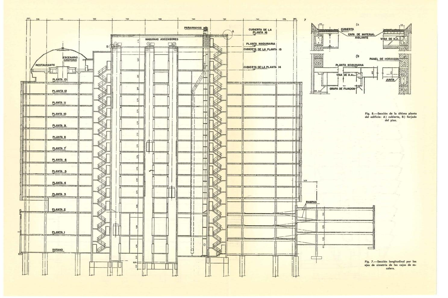
Fig. 10.—Cajas de las escaleras y ascensores que, adecuadamente ancladas al terreno, proporcionan al conjunto de la estructura prefabricada, la resistencia necesaria para soportar las acciones del viento.
