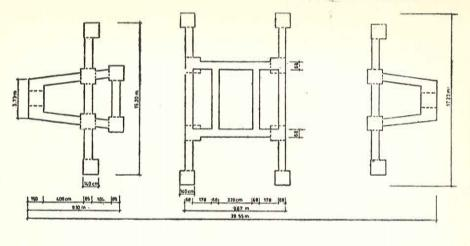
Fig. 20.—Planta de la cimentación de las cajas de escaleras y ascensores.
