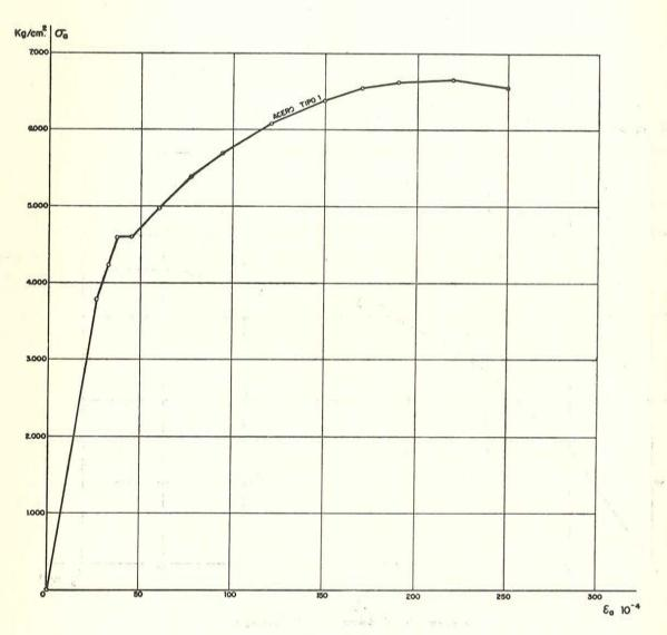
Fig. 7 Diagrama tensión-deformación del acero
